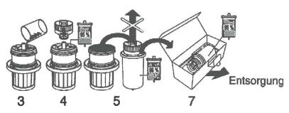
Entsorgen Sie den gefüllten Rotor unter Verwendung der Verpackung des Ersatzrotors (7). Nutzen Sie für die Entsorgung spezialiserte Firmen!
