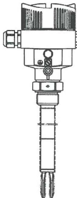
**Schema der Überfüllsicherung**
