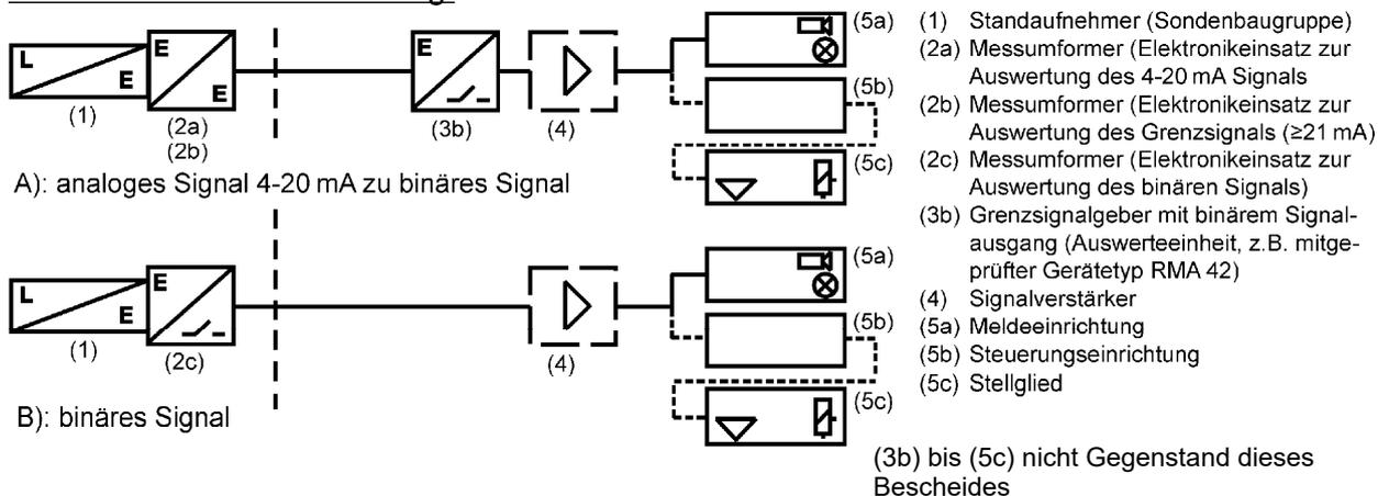
Standaufnehmer (Verdränger) "Proservo NMS8..." mit integriertem Messumformer als kontinuierliche Standmesseinrichtung von Überfüllsicherungen
