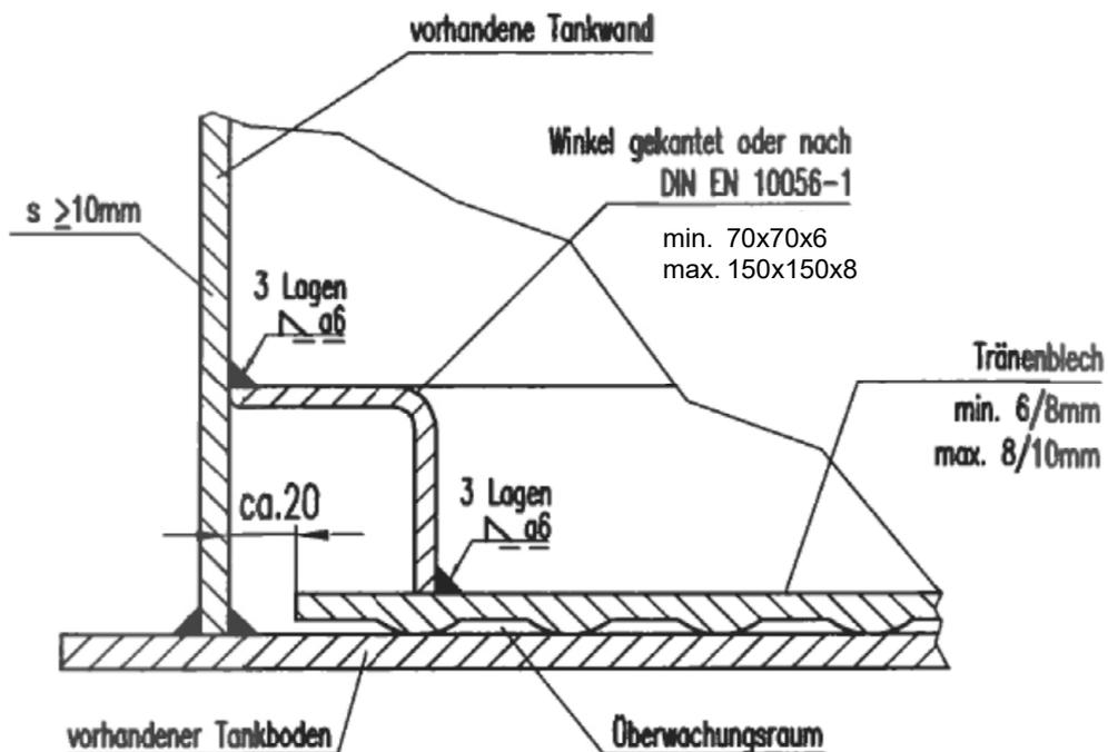
Leckschutzauskleidungen aus Stahl Typ TDB-RO 87-1 und Typ TDB-RO 93-1 für Flachbodentanks
