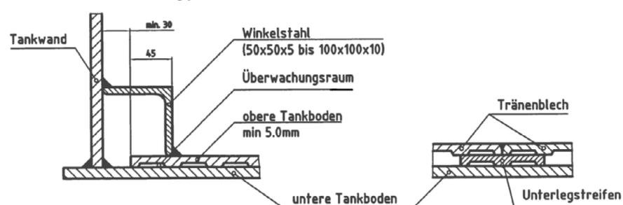
Leckschutzauskleidung aus Stahl Typ H 021 Q und Typ H 021 TR für Flachbodentanks
