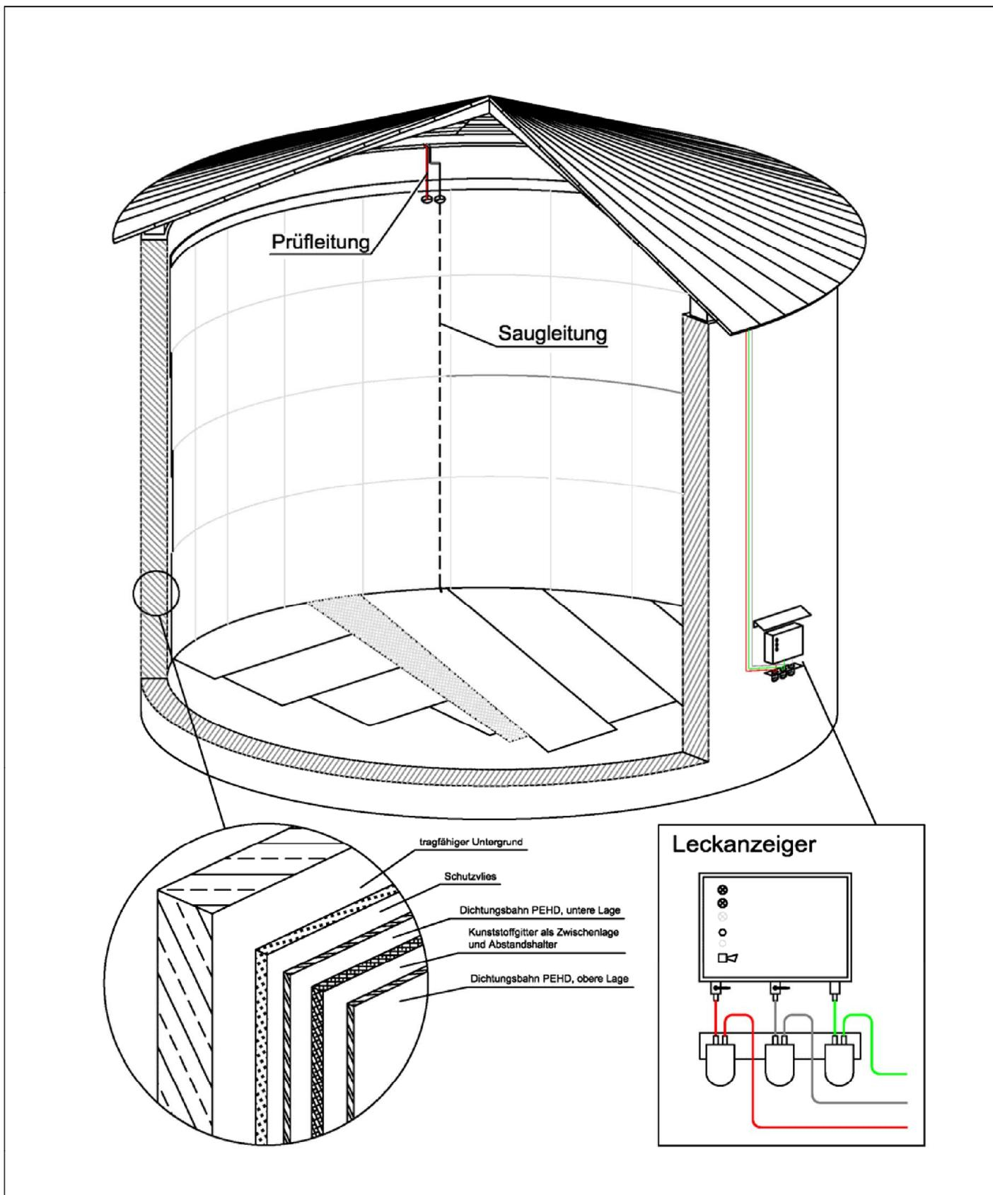
Leckschutzauskleidung Typ "RA-Protect" als Teil eines Leckanzeigegerätes für Beton- und Stahlbehälter zur Lagerung von verschiedenen Flüssigdüngern und NOx-Reduktionsmittel
