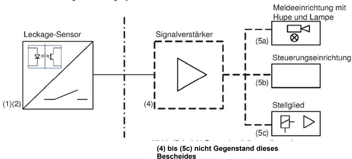
Photoelektrische Leckagesonde mit integriertem Messumformer als Bauteil von Leckageerkennungssystemen "Azbil HPQ-D"
