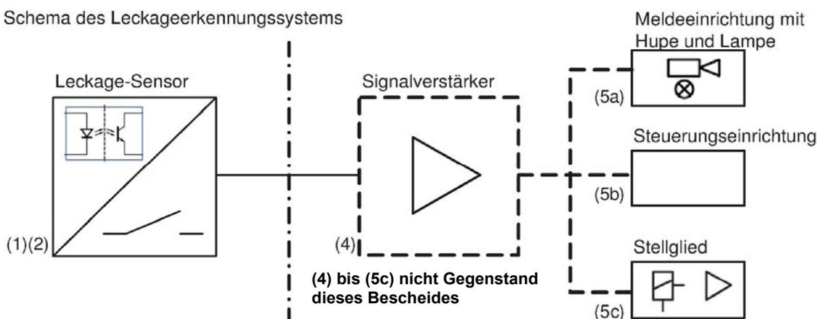
Photoelektrische Leckagesonde mit integriertem Messumformer als Bauteil von
