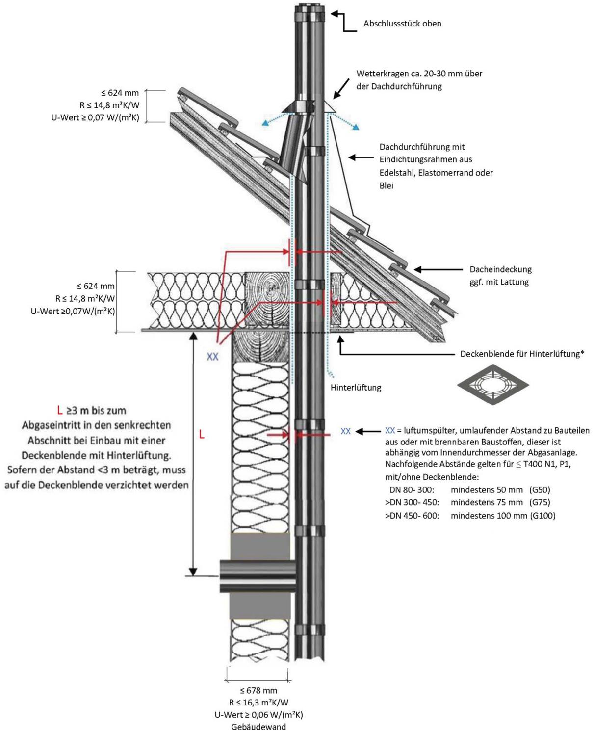
Bauarten rußbrandbeständiger Abgasanlagen vom Typ "NiroLine EW 06", "NiroLine EW 5000", "NiroLine DW" und "NiroLine DW 5000", geeignet für die trockene und feuchte Betriebsweise
