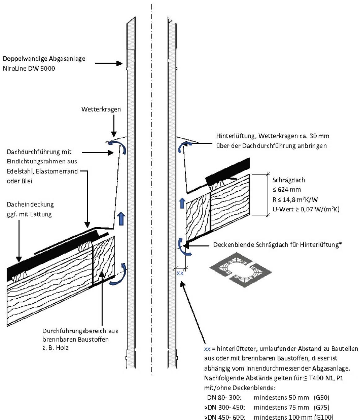
Bauarten rußbrandbeständiger Abgasanlagen vom Typ "NiroLine EW 06", "NiroLine EW 5000", "NiroLine DW" und "NiroLine DW 5000", geeignet für die trockene und feuchte Betriebsweise
