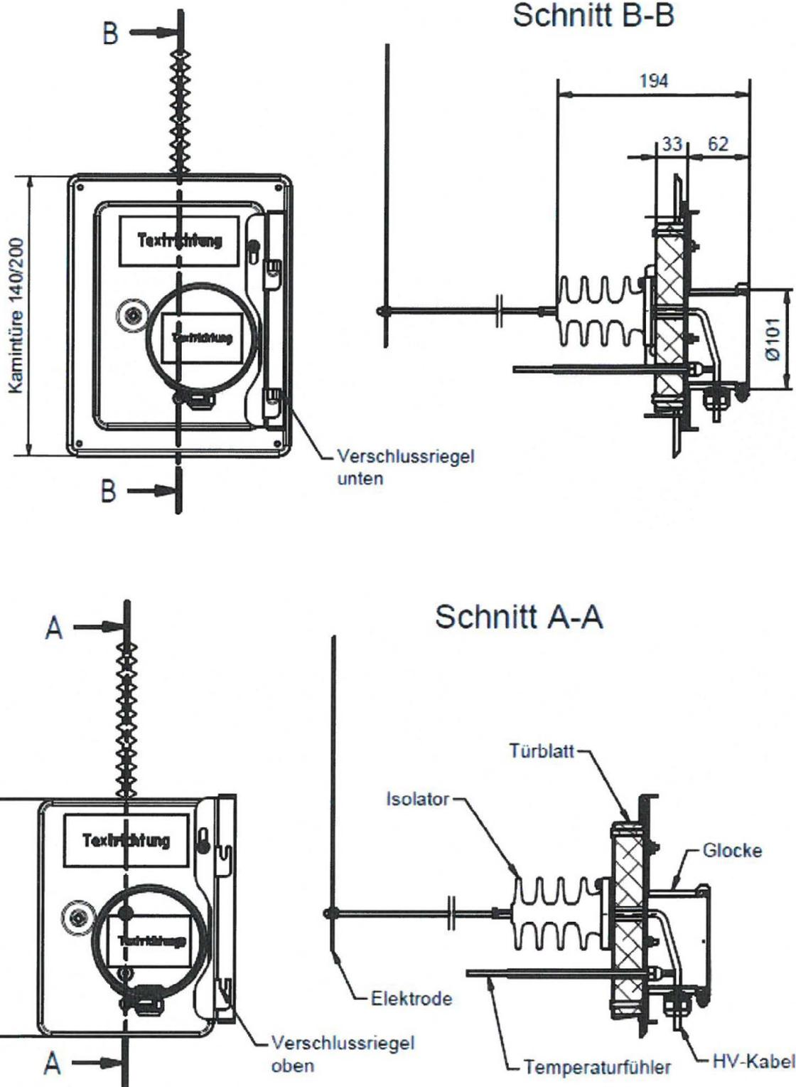
Einrichtungen zur Staubreduktion (Staubabscheider) Typ "Airjekt 1", "Airjekt 1 Basic", "Airjekt 1 Outdoor DW", "Airjekt 1 Outdoor Top" und "Airjekt 1 Ceramic" für Abgasanlagen
