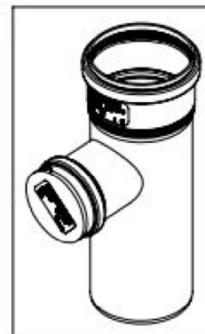
Detail A; unbelegter Anschluss: verschlossen
