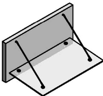
Die Zugstange wird bei den vorderen Punkthalter eingehängt und das eindrehen der Gewindestifte sichert die Bolzen gegen Herausrutschen. Durch das Drehen der Zugstange wird das Dach ausgerichtet und fein-eingestellt. Die Gewindestifte in den Zugstangenösen fixieren die Zugstange. Es ist darauf zu achten, dass die Gewindestifte die Zugstangen gegen verdrehen sichern. Ansonsten ist die Einschraubtiefe der Zugstange in die Zugstangenöse zu gering.
