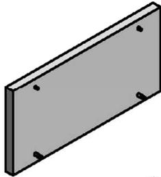
Die Befestigungspunkte der Wandhalter sind mit geeigneten Messmitteln anzuzeichnen und zu bohren. Die Wandhalter werden danach mit dem für das Mauerwerk entsprechende Befestigungssystem montiert.
