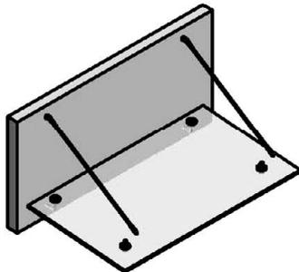
Das vormontierte Glas wird bei den unteren Wandhaltern eingehängt und durch eindrehen der Gewindestifte wird der Bolzen gesichert.
