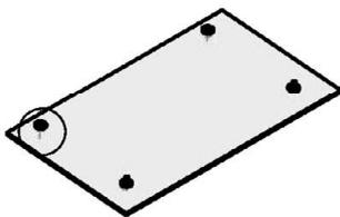
Die Punkthalter werden auf das Glas montiert. Es ist darauf zu achten, dass die Kontaktflächen zwischen dem Glas und der Punkthalter sauber sind.
