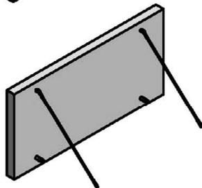
Die Zugstangen werden in die oberen Wandhalter eingehängt und die Bolzen durch die Gewindestifte gesichert.
