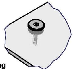
**Die Belastung der Punkthalter durch die Verglasung darf erst dann erfolgen, wenn alle Punkthalter positioniert sind und alle gleichmäßig tragen!**
