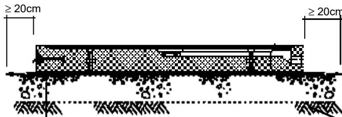
zul. Bodenpressung: zul.  $\sigma_o \geq 250 \text{ kN/m}^2$
