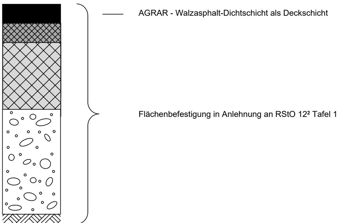
AGRAR Walzasphalt-Dichtsicht zur Verwendung für Lager- und Abfüllflächen in JGS-Anlagen und Biogasanlagen
