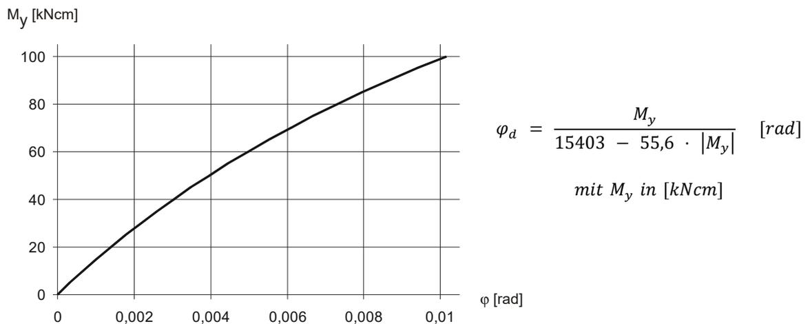
**Bild 2:** Momenten-Drehwinkel-Beziehung
