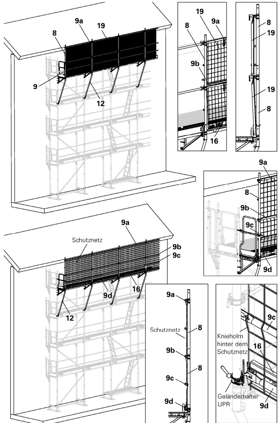
Belagebene) einhängen. Geländerholm (9b) und Knieholm (9c) einbauen, wobei darauf zu achten ist, dass das Netz vom Gerüst aus gesehen vor dem Geländerholm (9b) und hinter dem Knieholm
