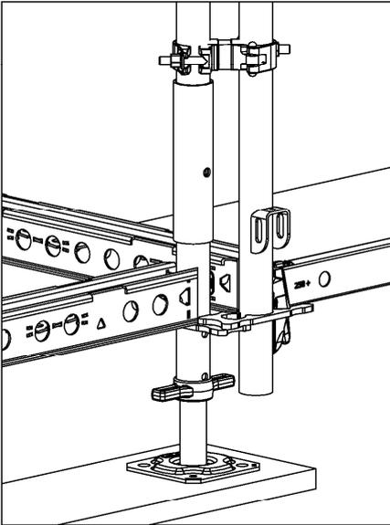
Dazu werden die Rohre des Basisrahmens UVF (2a) und der T-Rahmen UVT (4) mit den Rohren UV 165 (6) in der Basislage mit zwei Drehkupplungen und dann in jeder 2. Gerüstebene mit einer Drehkupplung verbunden. (Regelmäßige Abstände von  $\Delta h = 4,00 \text{ m}$ )
