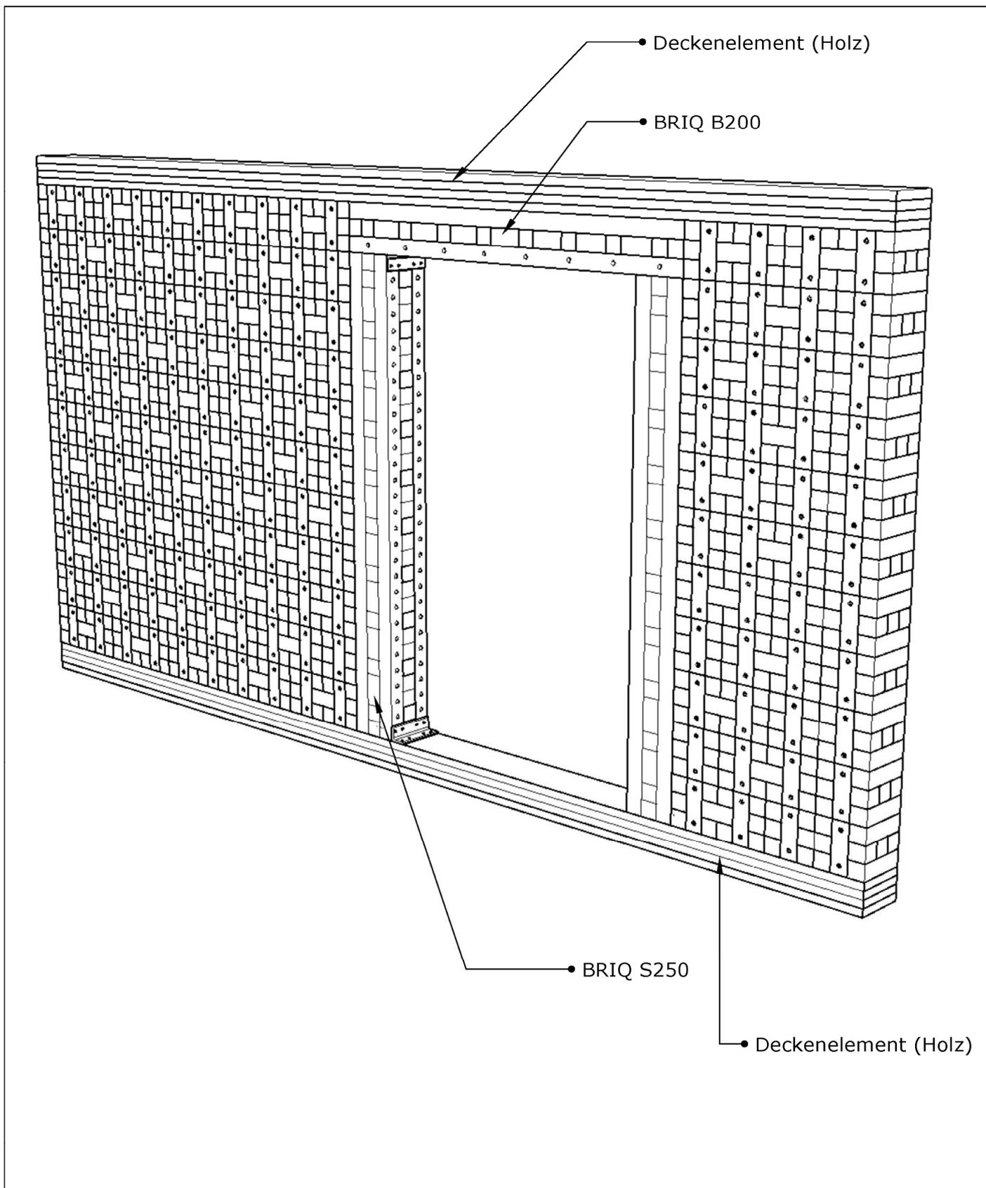
TRIQBRIQ WS25 Massivholzbausystem - Wandelemente unter Verwendung der
