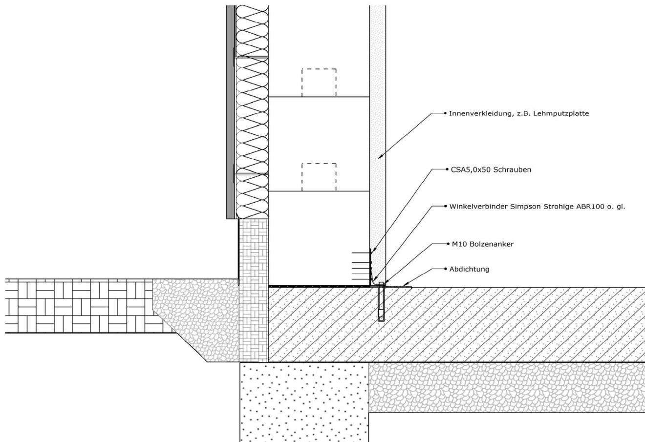
TRIQBRIQ WS25 Massivholzbausystem - Wandelemente unter Verwendung der
