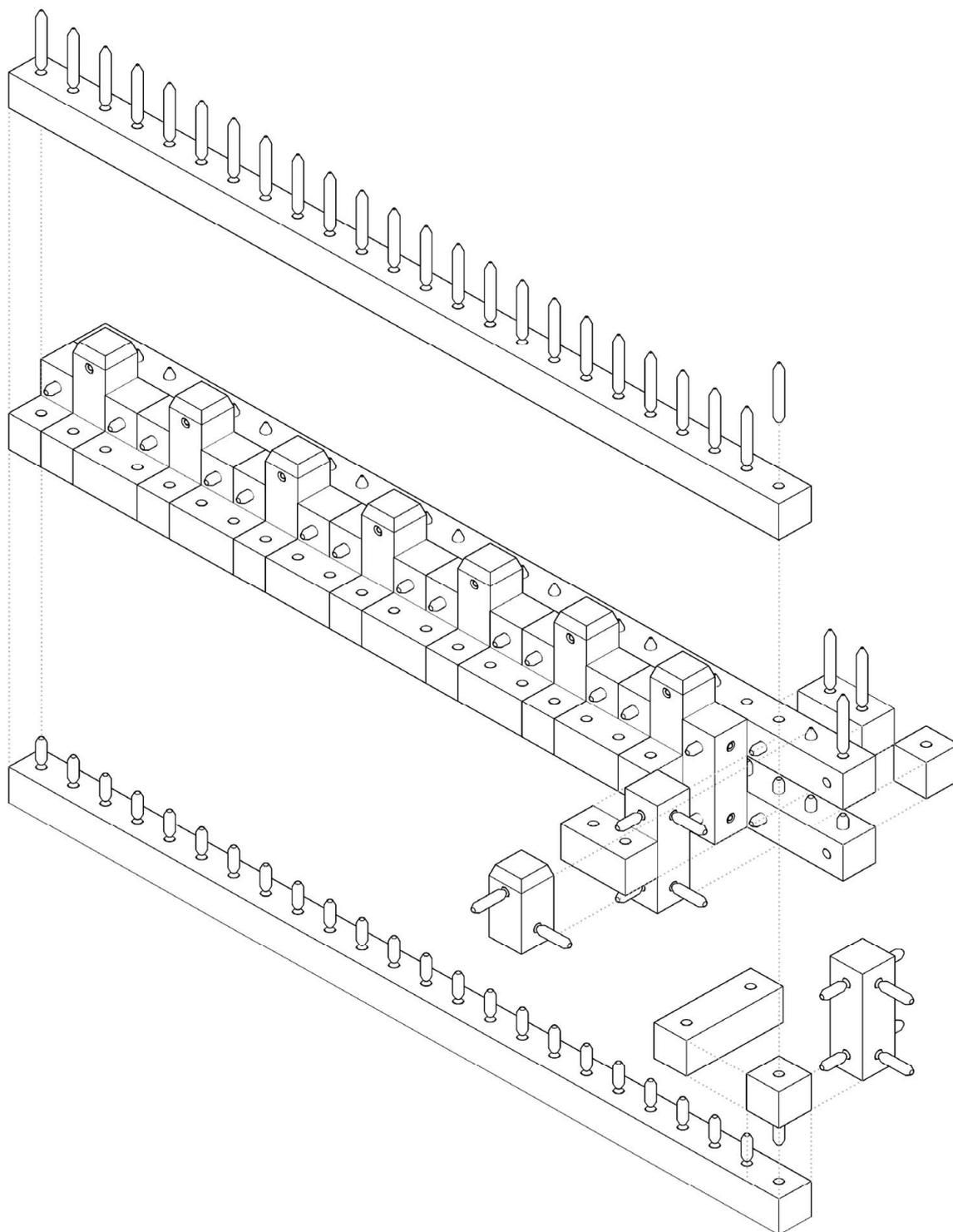
TRIQBRIQ WS25 Massivholzbausystem - Wandelemente unter Verwendung der
