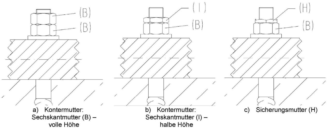
**Abbildung 5: Maßnahmen um das Lösen der Mutter unter Ermüdungs- oder seismischer Belastung zu verhindern**
