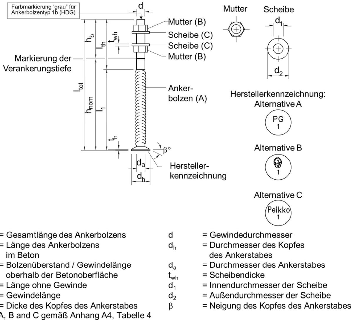
Abbildung 3: Abmessungen der HPM® L Ankerbolzen
