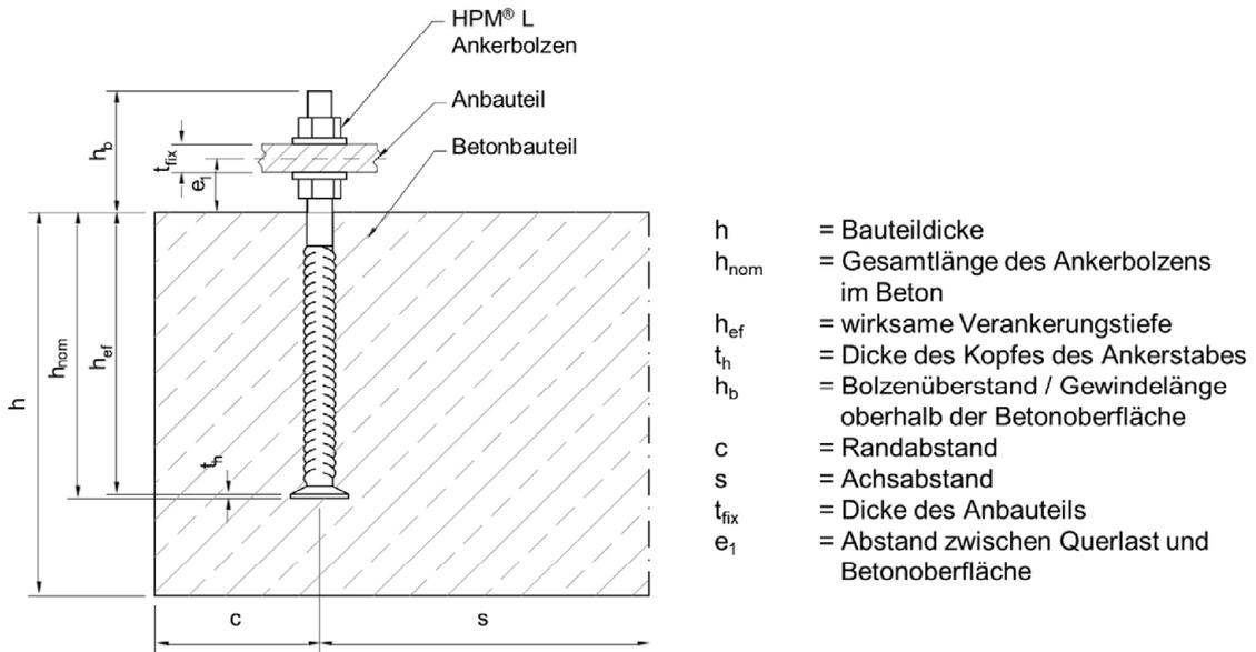
Abbildung 2: Stahl-Stahl-Kontakt (Abstandsmontage)
