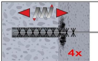
2b. Bohrloch mindestens 4x mit Bürste MIT-BS gemäß Tabelle B4 drehend über die gesamte Verankerungstiefe (ggf. Bürstenverlängerung MIT-BS verwenden) ausbürsten.
