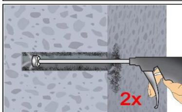
2f. Abschließend Bohrloch mindestens 2x mit Druckluft (min. 6 bar, ölfrei) (Anhang B 6) über die gesamte Verankerungstiefe (ggf. Verlängerung verwenden) ausblasen, bis die ausströmende Luft staubfrei ist.
