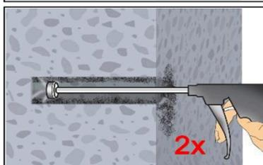
2c. Abschließend Bohrloch mindestens 2x mit Druckluft (min. 6 bar, ölfrei) (Anhang B 6) über die gesamte Verankerungstiefe (ggf. Verlängerung verwenden) ausblasen, bis die ausströmende Luft staubfrei ist.
