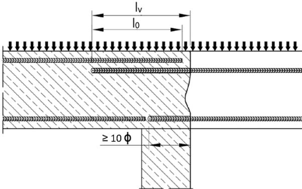
**Bild A2:** Übergreifungsstoß einer Stütze oder Wand an ein Fundament; Bewehrungsstäbe auf Zug beansprucht
