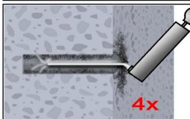
2c. Abschließend Bohrloch vom Bohrlochgrund her mindestens 4x mit einer Handpumpe (Anhang B 6) ausblasen.
