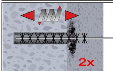
2b. Bohrloch mindestens 2x mit Bürste MIT-BS gemäß Tabelle B4 drehend über die gesamte Verankerungstiefe (ggf. Bürstenverlängerung MIT-BS verwenden) ausbürsten.
