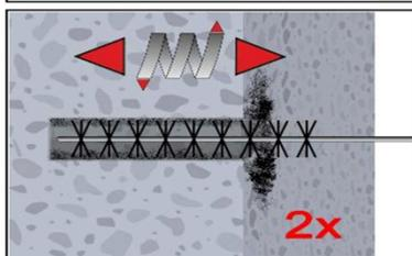
2e. Bohrloch mindestens 2x mit Bürste MIT-BS gemäß Tabelle B4 drehend über die gesamte Verankerungstiefe (ggf. Bürstenverlängerung MIT-BS verwenden) ausbürsten.
