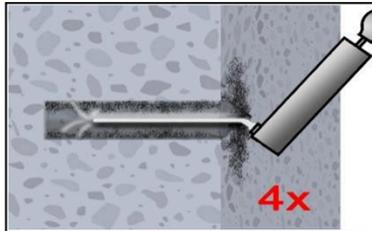
**Achtung! Vor der Reinigung im Bohrloch stehendes Wasser entfernen.**
