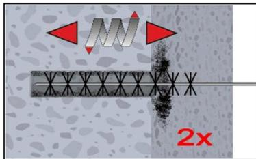
2b. Bohrloch mindestens 2x mit Bürste MIT-BS gemäß Tabelle B4 drehend über die gesamte Verankerungstiefe (ggf. MIT-BS verwenden) ausbürsten.
