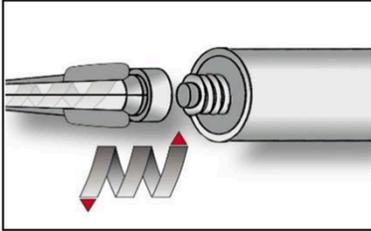
3. Statikmischer MIT-MI 4 aufschrauben und Kartusche in geeignetes Auspressgerät einlegen.
