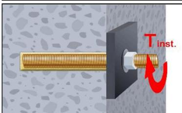
**12.** Anbauteil mit kalibriertem Drehmomentschlüssel montieren. Maximales Montagedrehmoment (Tabelle B1 oder B3) beachten. Bei statischer Vorgabe (z.B. Erdbeben), Ringspalt im Anbauteil mit Mörtel (Anlage A 2) verfüllen. Dazu Unterlegscheibe durch Verfüllscheibe VFS ersetzen und Mischerrreduzierung MR verwenden.
