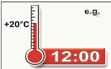
**11.** Temperaturabhängige Aushärtezeit  $t_{cure}$  (Anhang B 5) muss eingehalten werden. Anker während der Aushärtezeit nicht bewegen oder belasten.
