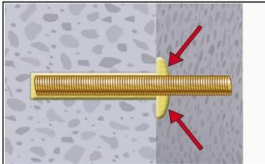
**9.** Ringspalt zwischen Ankerstange und Verankerungsgrund muss vollständig mit Mörtel gefüllt sein. Bei Durchsteckmontage muss auch der Ringspalt im Anbauteil mit Mörtel verfüllt sein. Andernfalls Anwendung vor Erreichen der maximalen Verarbeitungszeit  $t_{work}$  ab Schritt 7 wiederholen.
