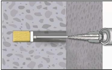
**7b. Injizieren mit Verfüllstutzen VS:**
