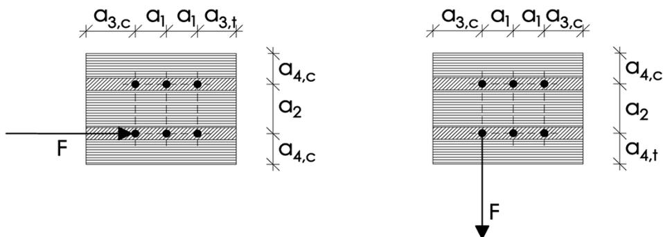
Abbildung A.2.2 Definition der Mindestabstände in den Schmalflächen des Brettspertholzes. Bei Schrauben in den Schmalflächen sind die Abstände  $a_1$  und  $a_3$  parallel zur Seitenfläche sowie die Abstände  $a_2$  und  $a_4$  rechtwinklig zur Seitenfläche des Brettspertholzes.
