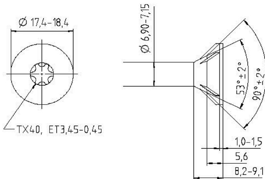
FISHBULL Holzbauschrauben mit Senkkopf und Holzbauschrauben mit Tellerkopf
