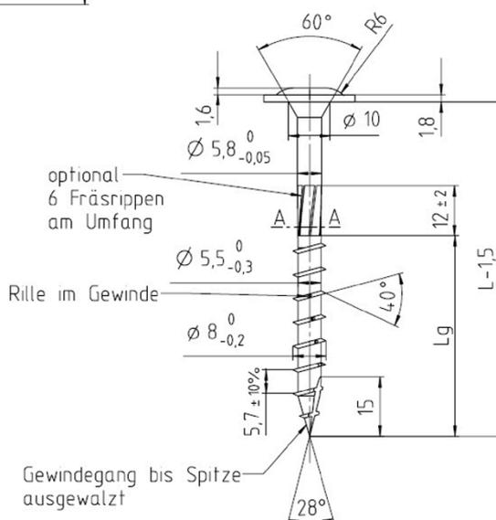
FISHBULL Holzbauschrauben mit Senkkopf und Holzbauschrauben mit Tellerkopf
