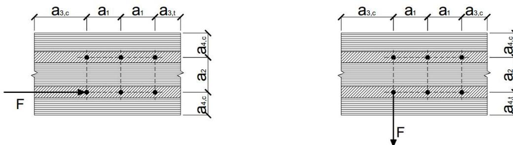
Abbildung A.2.2 Definition der Mindestabstände in den Schmalflächen des Brettspertholzes. Bei Schrauben in den Schmalflächen sind die Abstände  $a_1$  und  $a_3$  parallel zur Seitenfläche sowie die Abstände  $a_2$  und  $a_4$  rechtwinklig zur Seitenfläche des Brettspertholzes
