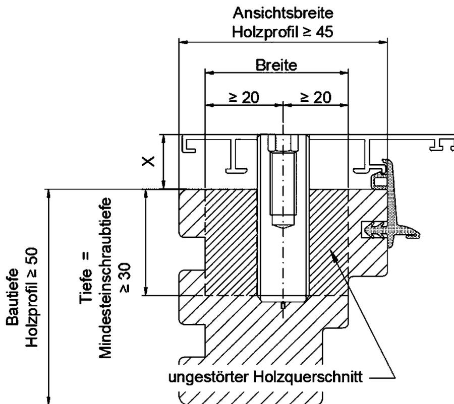
Für die Verwendung des Fix Max® Gewinde Anker - BS100 in Holz-Alu-Rahmenprofilen muss der Abstand zwischen Achse BS100 und Außenkante ungestörter Holzquerschnitt - wie in der Zeichnung gezeigt - mindestens 20 mm betragen. Der BS100 muss mindestens mit der Außenseite der Aluminiumdeckschale abschließen (Mindestlänge des BS100 = Mindesteinschraubtiefe + „X“. Das Rahmenprofil kann aus lamelliertem Holz min. 3 Lagen nach DIN EN 14220 oder Furnierschichtholz nach DIN EN 14279 ausgeführt werden.
