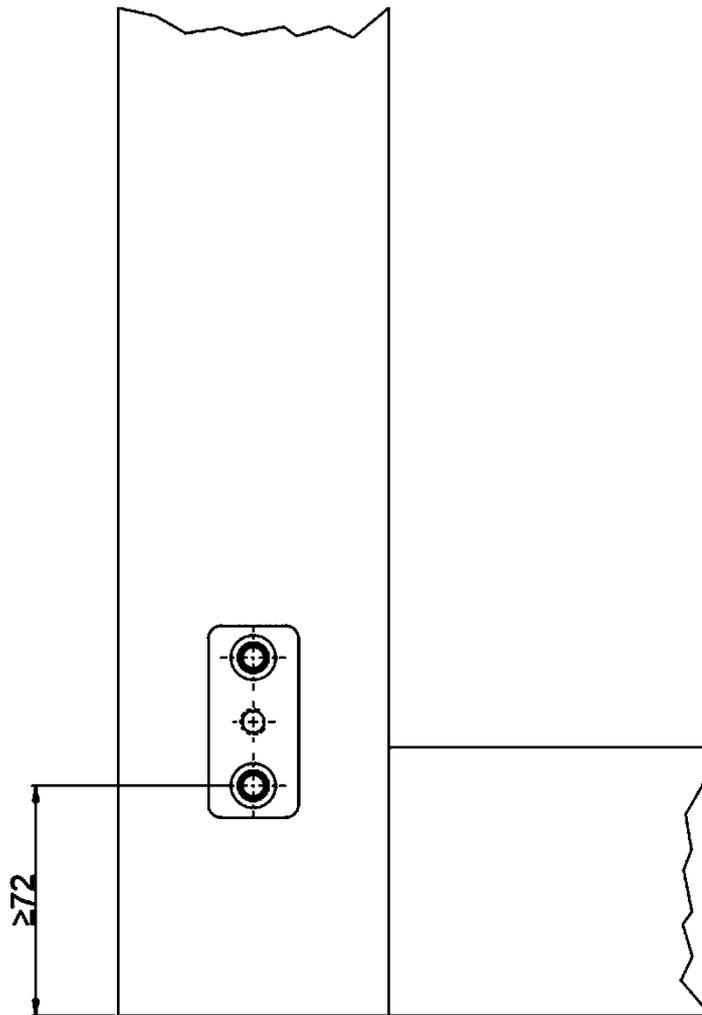
Für die Verwendung der Fix Max® Holz-Alu-Befestigung – BS401 in Holz-Rahmenprofilen muss der Mindestabstand der untersten Schraube zur Unterkante des Fensterprofils von 72 mm eingehalten werden.
