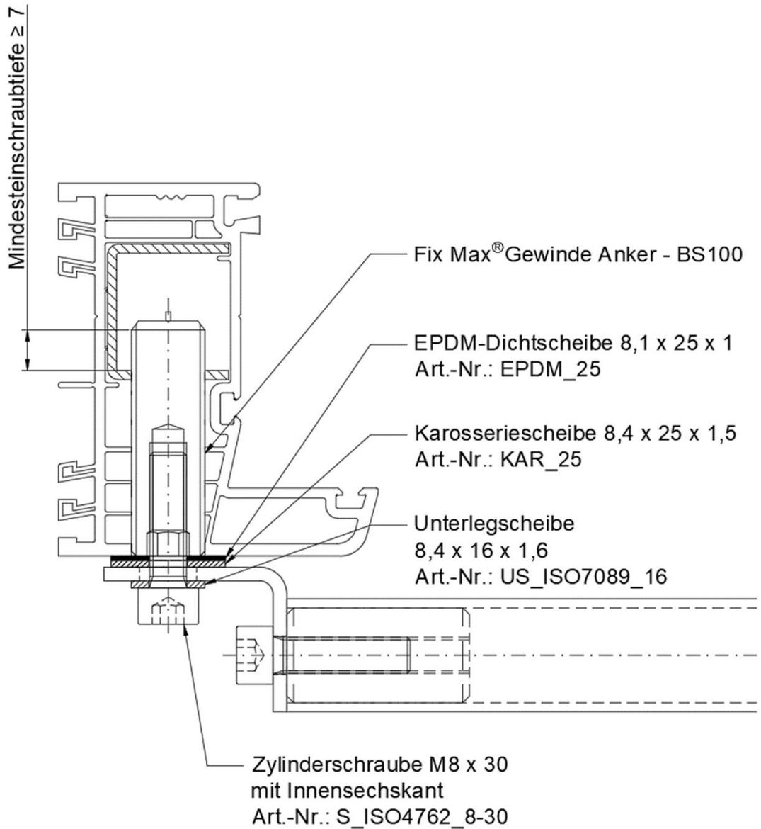
Befestigungssysteme zur lastabtragenden und absturzsichernden Befestigung von Anbauteilen an Fensterrahmenprofilen
