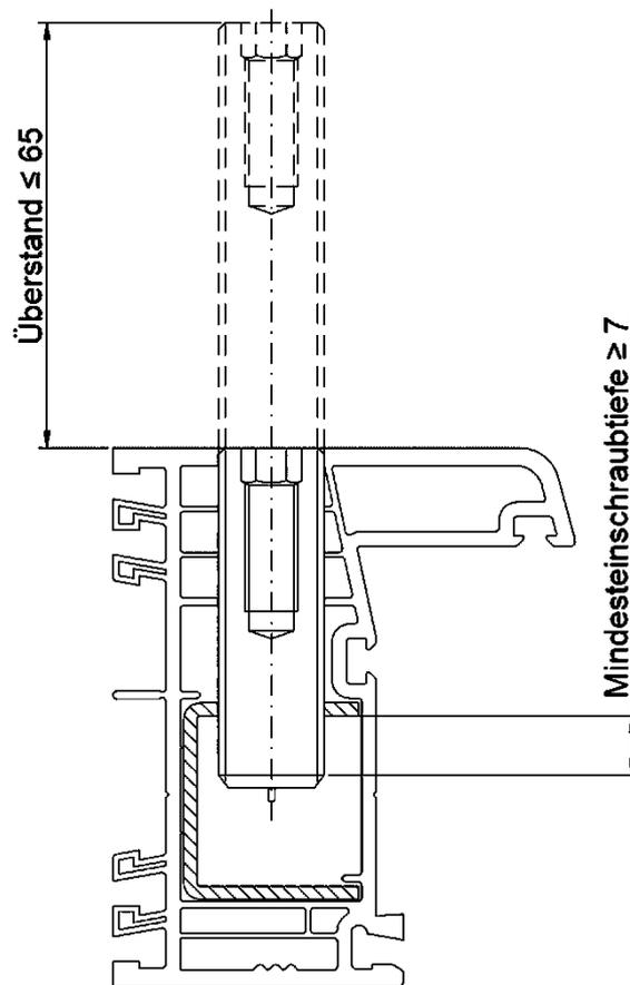
Für die Verwendung des Fix Max® Gewinde Anker - BS100 in PVC-Rahmenprofilen darf die Mindesteinschraubtiefe von 7 mm in der Stahllarmierung nicht unterschritten werden. Der Überstand von bis zu 65 mm ist nur in Verbindung mit 4 Befestigungspunkten möglich.
