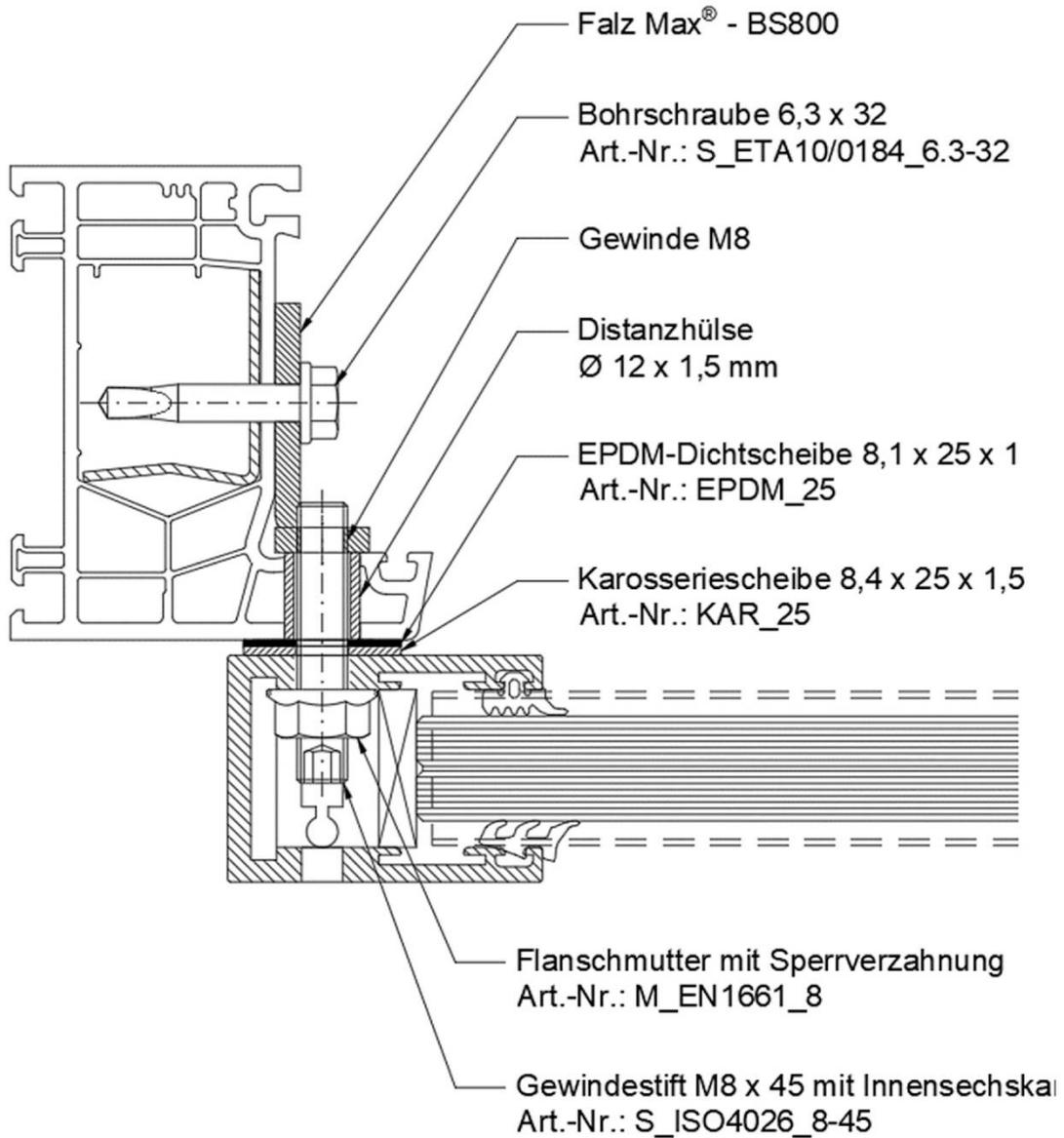
Befestigungssysteme zur lastabtragenden und absturzsichernden Befestigung von Anbauteilen an Fensterrahmenprofilen
