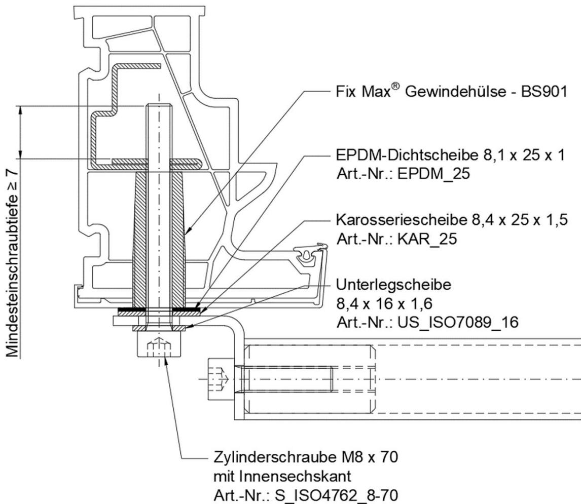
Befestigungssysteme zur lastabtragenden und absturzsichernden Befestigung von Anbauteilen an Fensterrahmenprofilen
