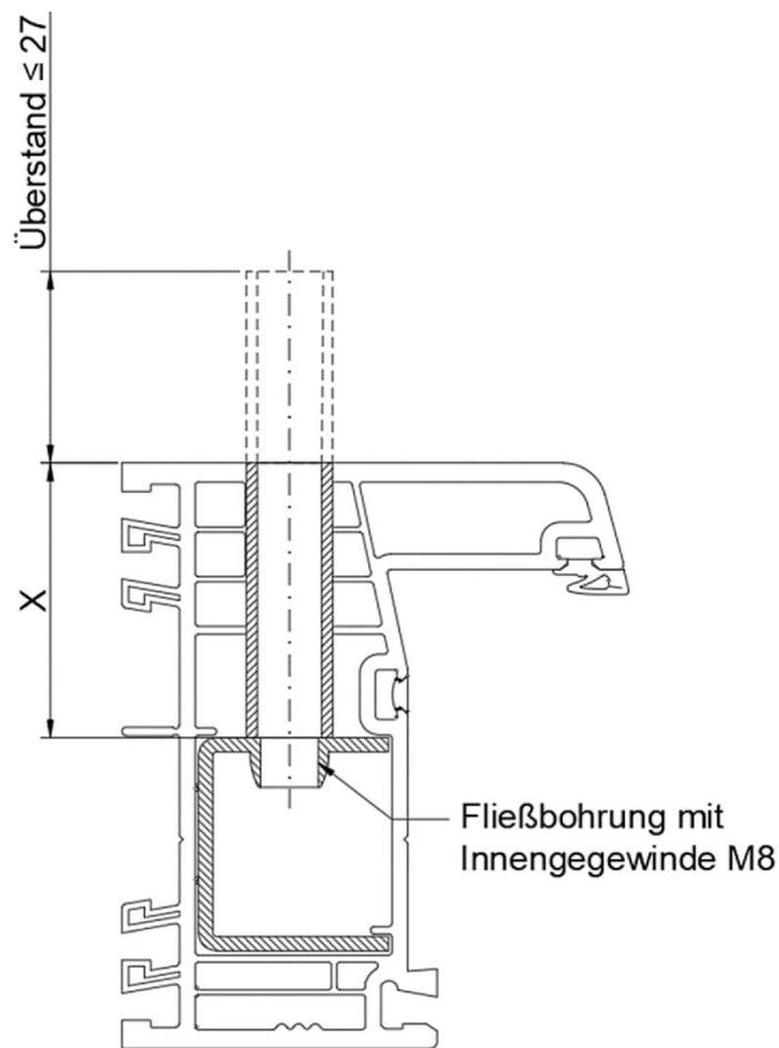
Für die Verwendung des Fix Max® Fließsystem – BS900 in einem PVC- muss die außenliegende Stahlarmierungs-wandung geschlossen- und mindestens 1,5 mm stark sein. Bei 2 Befestigungspunkten ist ein Überstand von bis zu 23 mm möglich. Die auftretenden Lasten müssen geregelt über eine Distanzhülse, welche zwischen Umwehrung und Stahlarmierung eingesetzt wird (siehe Maß „X“), abgeleitet werden.
