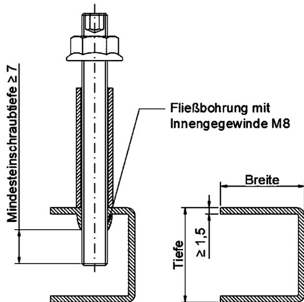
Für die Verwendung des Fix Max® Fließsystem – BS900 in einem PVC- muss die außenliegende Stahlarmierungs-wandung geschlossen- und mindestens 1,5 mm stark sein. Die Stahlarmierung muss eine Zugfestigkeit von mindestens  $R_m \geq 270 \text{ N/mm}^2$  aufweisen. Als Form sind □-, L- oder U- Armierungen aus Stahl DX51D+Z oder gleichwertig, mit  $R_m \geq 270 \text{ N/mm}^2$  möglich.
