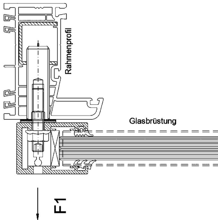
*Beanspruchungsrichtung F1, Zugkraft rechtwinklig zur Fensterebene, die über entsprechende Anbauteile in den Fensterrahmen eingeleitet werden. Hier beispielhaft als Glasbrüstung dargestellt.*
