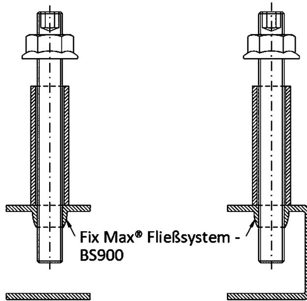
**Befestigungssysteme zur lastabtragenden und absturzsichernden Befestigung von Anbauteilen an Fensterrahmenprofilen**
