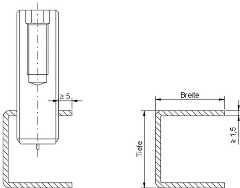
Für die Verwendung des Fix Max® Gewinde Anker - BS100 in PVC-Rahmenprofilen muss die außenliegende Stahlarmierungswandung geschlossen- und mindestens 1,5 mm stark sein. Der Mindestabstand zur geöffneten Stahlarmierungskante beträgt 5 mm. Zudem muss die Stahlarmierung eine Zugfestigkeit von mindestens  $R_m \geq 270 \text{ N/mm}^2$  aufweisen. Als Form sind  $\square$ - L- oder U- Armierungen aus Stahl DX51D+Z oder gleichwertig, mit  $R_m \geq 270 \text{ N/mm}^2$  möglich.
