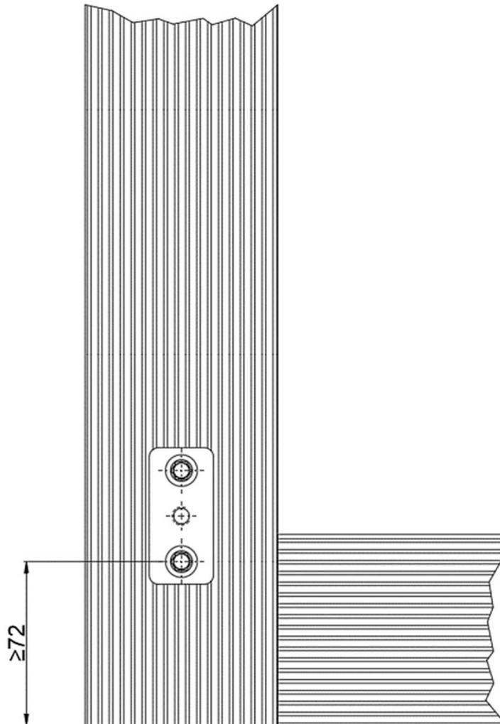
Für die Verwendung der Fix Max<sup>®</sup> Holzbefestigung – BS400 in Holz-Rahmenprofilen muss der Mindestabstand der untersten Schraube zur Unterkante des Fensterprofils von 72 mm eingehalten werden.
