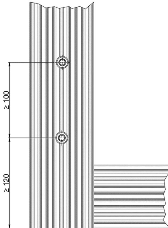
Für die Verwendung des Fix Max® Gewinde Anker - BS100 in Holz-Rahmenprofilen müssen die Mindestabstände zur Unterkante des Fensterprofils von 120 mm und zwischen den Befestigungssystemen von 100 mm eingehalten werden.
