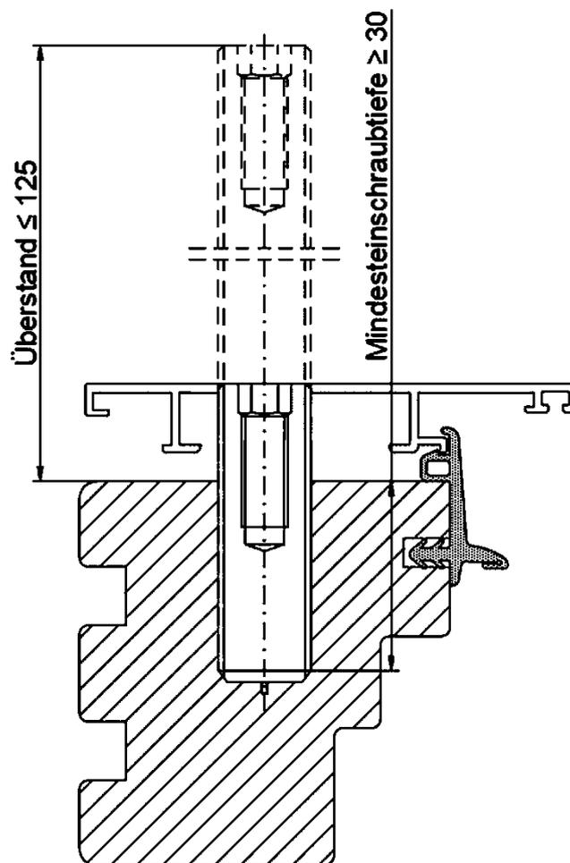
Für die Verwendung des Fix Max® Gewinde Anker - BS100 in Holz-Alu-Rahmenprofilen muss der BS100 mindestens 30 mm im tragenden Profil (Holz) eingedreht werden. Der Überstand von bis zu 125 mm ist nur in Verbindung mit 4 Befestigungspunkten möglich. Bei 2 Befestigungspunkten ist ein Überstand von bis zu 65 mm möglich.
