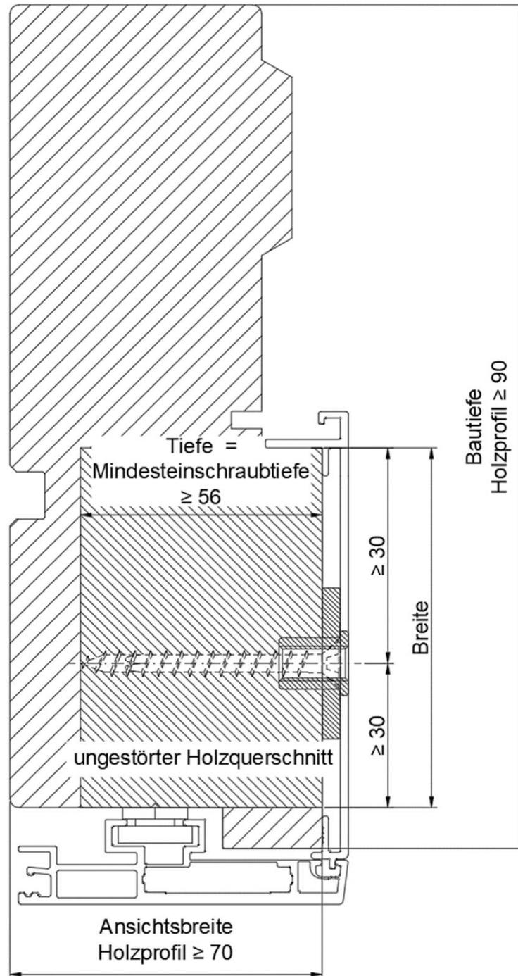
Für die Verwendung des Fix Max<sup>®</sup> – BS HSH in Holz-Alu-Rahmenprofilen muss der Abstand zwischen Achse BS HSH und Außenkante ungestörter Holzquerschnitt - wie in der Zeichnung gezeigt - mindestens 15 mm betragen. Das Rahmenprofil kann aus lamelliertem Holz min. 3 Lagen nach DIN EN 14220 oder Furnierschichtholz nach DIN EN 14279 ausgeführt werden.
