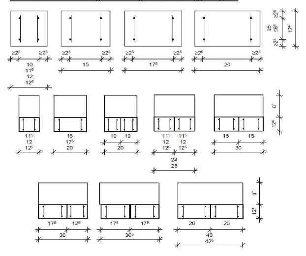
Ytong Porenbeton Flachstürze der Typenreihe Y-I und Y-II
