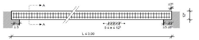
Betonstahl B500A (G): Längsbewehrung: 4 Stäbe 4,5 [mm]  $\leq$  d<sub>sl</sub>  $\leq$  6,0 [mm] bei L  $\leq$  2,00 [m] 4 Stäbe 6,0 [mm]  $\leq$  d<sub>sl</sub>  $\leq$  6,5 [mm] bei 2,00 [m] < L  $\leq$  3,00 [m]
