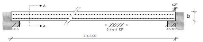
Betonstahl B500A (G): Längsbewehrung: 4 Stäbe 4,5 [mm]  $\leq$  d<sub>sl</sub>  $\leq$  6,0 [mm] bei L  $\leq$  2,00 [m] 4 Stäbe 6,0 [mm]  $\leq$  d<sub>sl</sub>  $\leq$  6,5 [mm] bei 2,00 [m] < L  $\leq$  3,00 [m]
