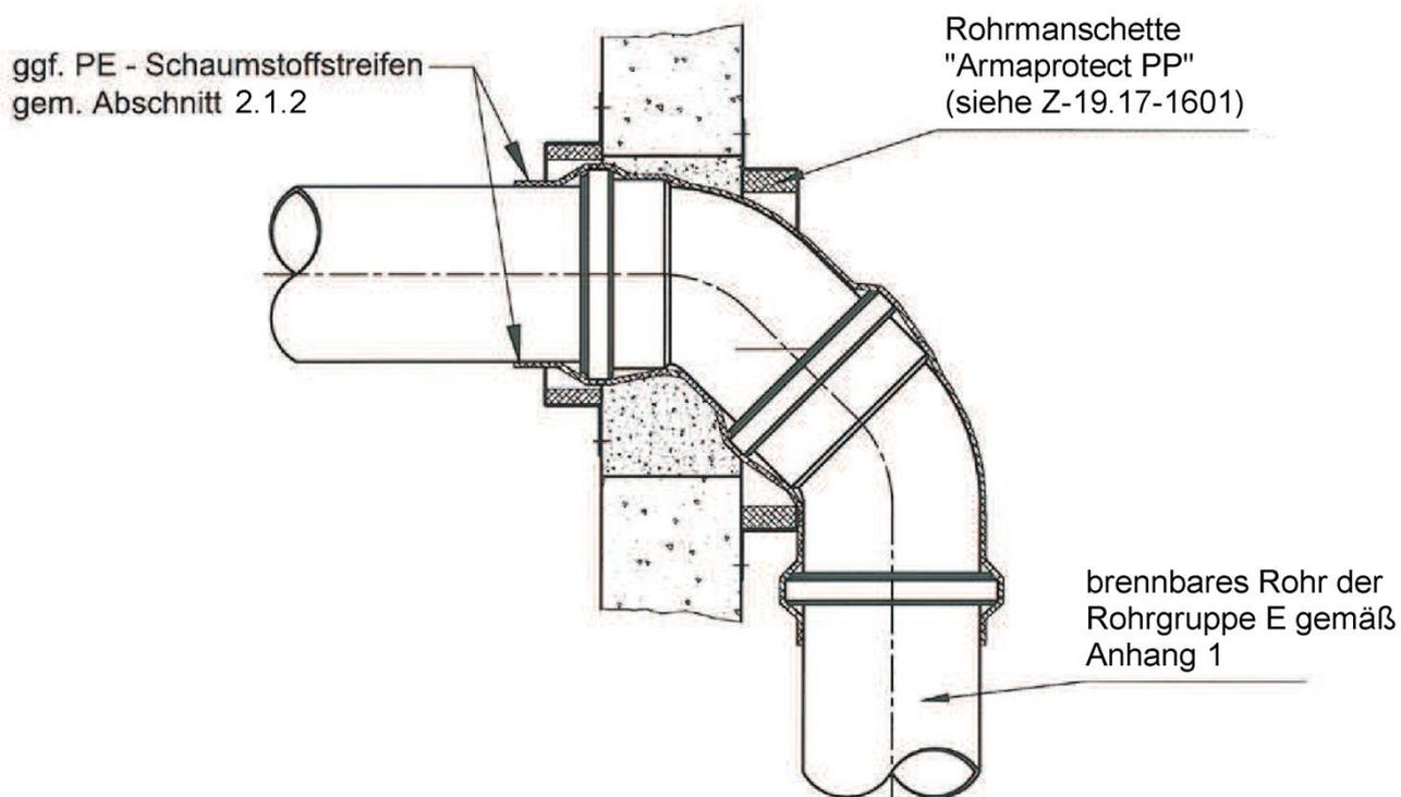
Feuerwiderstandsfähige Abschottung für Rohrleitungen aus Kunststoff "Armaprotect, Typ Armaprotect PP"
