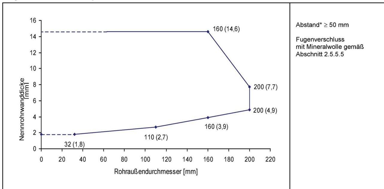
**Rohre gemäß Rohrgruppe B-3:** (Rohre mit FEF-Isolierung, senkrecht zur Bauteiloberfläche durchgeführte Rohre, aufgesetzte Manschetten)
