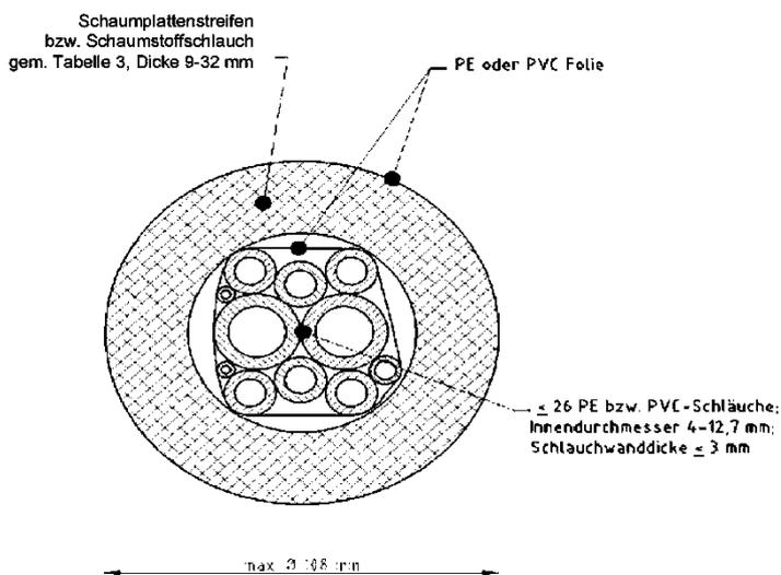
Feuerwiderstandsfähige Abschottung für Rohrleitungen aus Kunststoff "Armprotect, Typ Armprotect PP"
