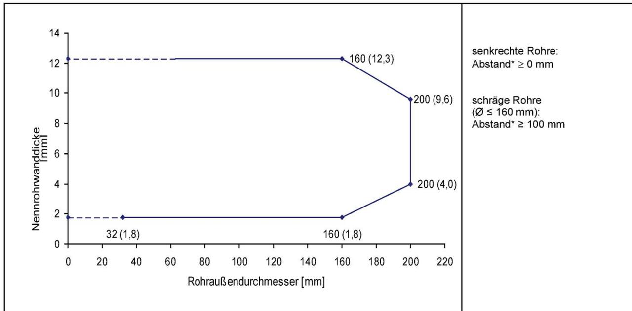
**Rohre gemäß Rohrgruppe A-2:** (im Bereich von Muffen, senkrecht zur Bauteiloberfläche durchgeführte Rohre, keine Isolierung, aufgesetzte Manschetten)
