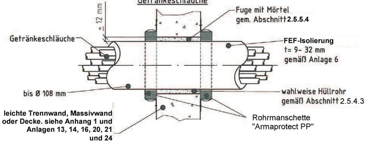
Feuerwiderstandsfähige Abschottung für Rohrleitungen aus Kunststoff "Armprotect, Typ Armprotect PP"
