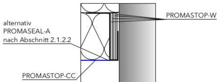
Feuerwiderstandsfähige Abschottung für elektrische Leitungen und/oder Rohrleitungen aus Kunststoff oder Metall "PROMASTOP-Kombischott, Typ CC"
