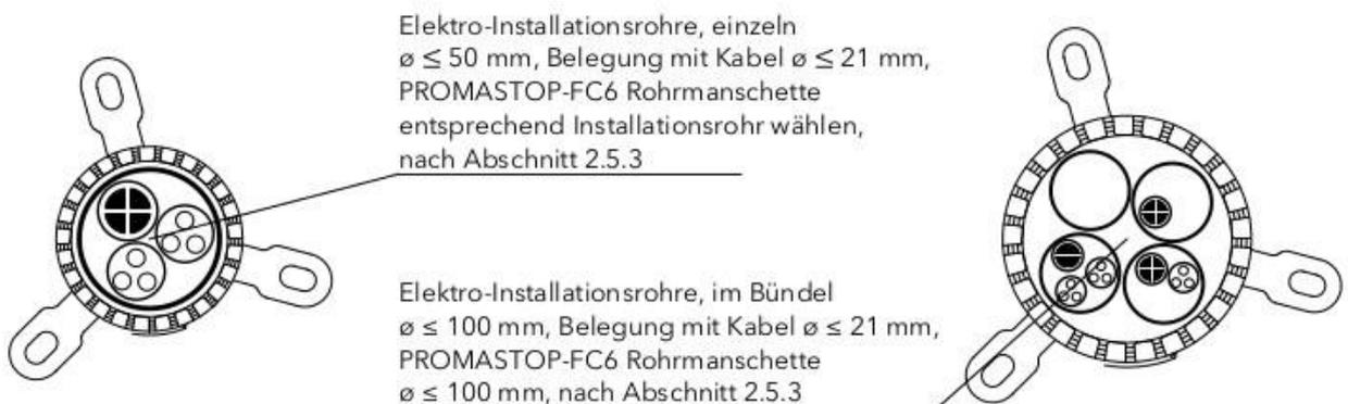
Feuerwiderstandsfähige Abschottung für elektrische Leitungen und/oder Rohrleitungen aus Kunststoff oder Metall "PROMASTOP-Kombischott, Typ CC"
