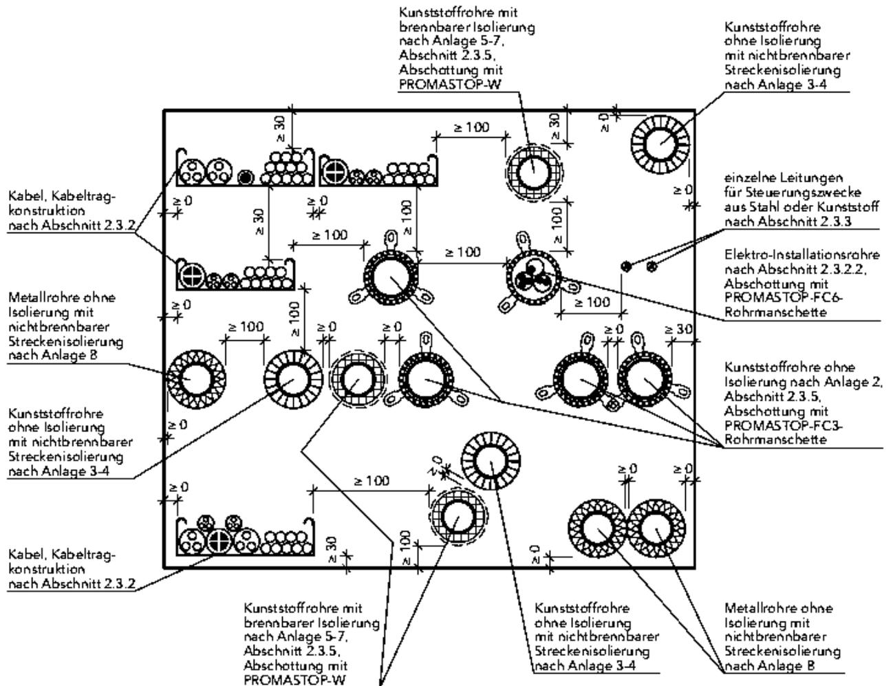
Feuerwiderstandsfähige Abschottung für elektrische Leitungen und/oder Rohrleitungen aus Kunststoff oder Metall "PROMASTOP-Kombischott, Typ CC"
