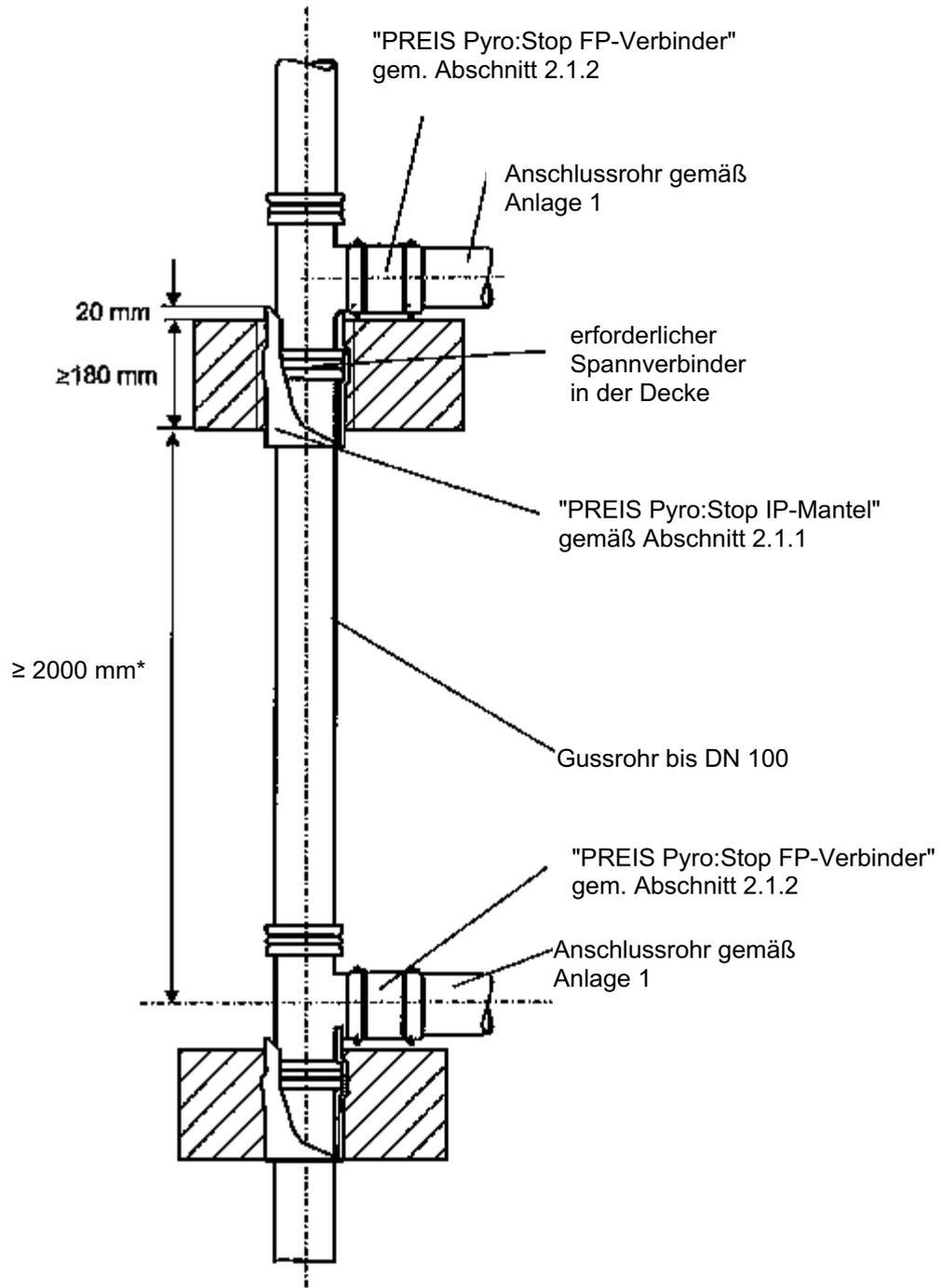
\* bei geringerem Abstand: Einbau gemäß Anlage 3 (mit 9 mm dicker Streckenisolierung oberhalb der durchdrungenen Decken)
