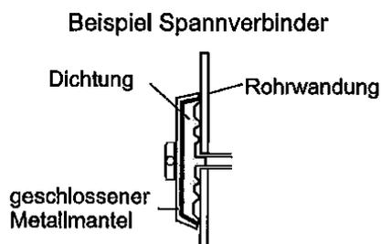
Feuerwiderstandsfähige Abschottung für Rohrleitungen aus Gusseisen mit Anschluss von Rohren aus Kunststoff "PREIS Pyro:Stop System, Variante 2"
