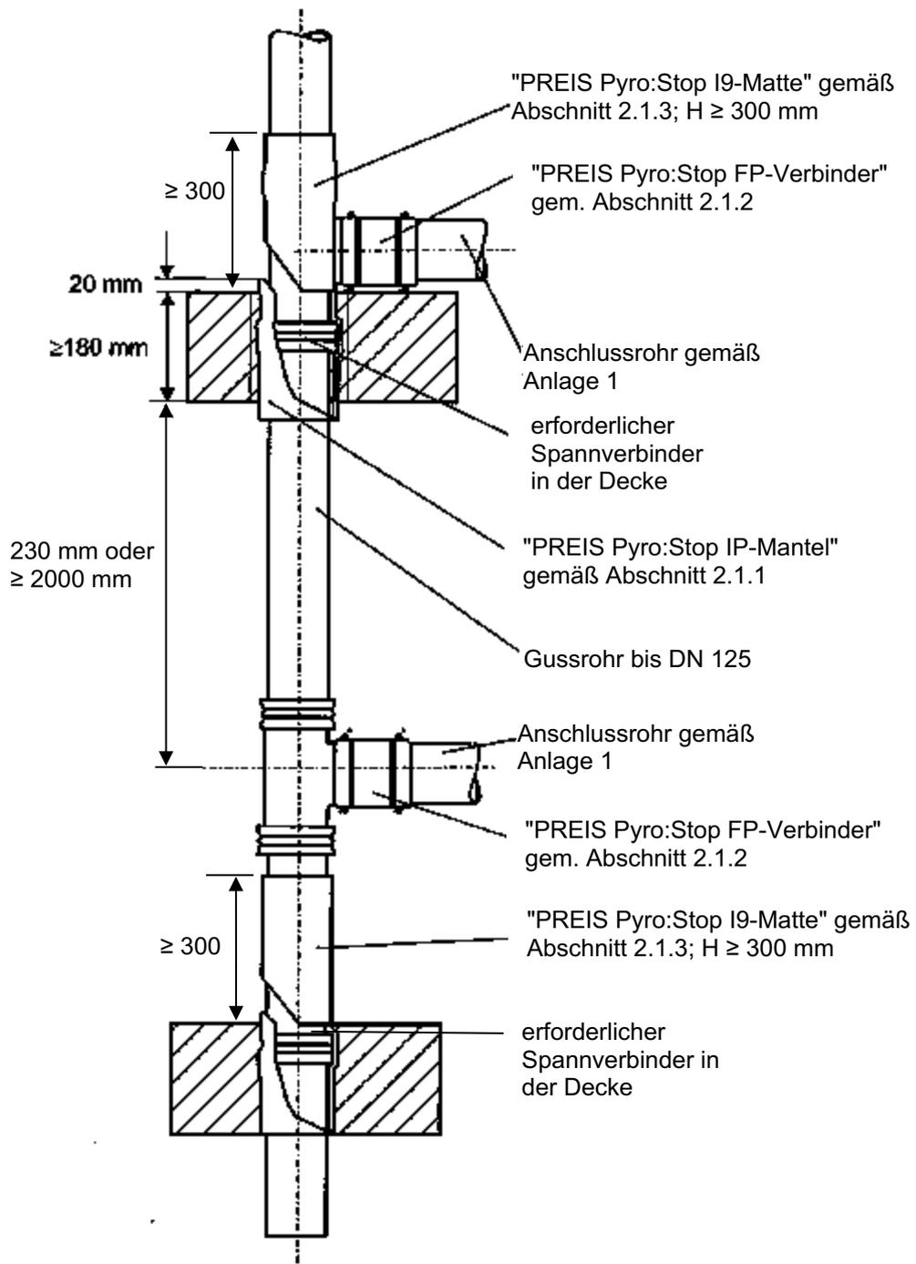
Feuerwiderstandsfähige Abschottung für Rohrleitungen aus Gusseisen mit Anschluss von Rohren aus Kunststoff "PREIS Pyro:Stop System, Variante 2"
