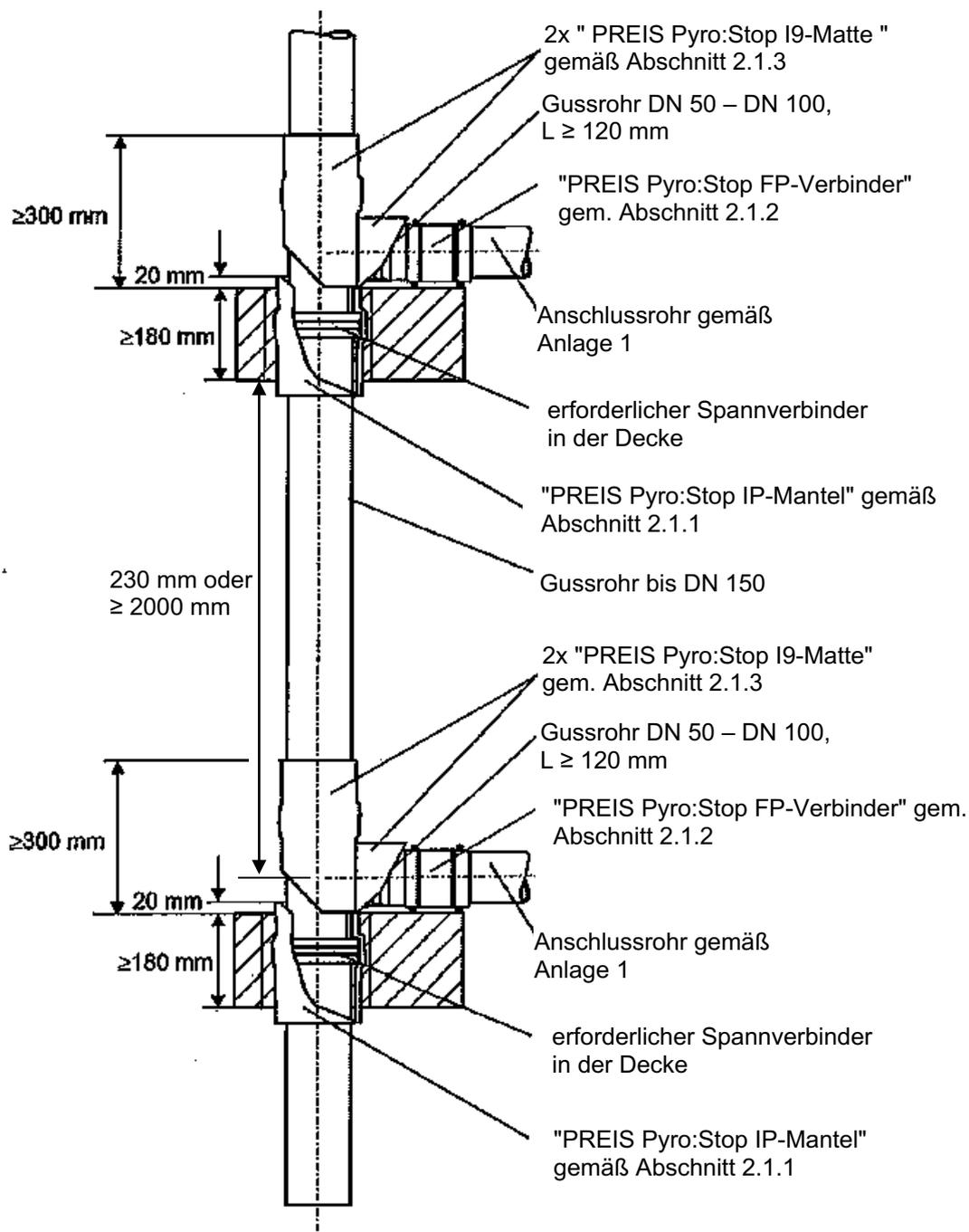
Feuerwiderstandsfähige Abschottung für Rohrleitungen aus Gusseisen mit Anschluss von Rohren aus Kunststoff "PREIS Pyro:Stop System, Variante 2"
