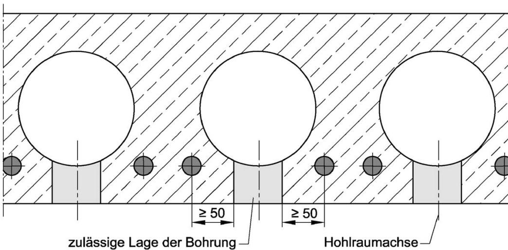
Wird der Dübel nicht mittig in die Hohlraumachse gesetzt, so muss der Abstand zwischen der Dübelachse und der Achse der Spannritze mindestens 50 mm betragen, entsprechend der o.g. Darstellung.
