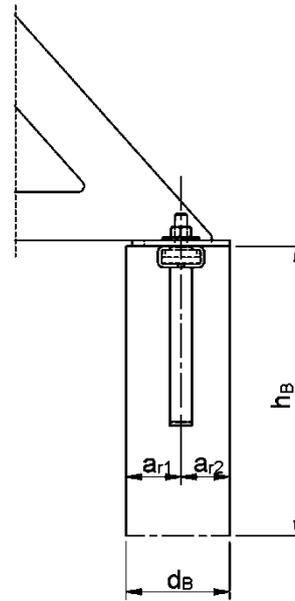
**JORDAHL Fertigteilhalter JFT+ zur Befestigung von Betonfertigteilstürzen**
