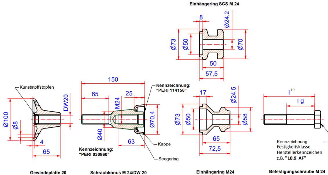
**Bild 3:** Einzelteile und Abmessungen PERI Schraubkonus M24/DW 20
