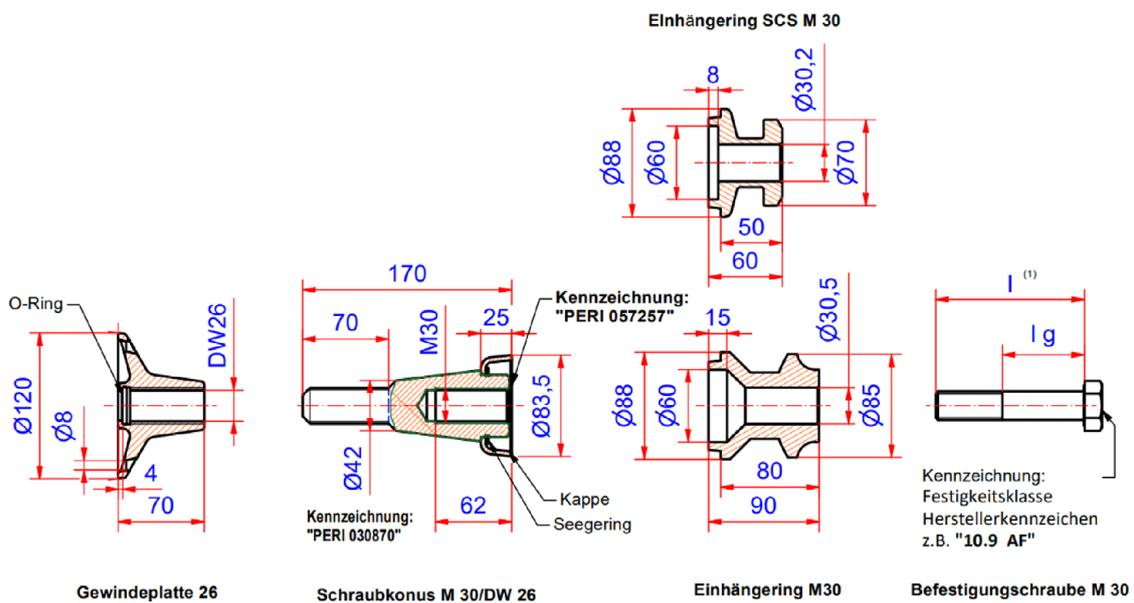
**Bild 4:** Einzelteile und Abmessungen PERI Schraubkonus M30/DW 26
