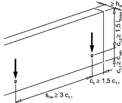
**Bild 18:** Einbausituation Wandfläche - Querbeanspruchung mit Betonkantenbruch, ohne Rückhängebewehrung
