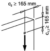
**Bild 15:** Einbausituation Wandfläche - Querbeanspruchung ohne Betonkantenbruch, ohne Rückhängebewehrung für Aufhängekonus 15,0 5cm und Sonderaufhängekonus R 3cm
