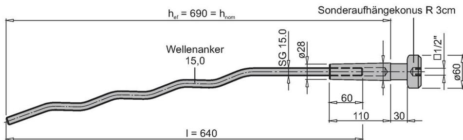
**Bild 10:** Sonderaufhängekonus R 3cm mit Wellenanker 15,0
