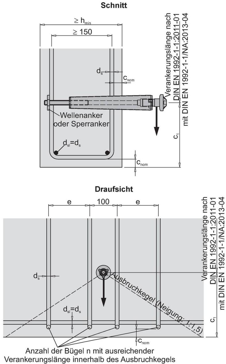
**Bild 28:** Einbausituation in Wänden -
