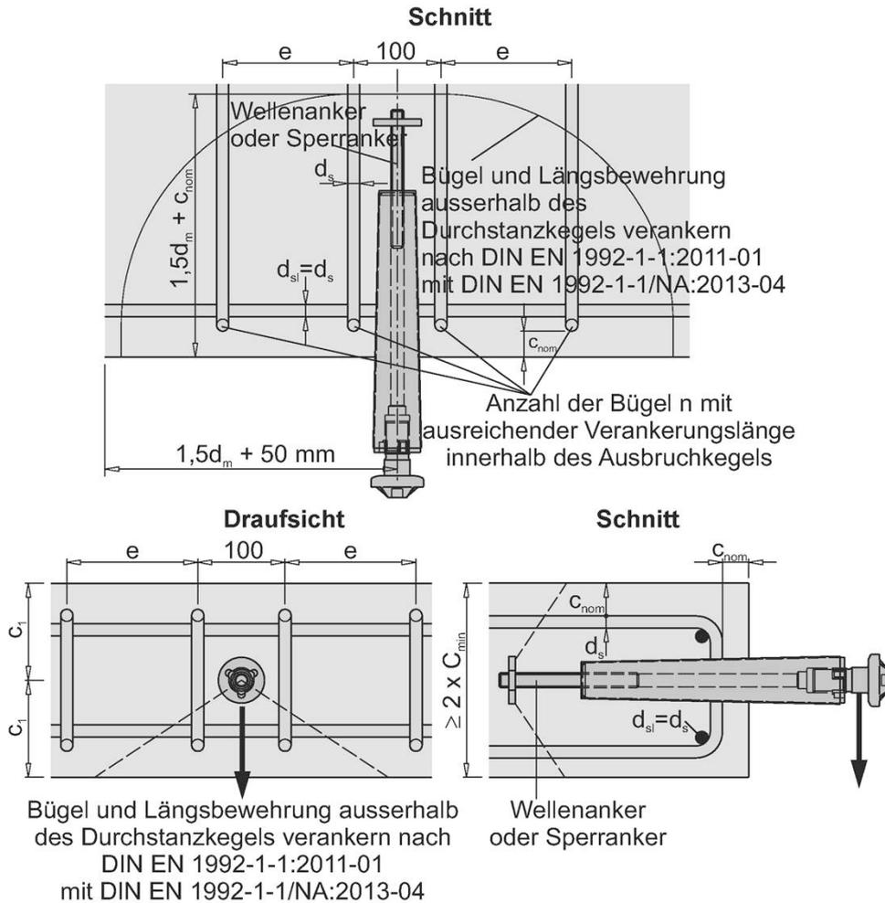
**Bild 30:** Einbausituation Stirnseite -
