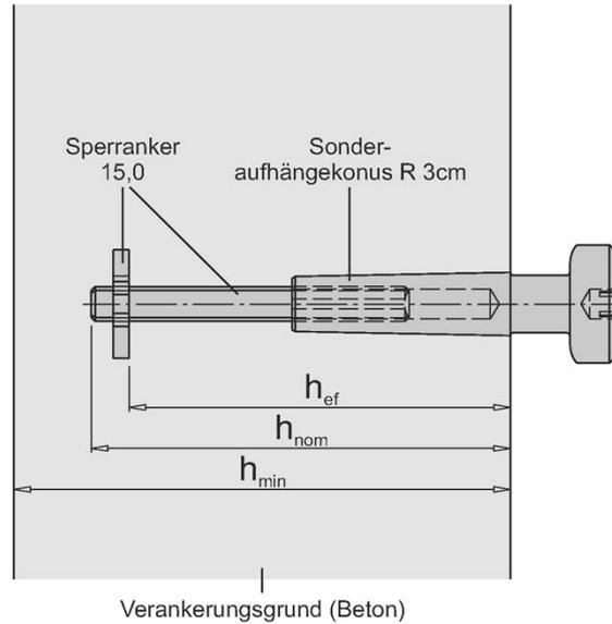
**Bild 3:** Sonderaufhängekonus R 3cm mit Sperranker 15,0 16cm
