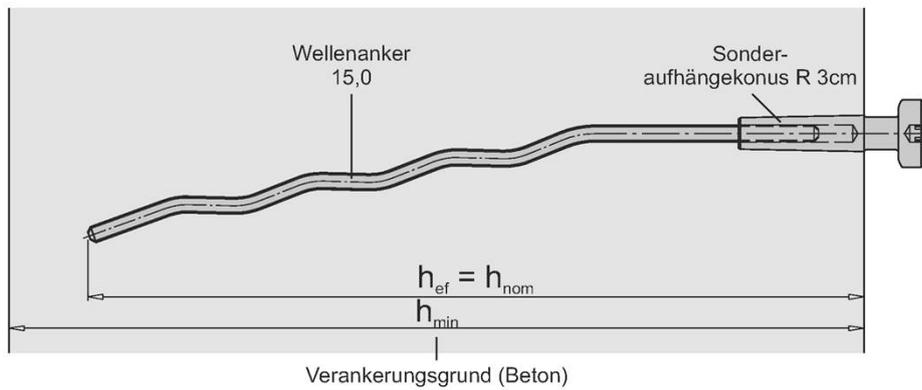
**Bild 4:** Sonderaufhängekonus R 3cm mit Wellenanker 15,0
