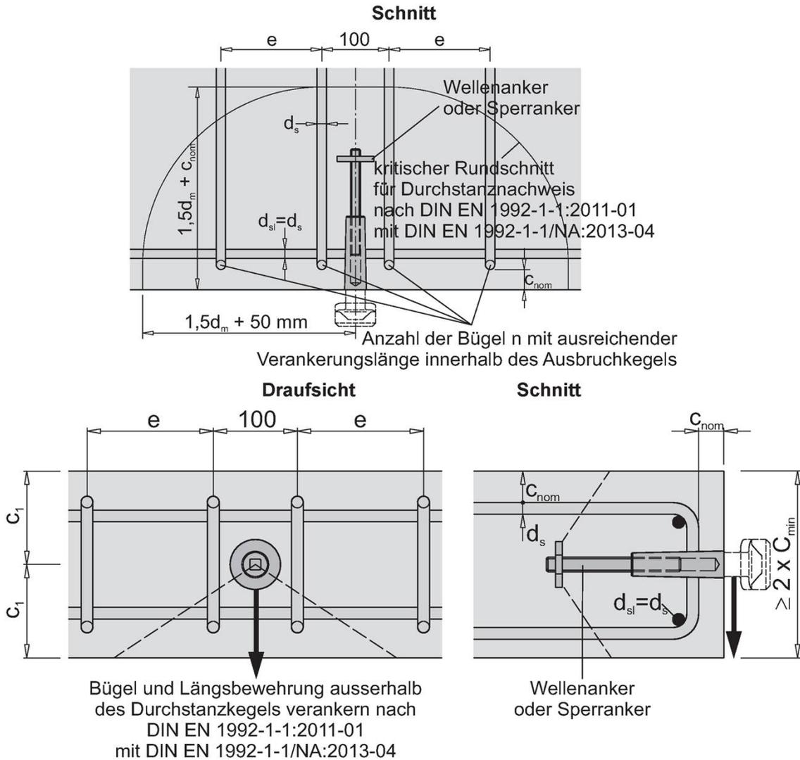
**Bild 29:** Einbausituation Stirnseite - Querbeanspruchung mit Rückhängebewehrung - Bewehrungslage
