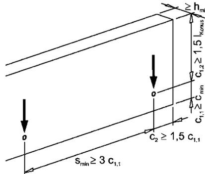
**Bild 14:** Einbausituation Wandfläche - Querbeanspruchung, ohne Rückhängebewehrung
