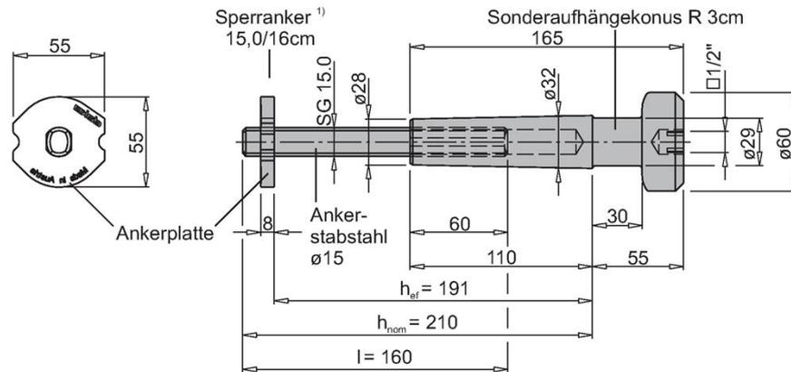
**Bild 9:** Sonderaufhängekonus R 3cm mit Sperranker 15,0 16cm
