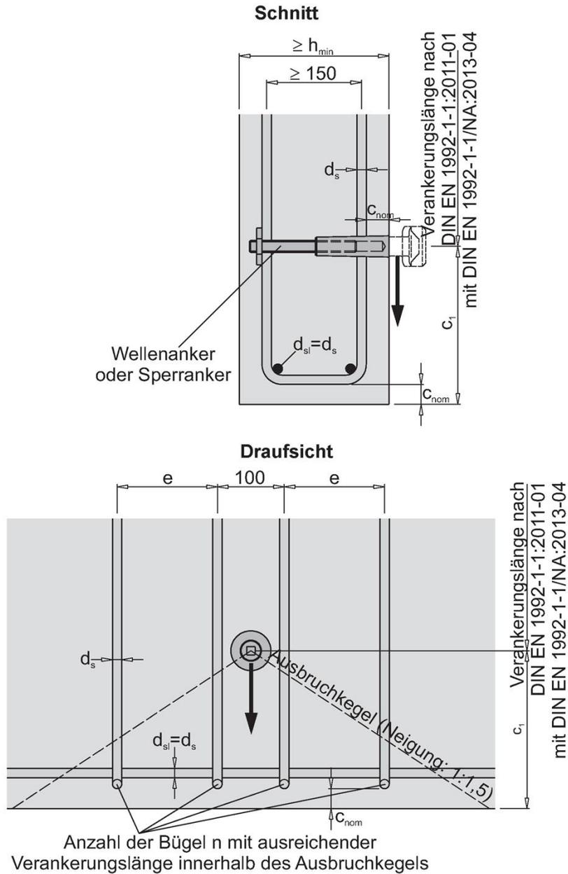
**Bild 27:** Einbausituation in Wänden -
