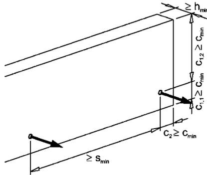
**Bild 17:** Einbausituation Wandfläche - Zugbeanspruchung, ohne Rückhängebewehrung
