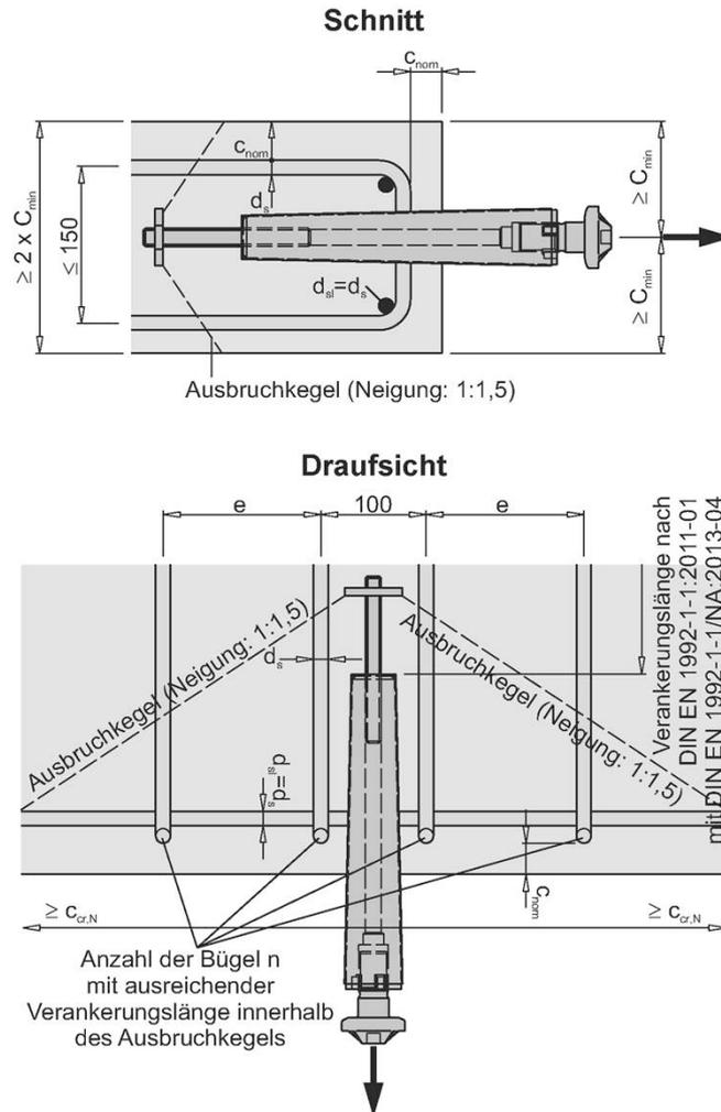
**Bild 24:** Einbausituation Stirnseite - Zugbeanspruchung mit Rückhängebewehrung - Bewehrungslage
