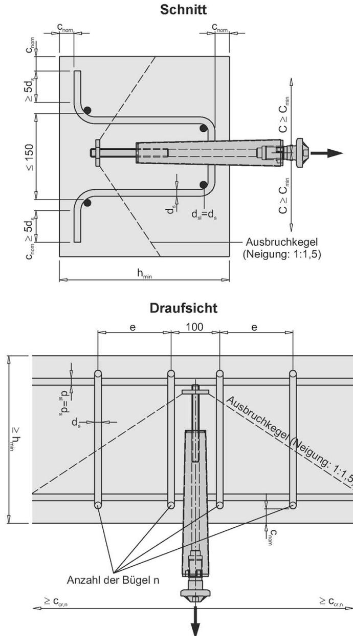
**Bild 26:** Einbausituation in dünne Wände -
