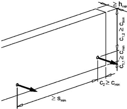
**Bild 13:** Einbausituation Wandfläche - Zugbeanspruchung, ohne Rückhängebewehrung
