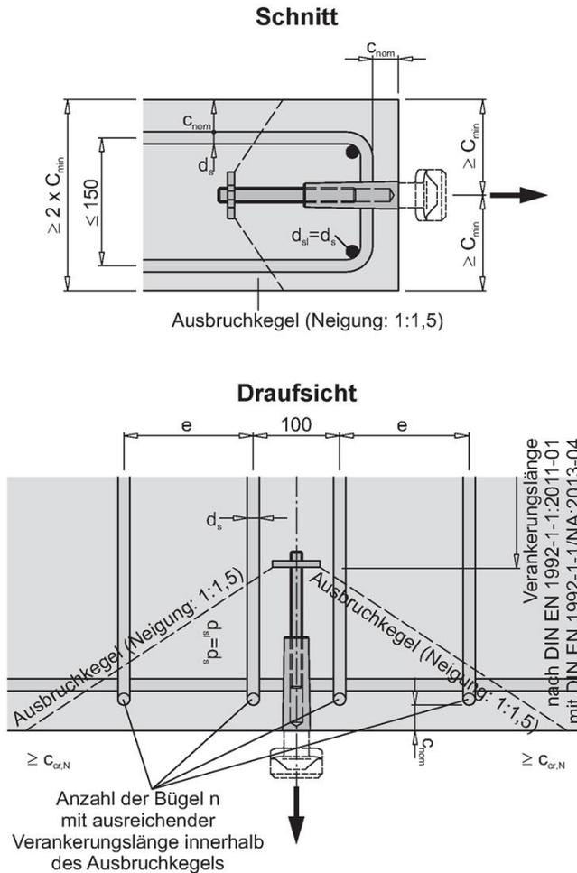
**Bild 23:** Einbausituation Stirnseite - Zugbeanspruchung mit Rückhängebewehrung - Bewehrungslage
