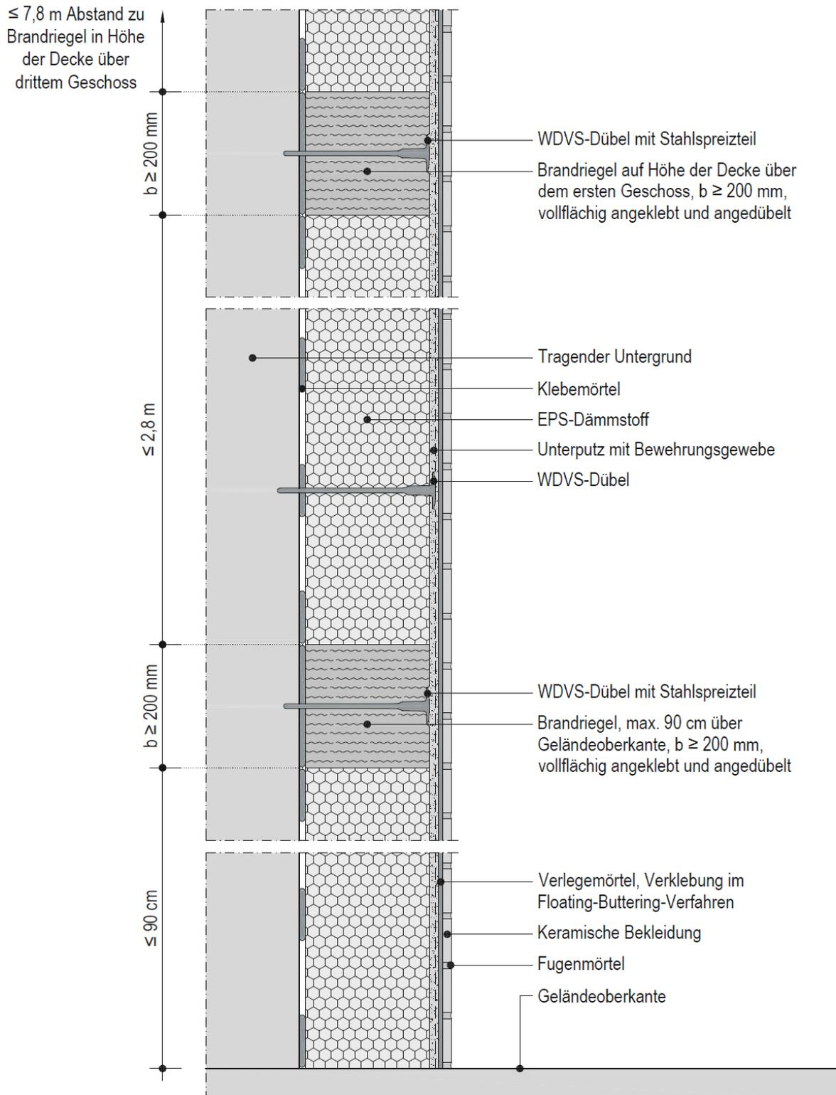
Schematische Darstellung der Ausführung einer
