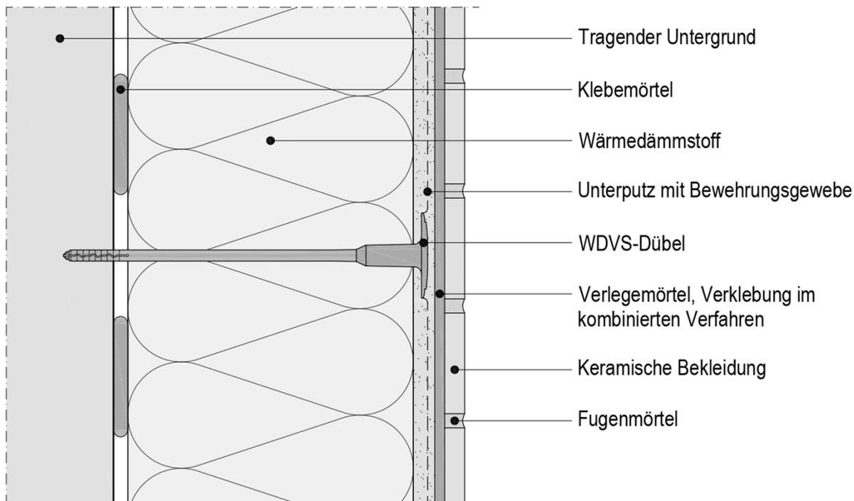
**Zeichnerische Darstellung der WDVS Deckenunterseiten** Anlage 1.2
