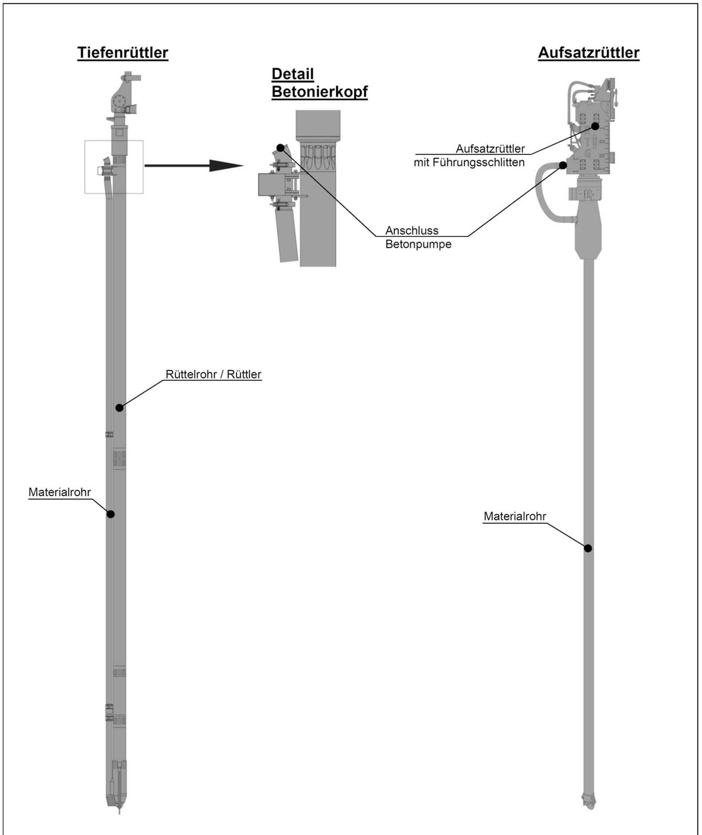
Rüttel-Ortbeton-Pfähle (ROB-Pfähle), Rüttel-Stopfbeton-Säulen (RSB-Säulen), Vermörtelte Rüttelstopfverdichtungssäulen (RSVv-Säulen)
