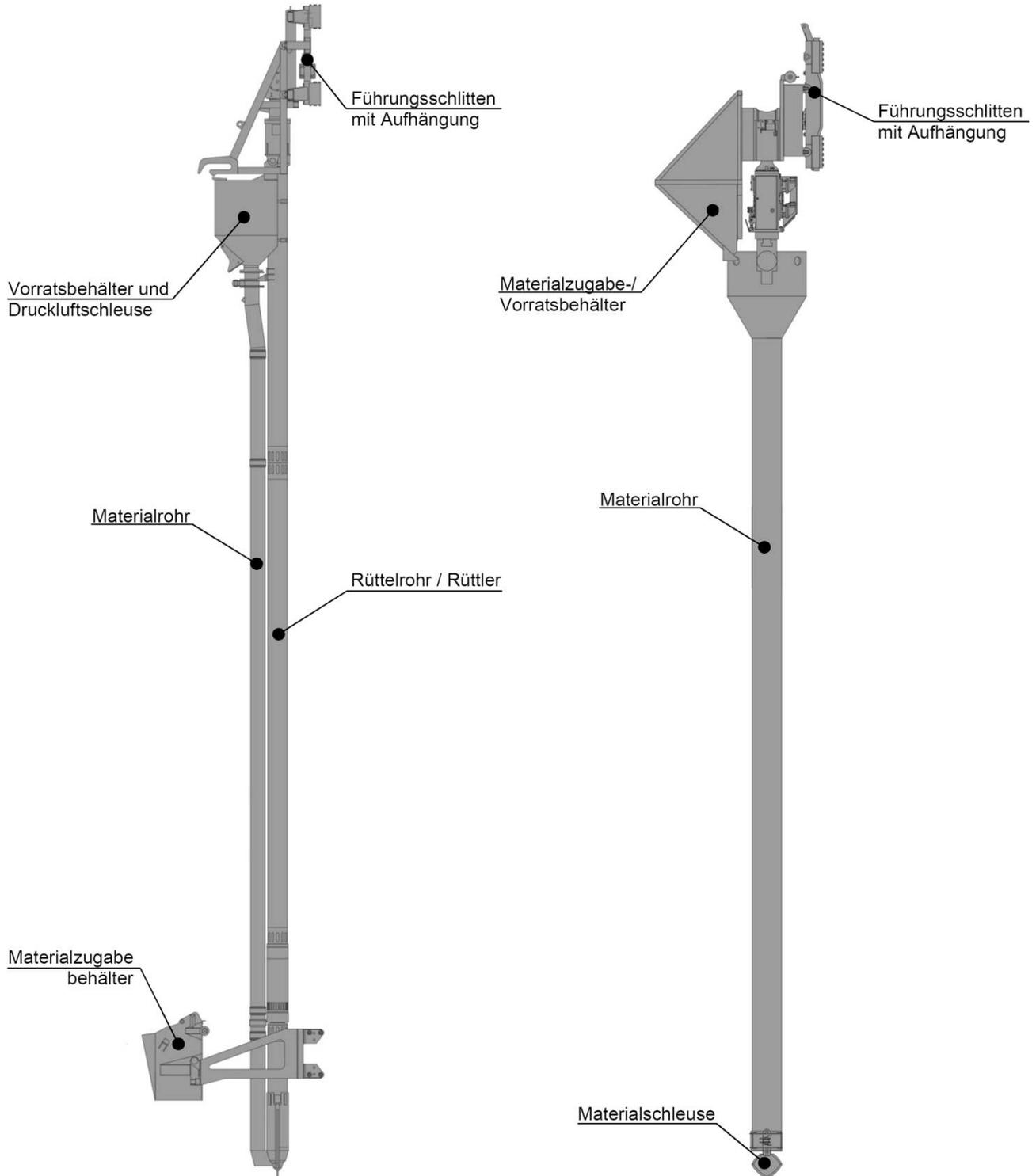
Rüttel-Ortbeton-Pfähle (ROB-Pfähle), Rüttel-Stopfbeton-Säulen (RSB-Säulen), Vermörtelte Rüttelstopfverdichtungssäulen (RSVv-Säulen)
