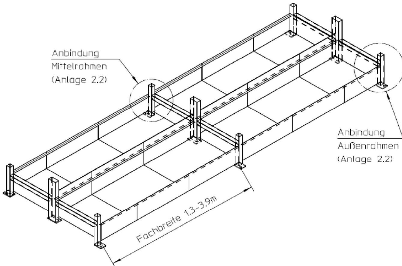
Bei Containervarianten mit nur einer Fachbreite entfällt der Mittelrahmen.
