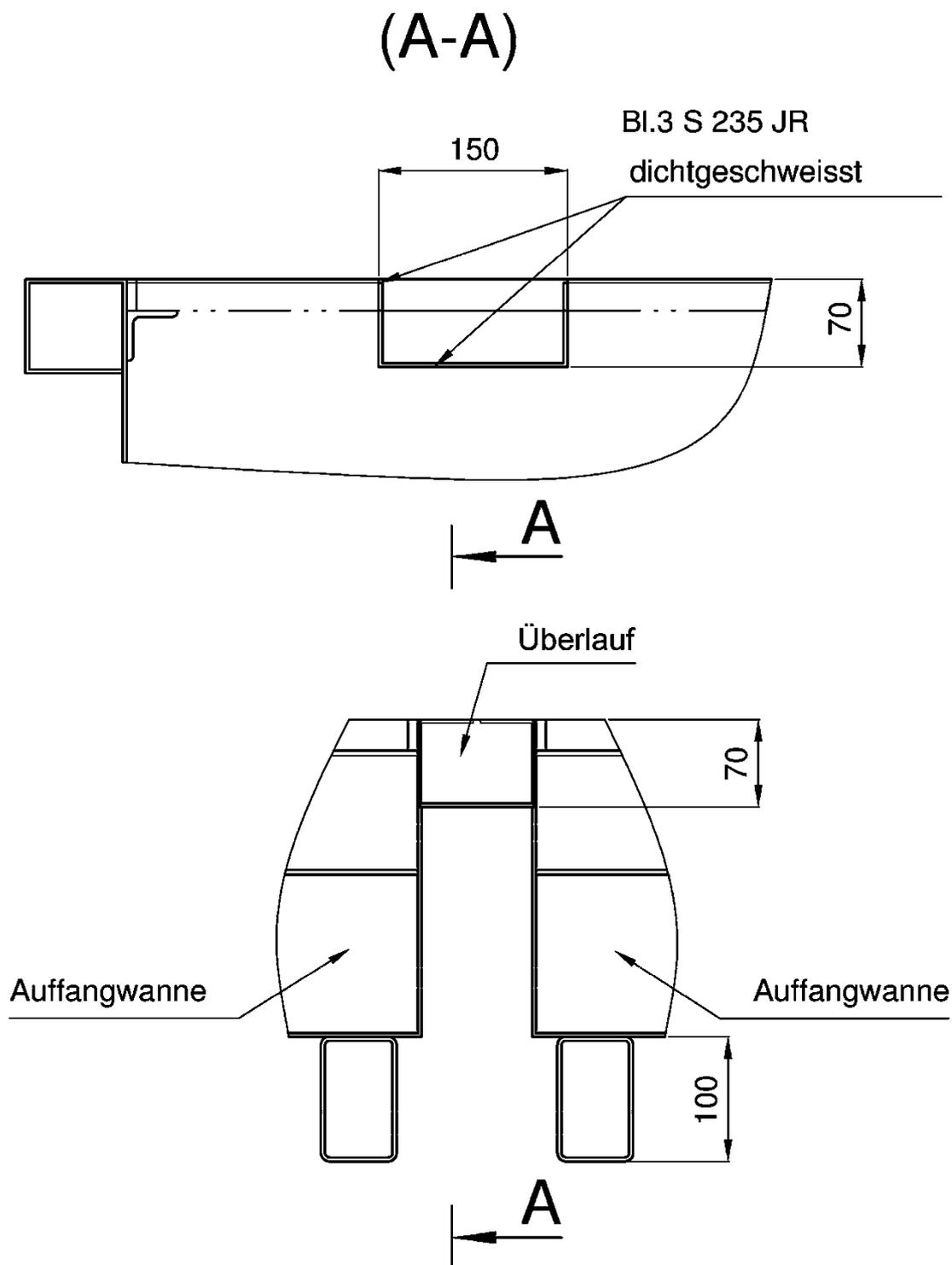
Auffangwannen aus Stahl für Sicherheitslagerhäuser Typ "SLH"
