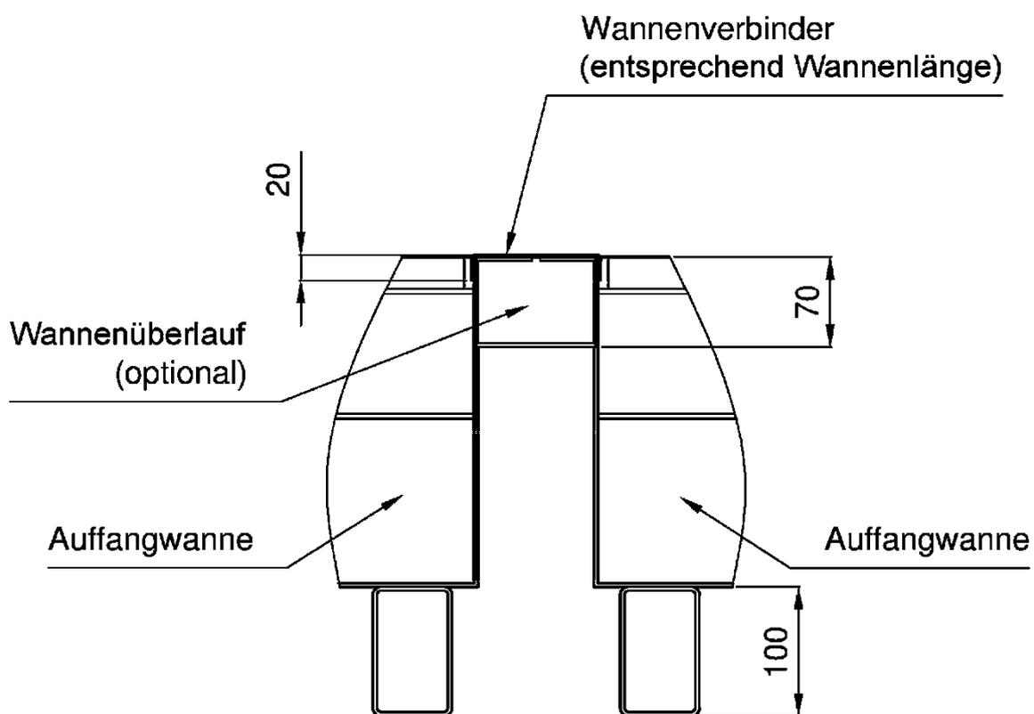
Auffangwannen aus Stahl für Sicherheitslagerhäuser Typ "SLH"
