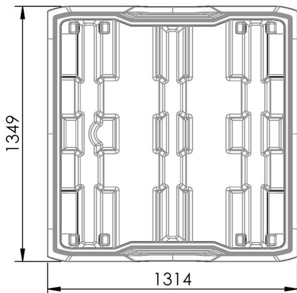
Rotationsgeformte rechteckige Auffangvorrichtungen
