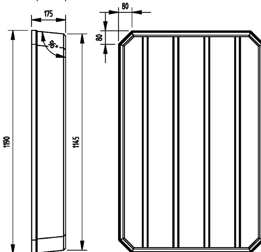
Rotationsgeformte rechteckige Auffangvorrichtungen
