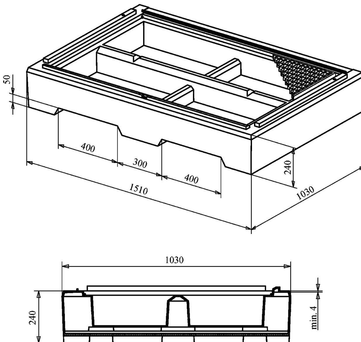
Rotationsgeformte rechteckige Auffangvorrichtungen
