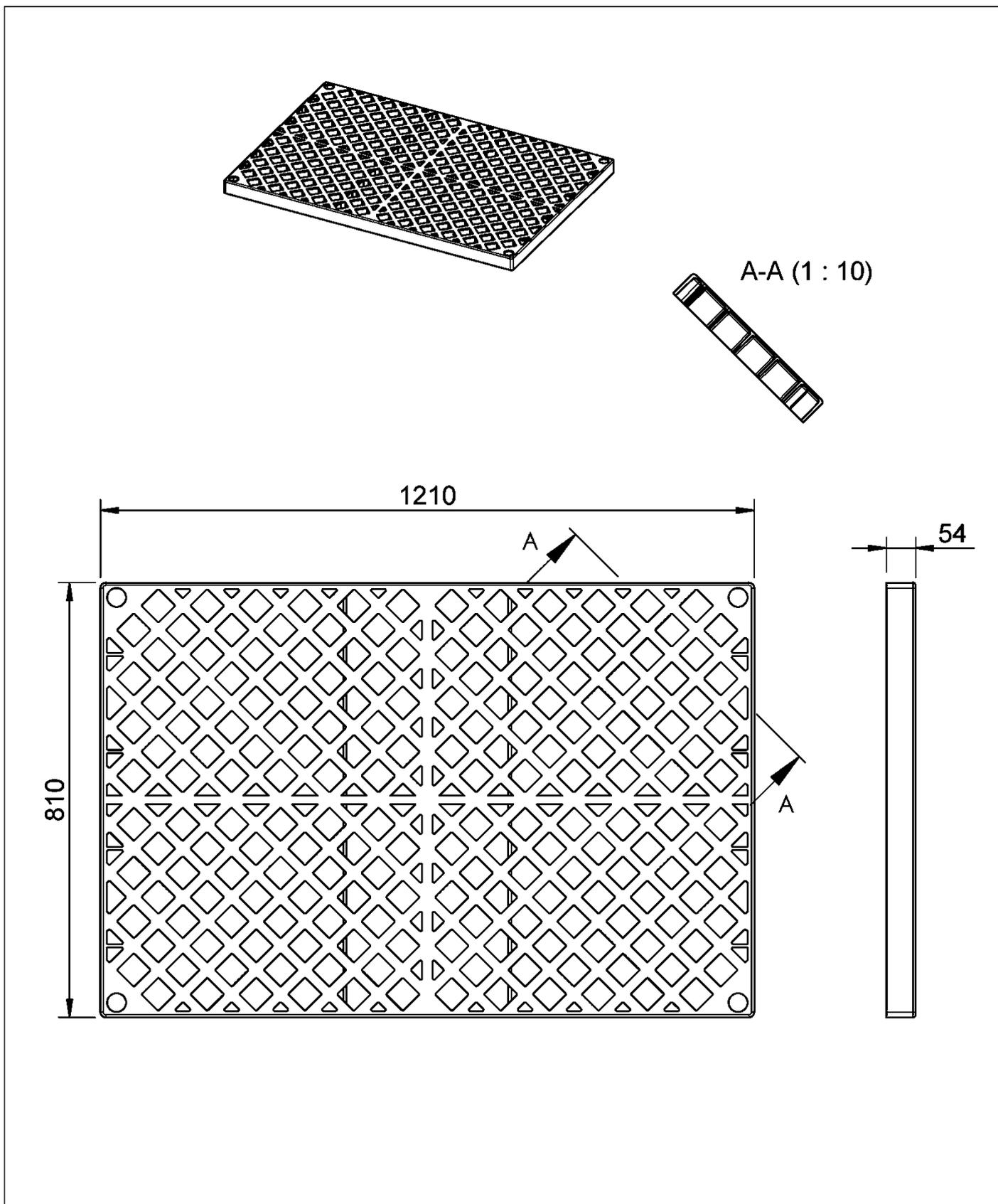
Rotationsgeformte rechteckige Auffangvorrichtungen
