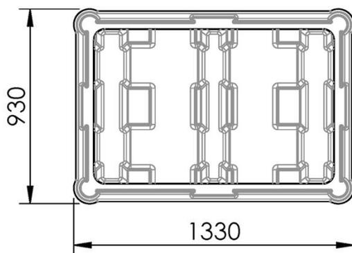
Rotationsgeformte rechteckige Auffangvorrichtungen
