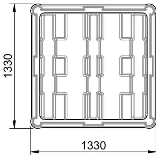
Rotationsgeformte rechteckige Auffangvorrichtungen
