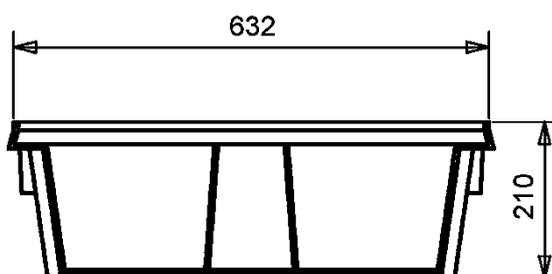
Rotationsgeformte rechteckige Auffangvorrichtungen
