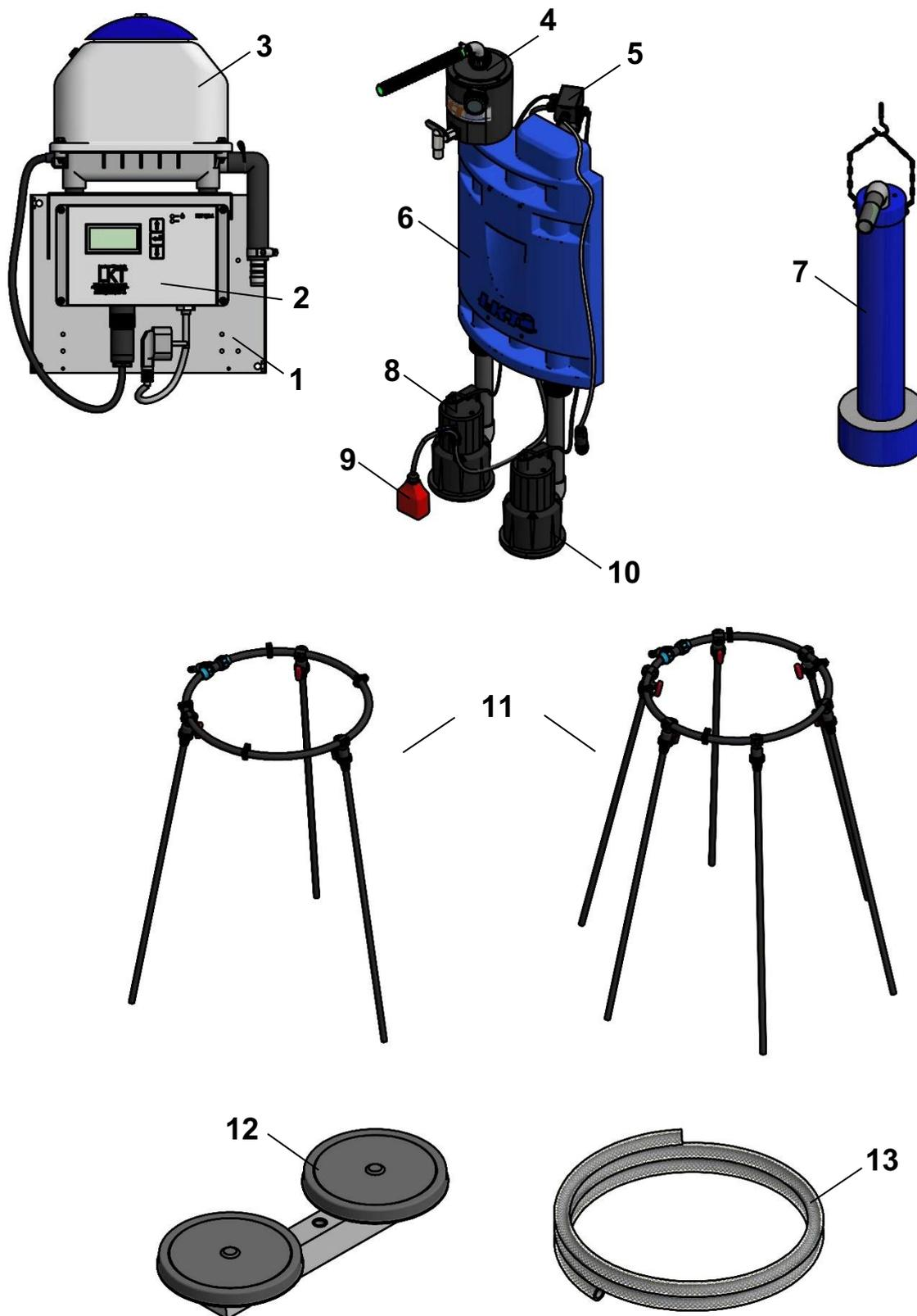
Nachrüstset Typ LKT-BIO für den Einbau in bestehende Abwasserbehandlungsanlagen zur Herstellung von Kleinkläranlagen für 4 bis 50 EW; Ablaufklasse D
