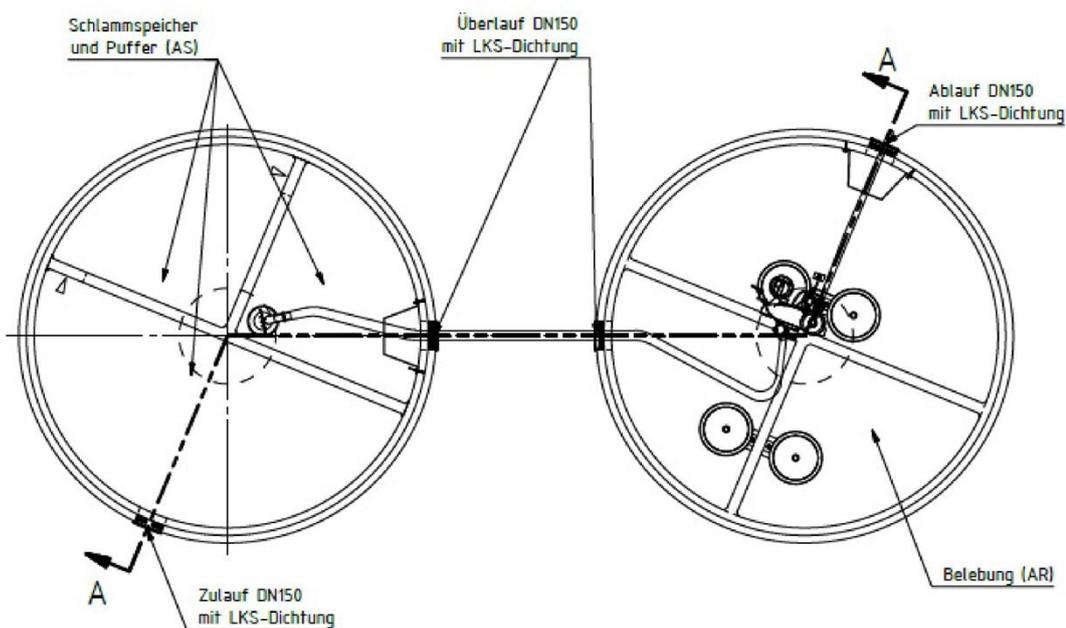
Nachrüstset Typ LKT-BIO für den Einbau in bestehende Abwasserbehandlungsanlagen zur Herstellung von Kleinkläranlagen für 4 bis 50 EW; Ablaufklasse D
