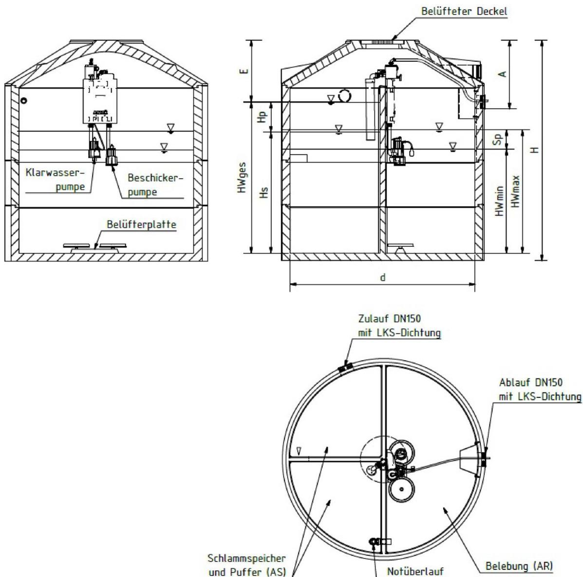
Nachrüstatz Typ LKT-BIO für den Einbau in bestehende Abwasserbehandlungsanlagen zur Herstellung von Kleinkläranlagen für 4 bis 50 EW; Ablaufklasse D
