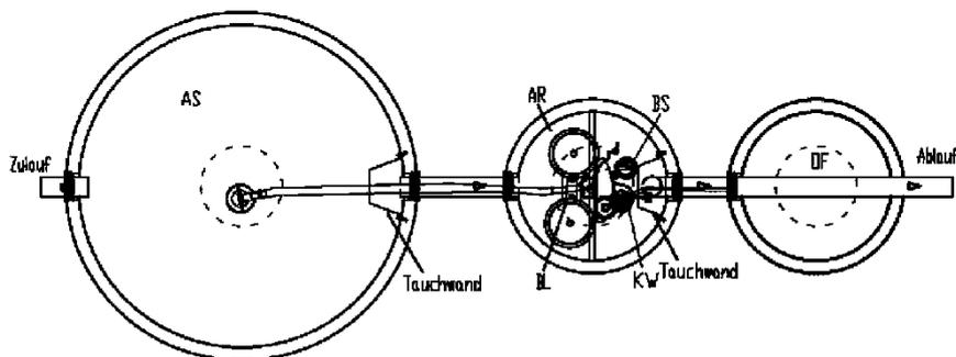
Abkürzungen: AS = Schlamm-speicher und Puffer; AR = Belebung; OF = ohne Funktion; KW = Klarwasserpumpe; BS = Beschickerpumpe; BL = Belüfterplatte(n)
