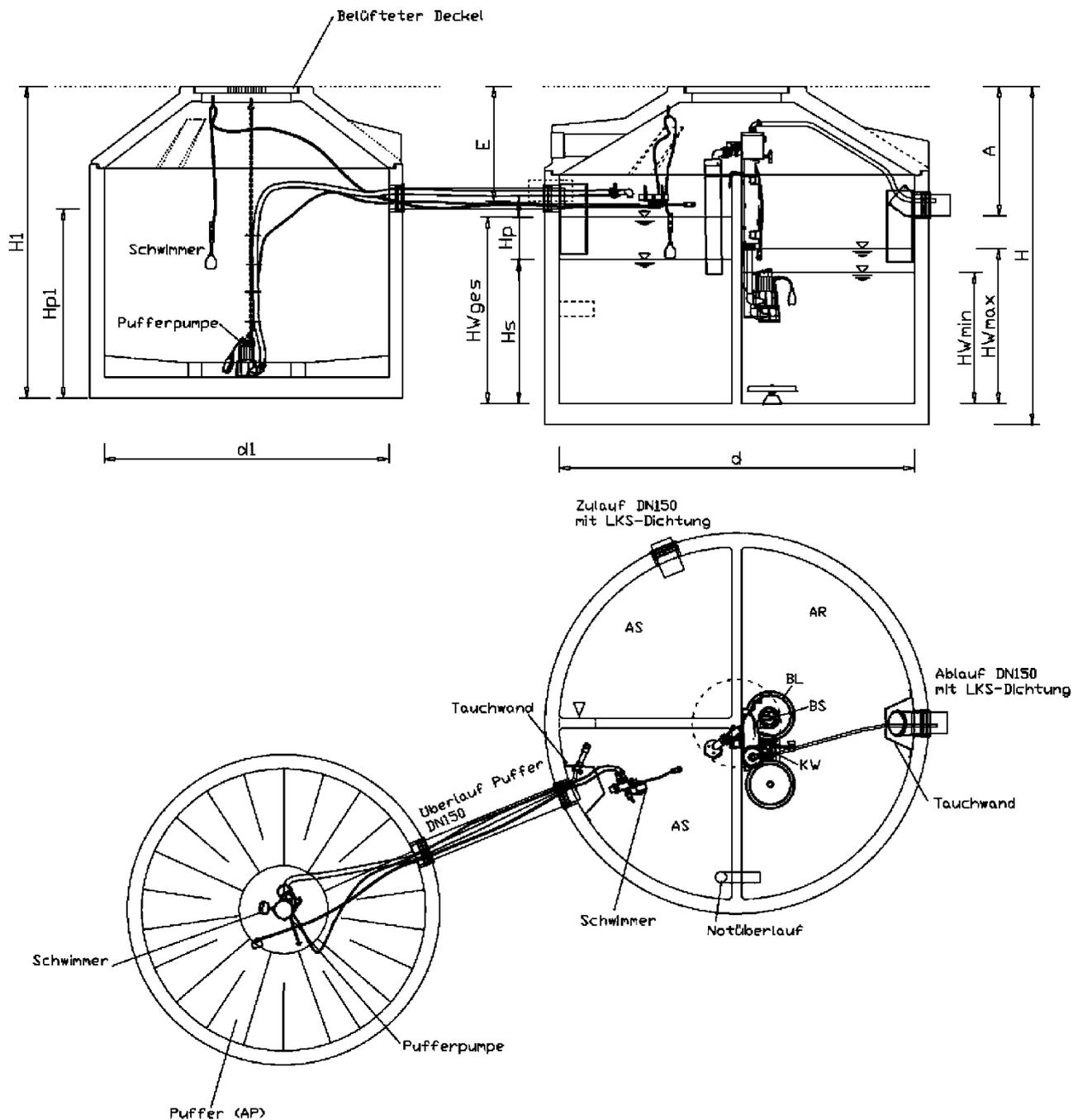
Nachrüstset Typ LKT-BIO für den Einbau in bestehende Abwasserbehandlungsanlagen zur Herstellung von Kleinkläranlagen für 4 bis 50 EW; Ablaufklasse D
