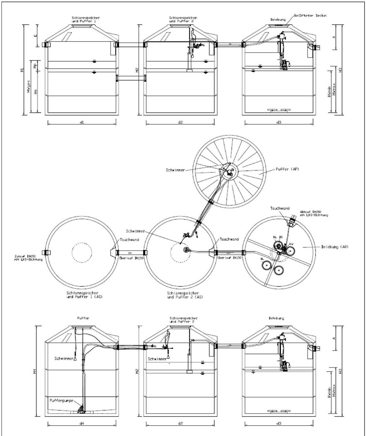
Nachrüstatz Typ LKT-BIO für den Einbau in bestehende Abwasserbehandlungsanlagen zur Herstellung von Kleinkläranlagen für 4 bis 50 EW; Ablaufklasse D
