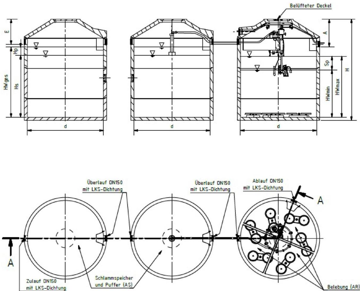
Nachrüstatz Typ LKT-BIO für den Einbau in bestehende Abwasserbehandlungsanlagen zur Herstellung von Kleinkläranlagen für 4 bis 50 EW; Ablaufklasse D
