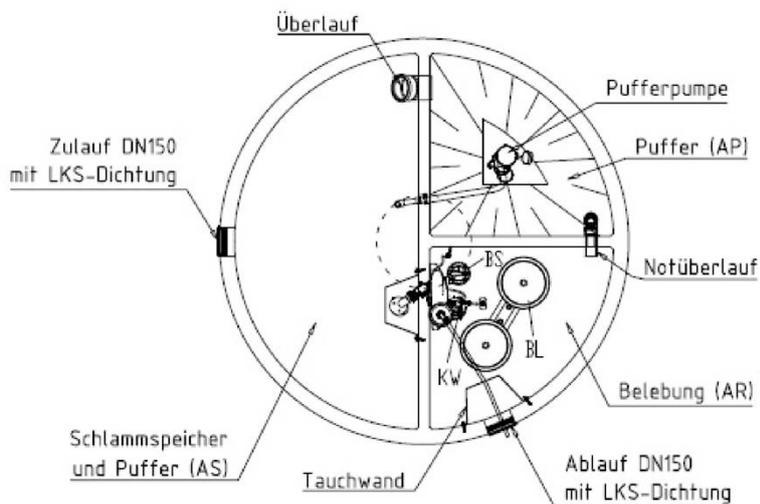
Nachrüstatz Typ LKT-BIO für den Einbau in bestehende Abwasserbehandlungsanlagen zur Herstellung von Kleinkläranlagen für 4 bis 50 EW; Ablaufklasse D
