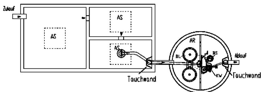
Abkürzungen: AS = Schlamm-speicher und Puffer; AR = Belebung; OF = ohne Funktion; KW = Klarwasserpumpe; BS = Beschickerpumpe; BL = Belüfterplatte(n)
