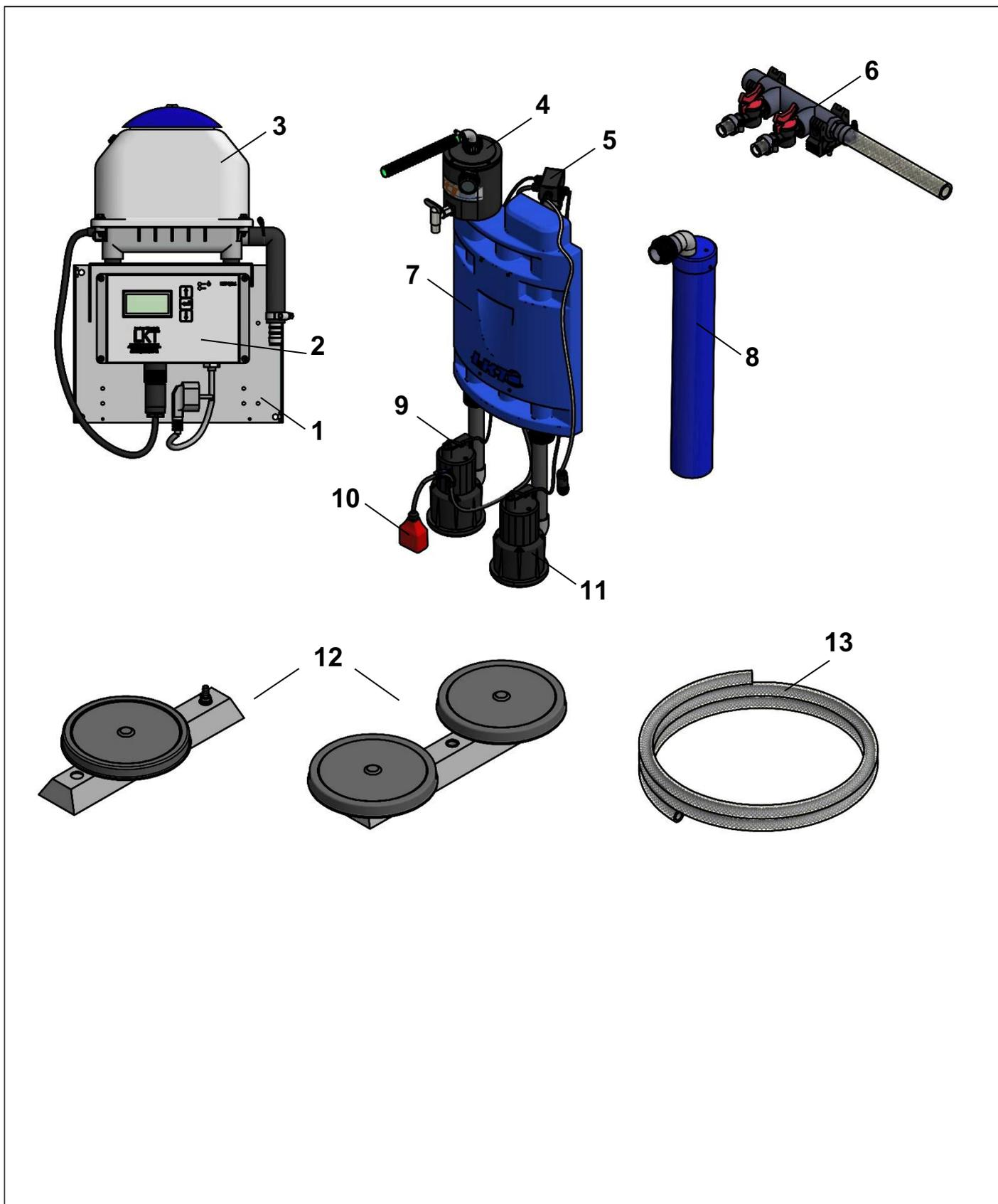
Nachrüstset Typ LKT-BIO für den Einbau in bestehende Abwasserbehandlungsanlagen zur Herstellung von Kleinkläranlagen für 4 bis 50 EW; Ablaufklasse D
