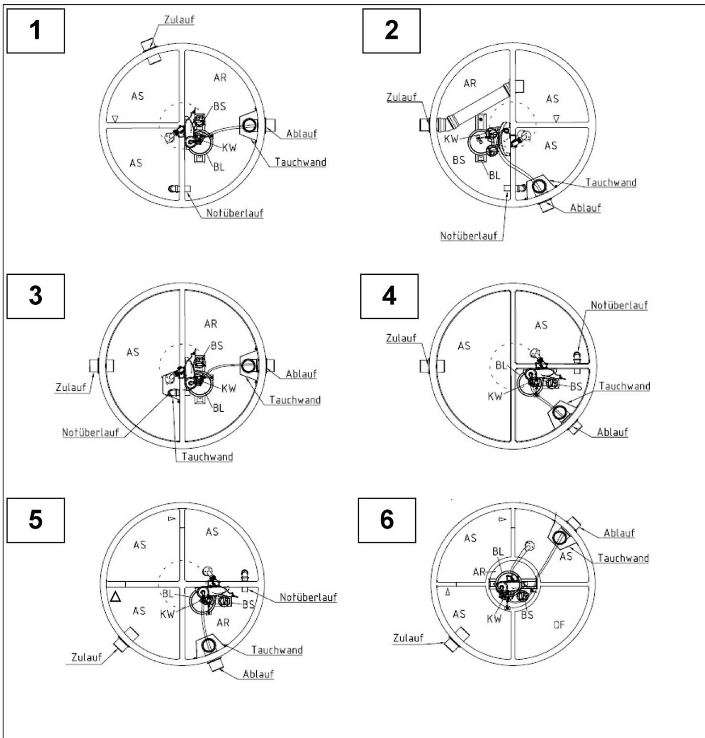
Abkürzungen: AS = Schlamm-speicher und Puffer; AR = Belebung; OF = ohne Funktion; KW = Klarwasserpumpe; BS = Beschickerpumpe; BL = Belüfterplatte(n)
