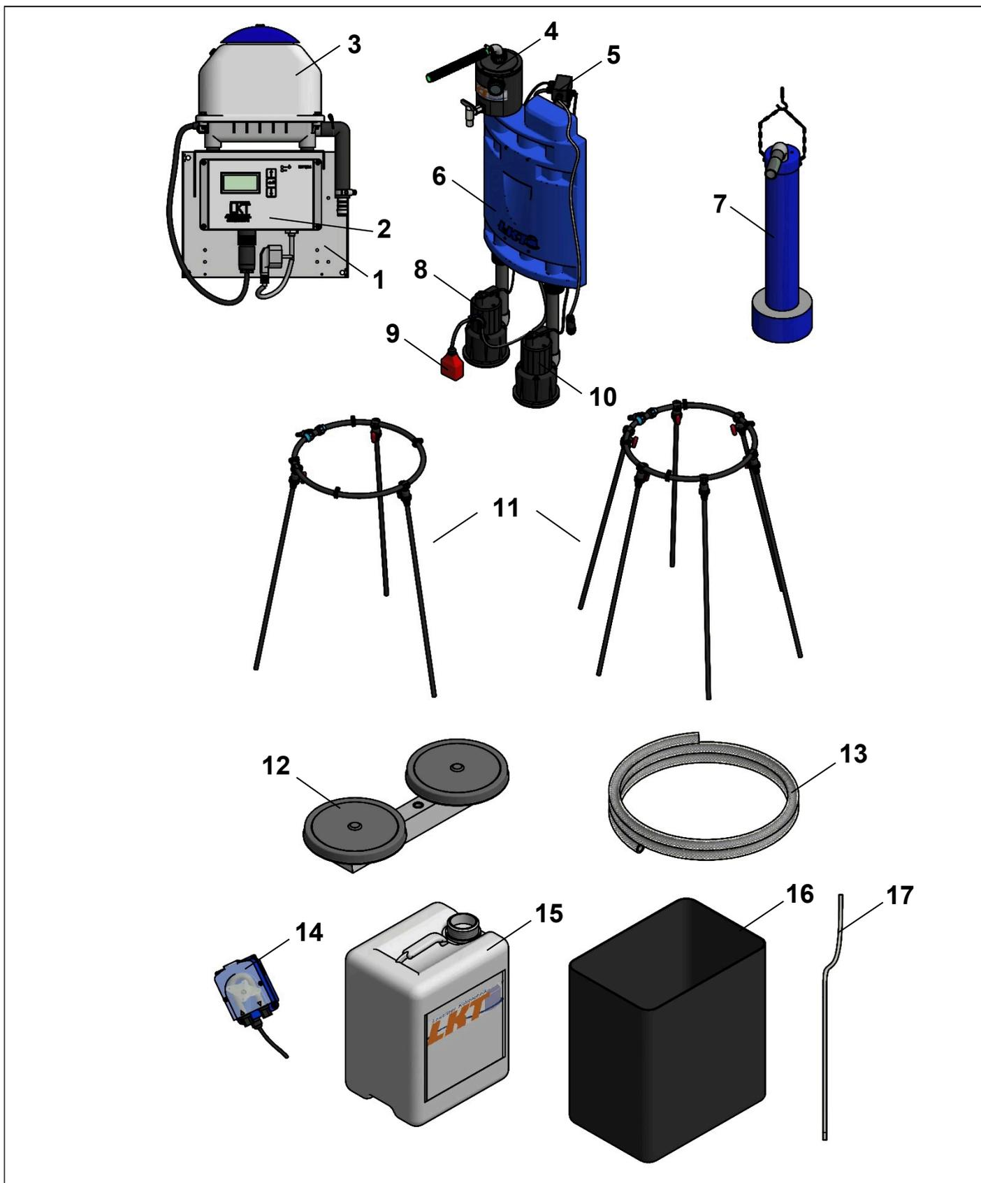
Nachrüstset Typ LKT-BIO für den Einbau in bestehende Abwasserbehandlungsanlagen zur Herstellung von Kleinkläranlagen für 4 bis 50 EW; Ablaufklasse D+P
