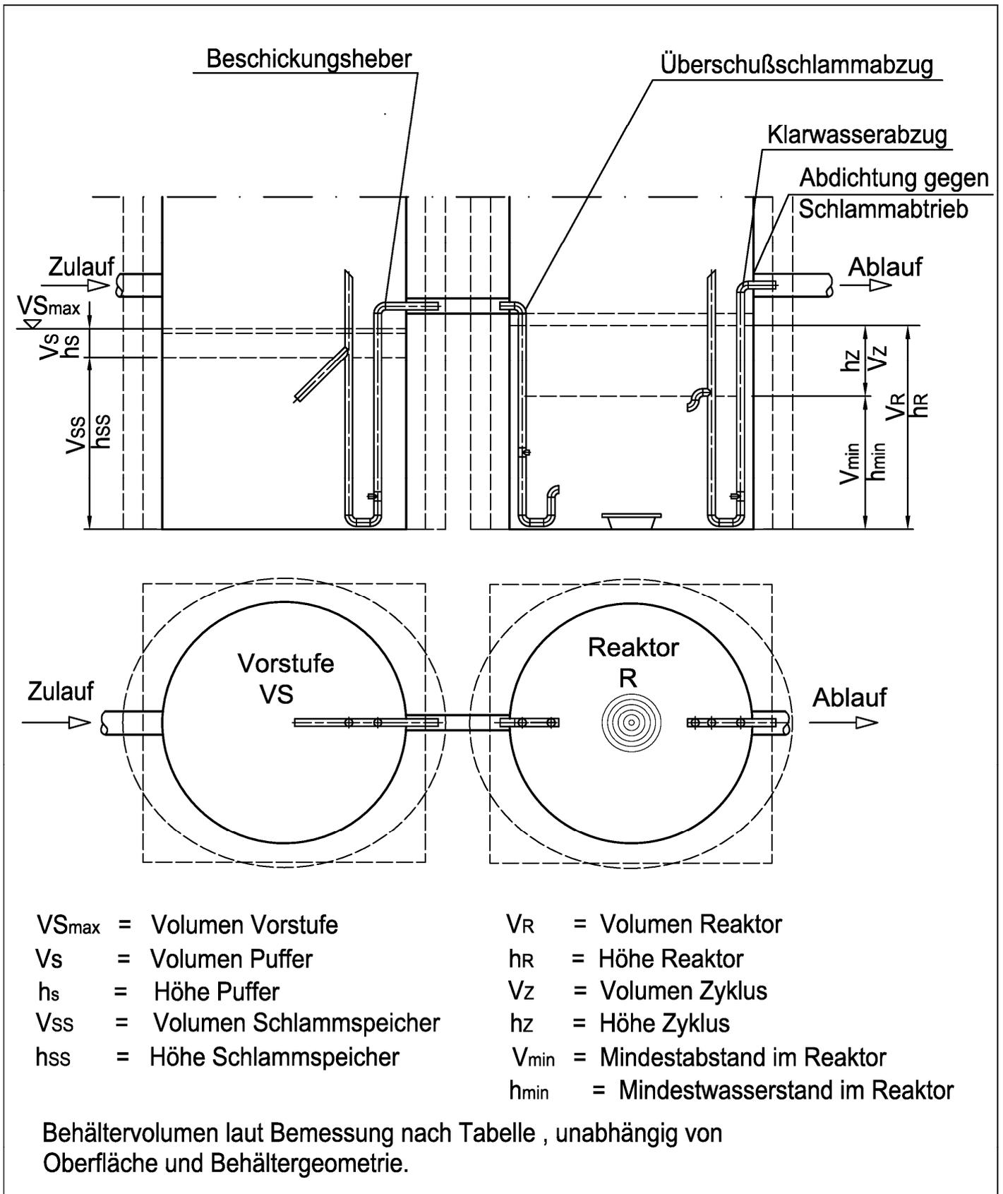
Nachrüstatz Typ klärofix C / klärbox C für den Einbau in bestehende Abwasserbehandlungsanlagen zur Herstellung von Kleinkläranlagen von 4 bis 50 EW, Ablaufklasse C
