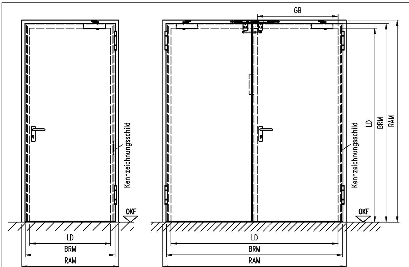
T90-1-RS-FSA und T90-2-RS-FSA immer mit absenkbarer Bodendichtung oder umlaufender Zargendichtung ausführen. Wandanschluss immer mind. auf Öffnungsseite (Bandseite) des FSA versiegeln !
