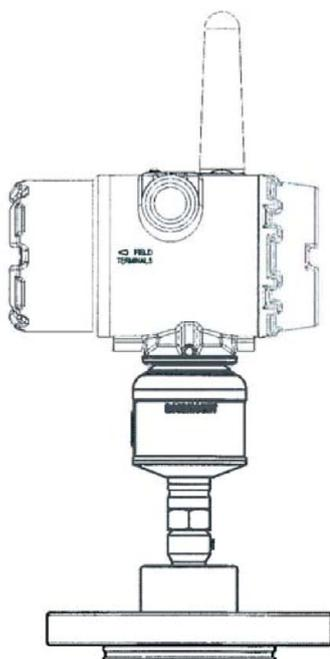
Modell 3051S Wireless, Ausführung Inline mit Druckmittler
