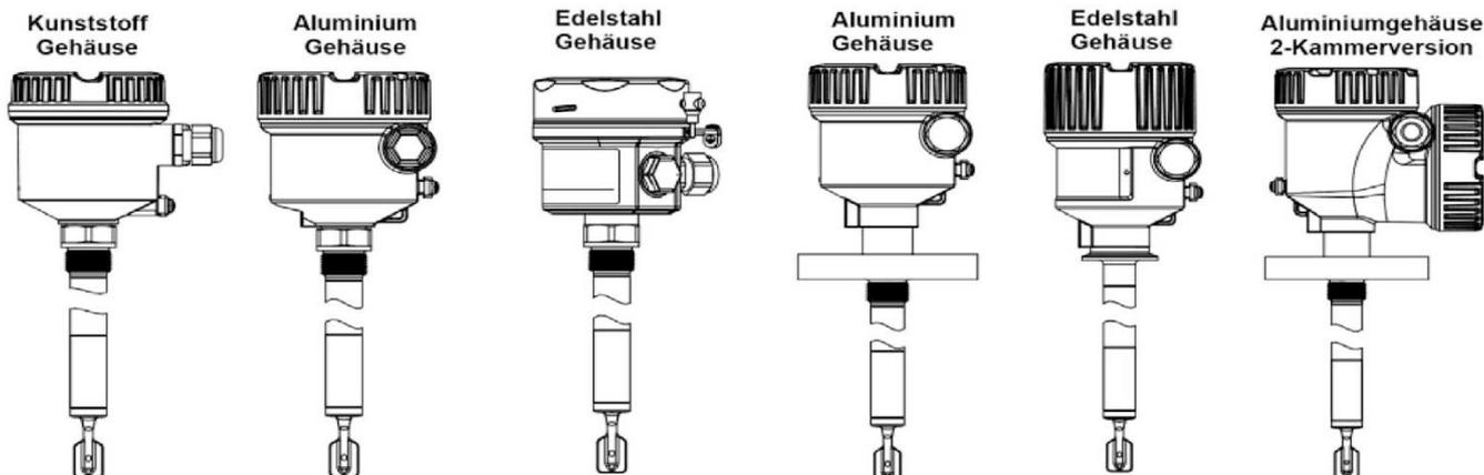
Schema der Leckagesonde für alle Typen und eingebautem Messumformer
