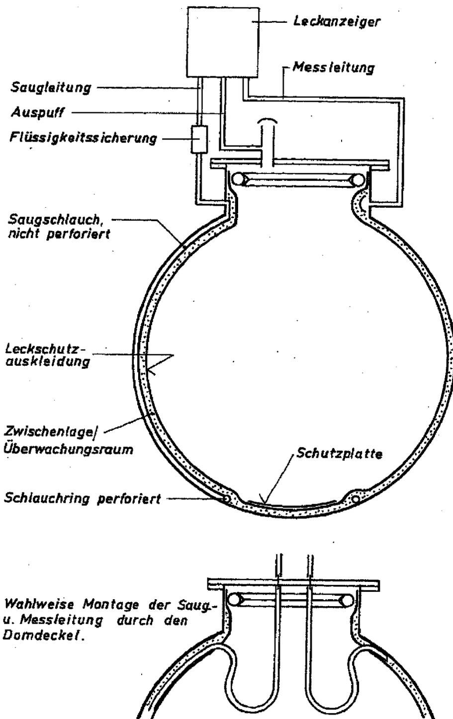
Leckschutzauskleidung Typ "WH...-ÖL" und Typ "WH...-TLT" als Teil eines Leckanzeigergerätes für Behälter zum Lagern von Ölen und Kraftstoffen
