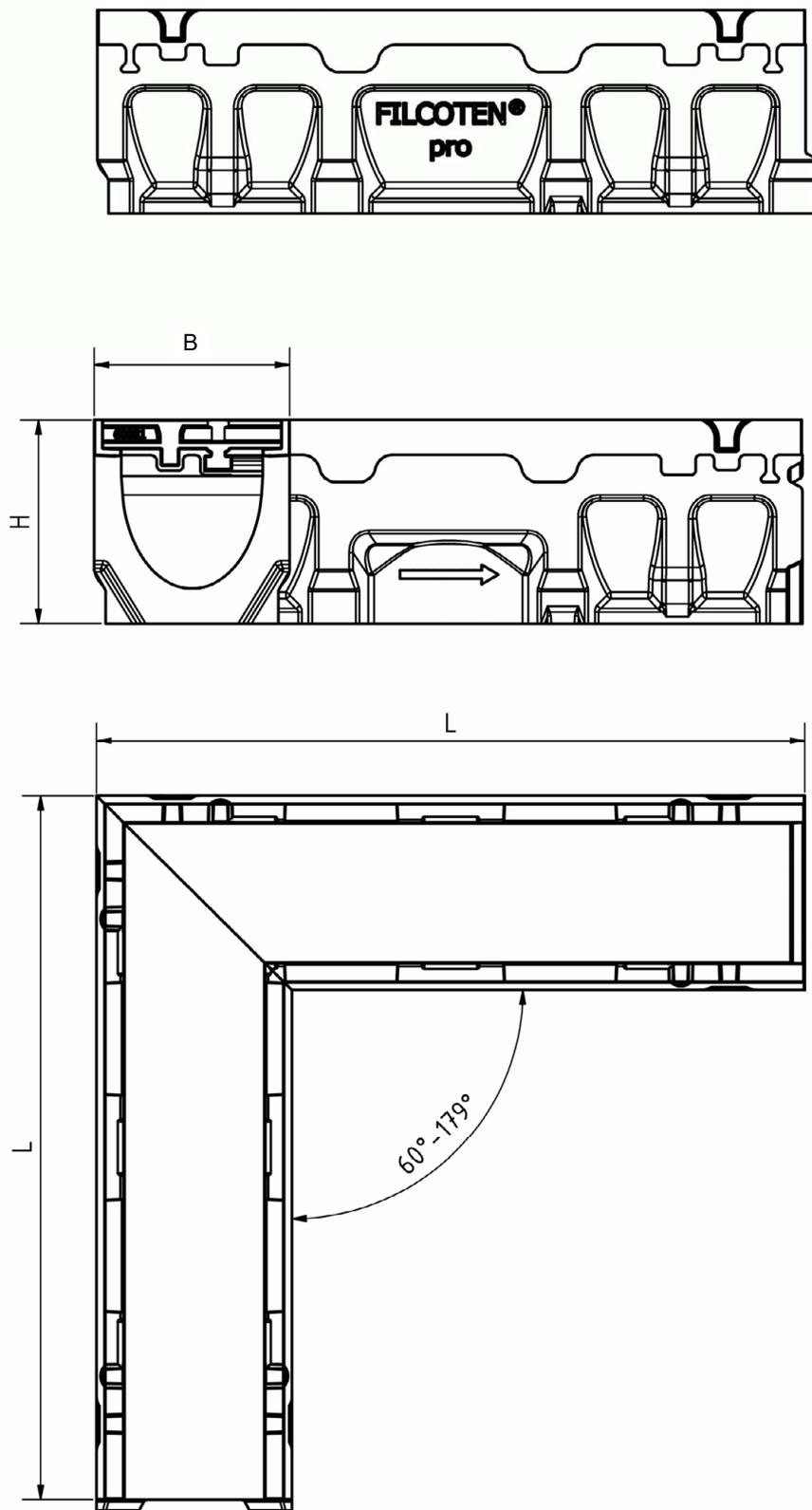
BG-FILCOTEN pro Kastenrinnensystem für die Verwendung in LAU-Anlagen
