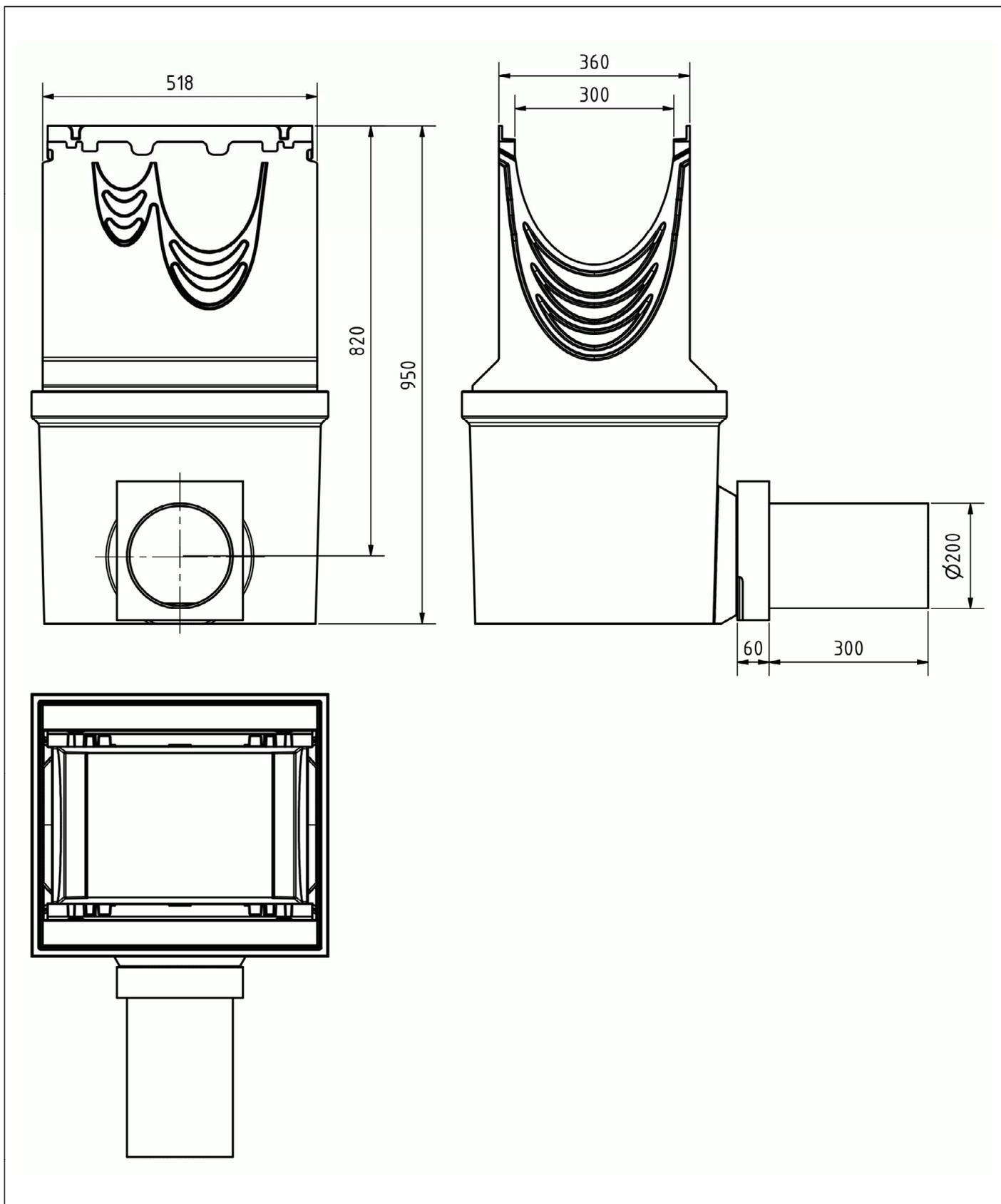
BG-FILCOTEN pro Kastenrinnensystem für die Verwendung in LAU-Anlagen
