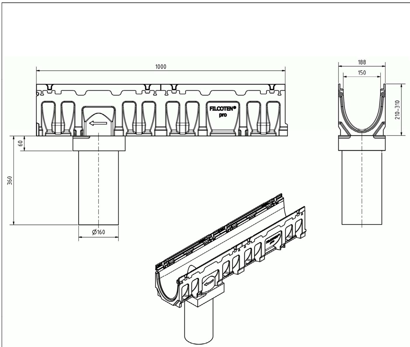
BG-FILCOTEN pro Kastenrinnensystem für die Verwendung in LAU-Anlagen
