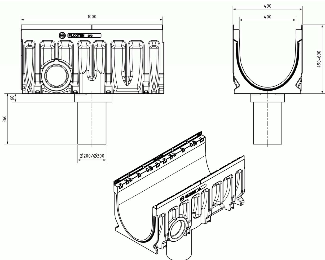
BG-FILCOTEN pro Kastenrinnensystem für die Verwendung in LAU-Anlagen
