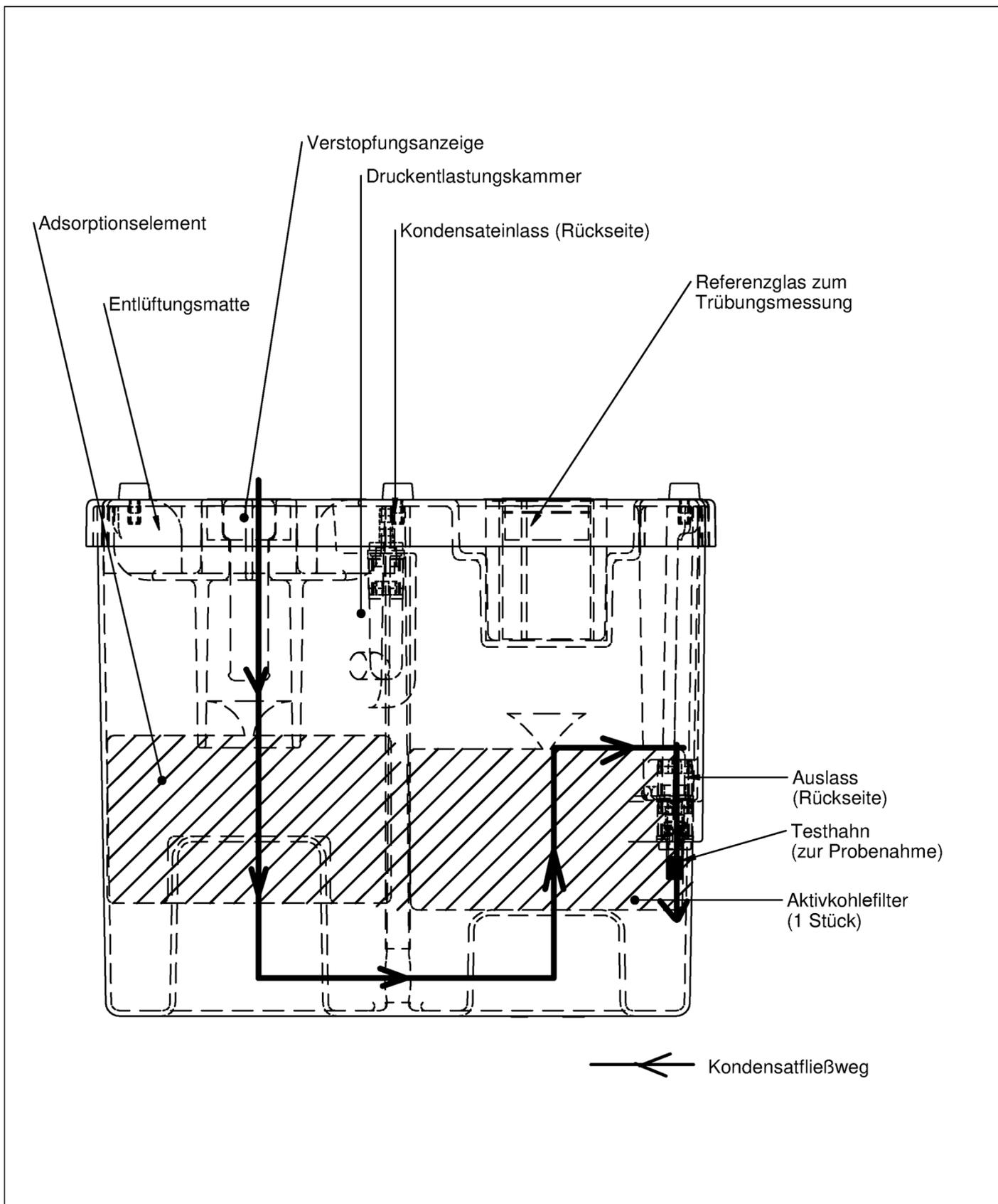
Anlage zur Behandlung von Kompressorenkondensaten
