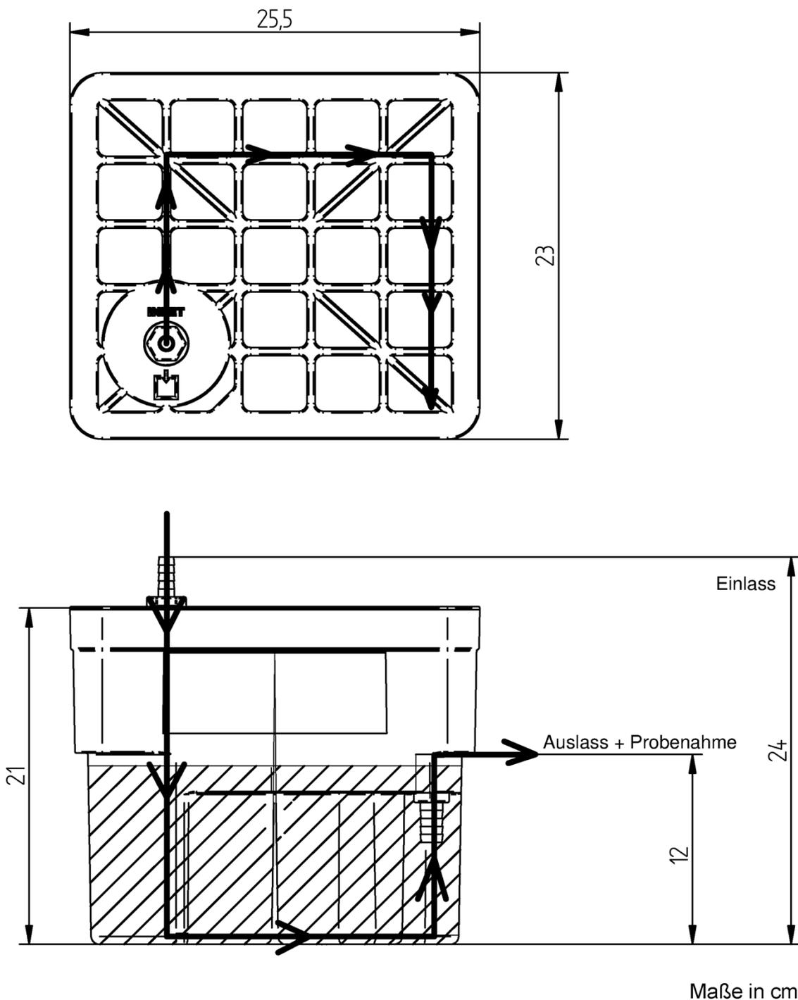
Anlage zur Behandlung von Kompressorenkondensaten
