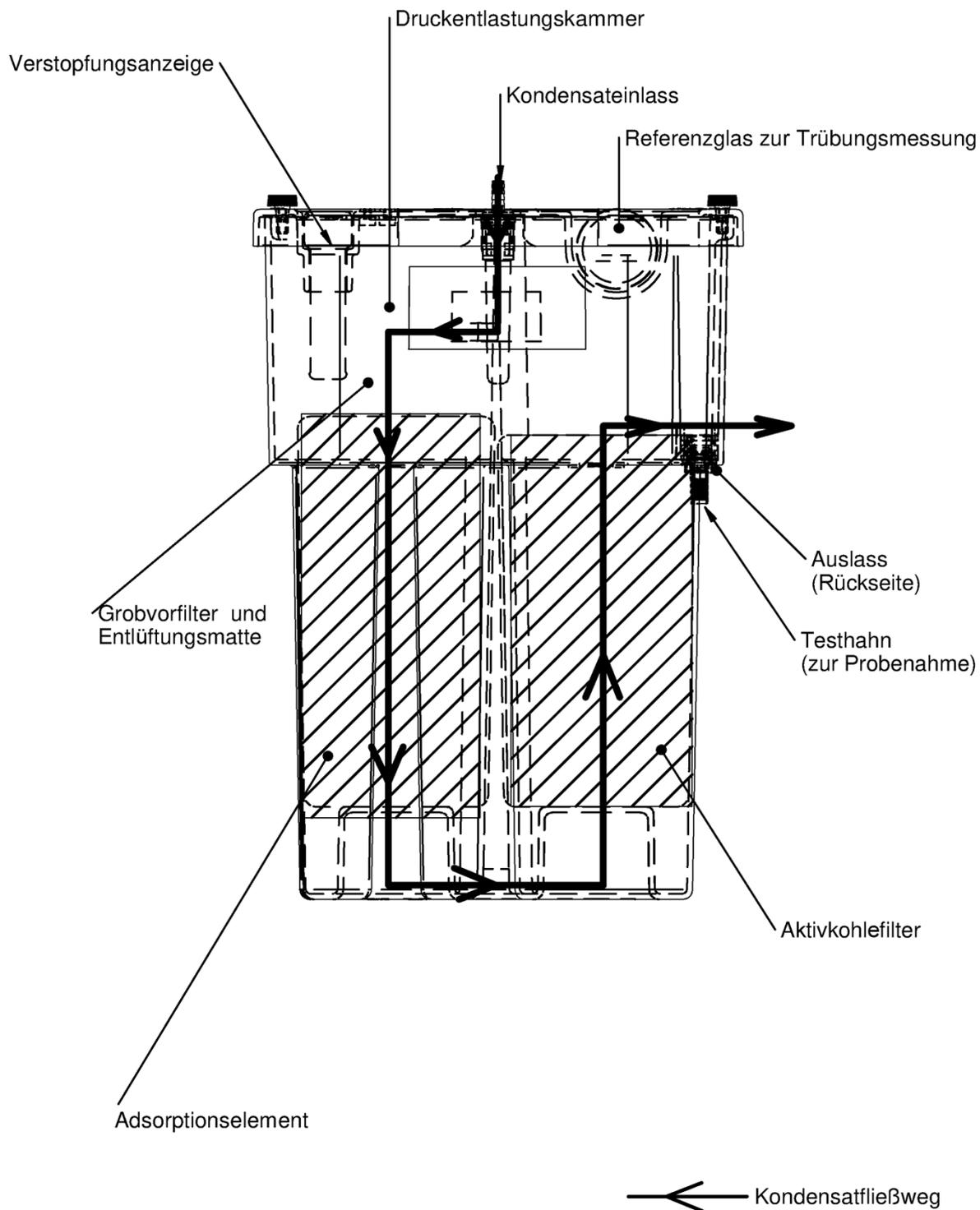
Anlage zur Behandlung von Kompressorenkondensaten
