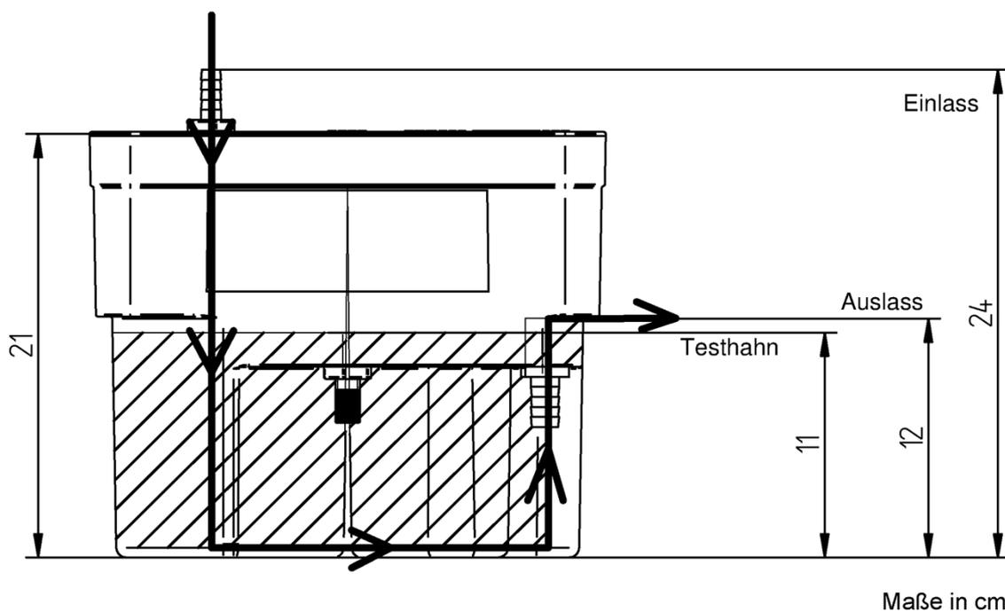
Anlage zur Behandlung von Kompressorenkondensaten
