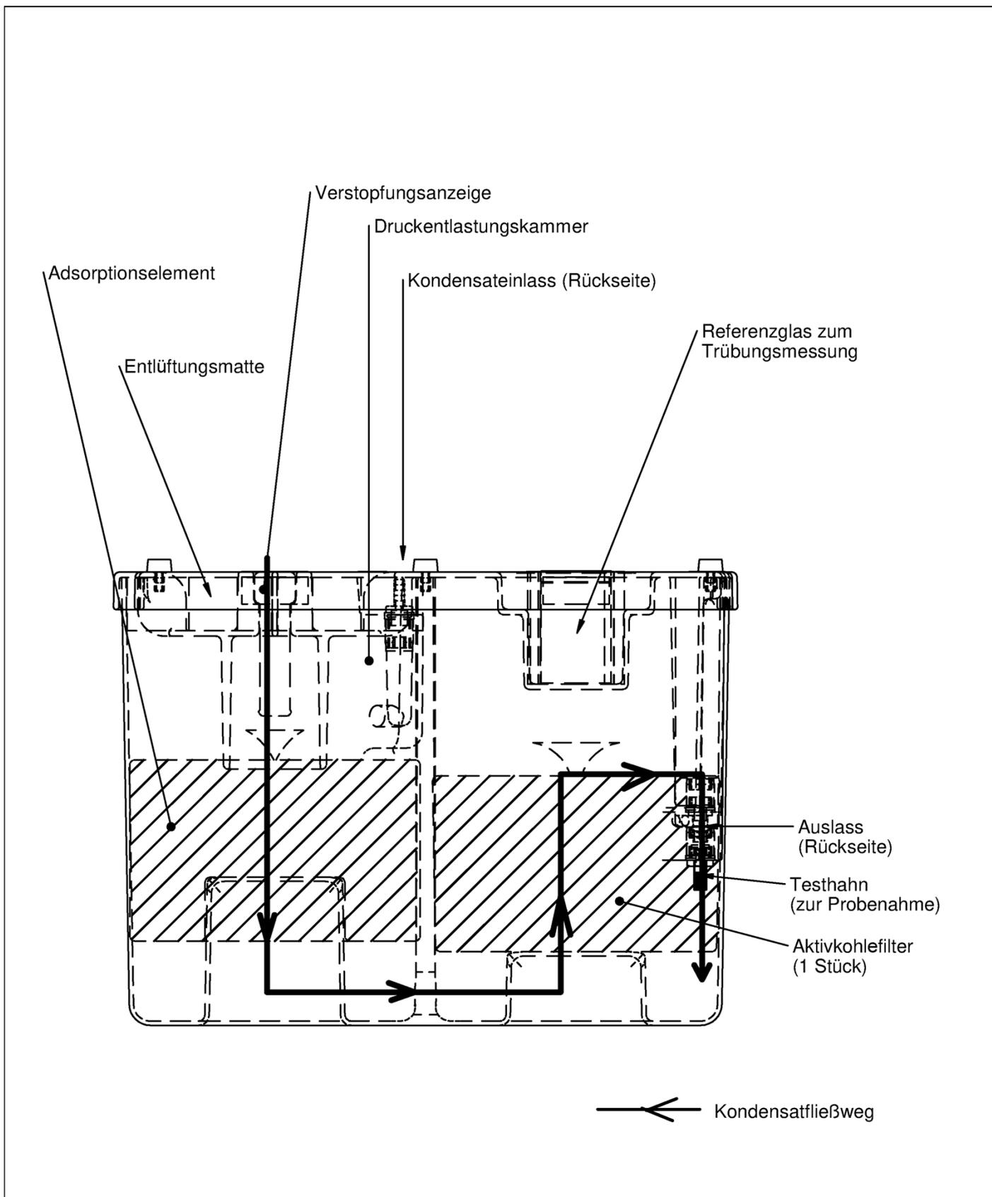
Anlage zur Behandlung von Kompressorenkondensaten
