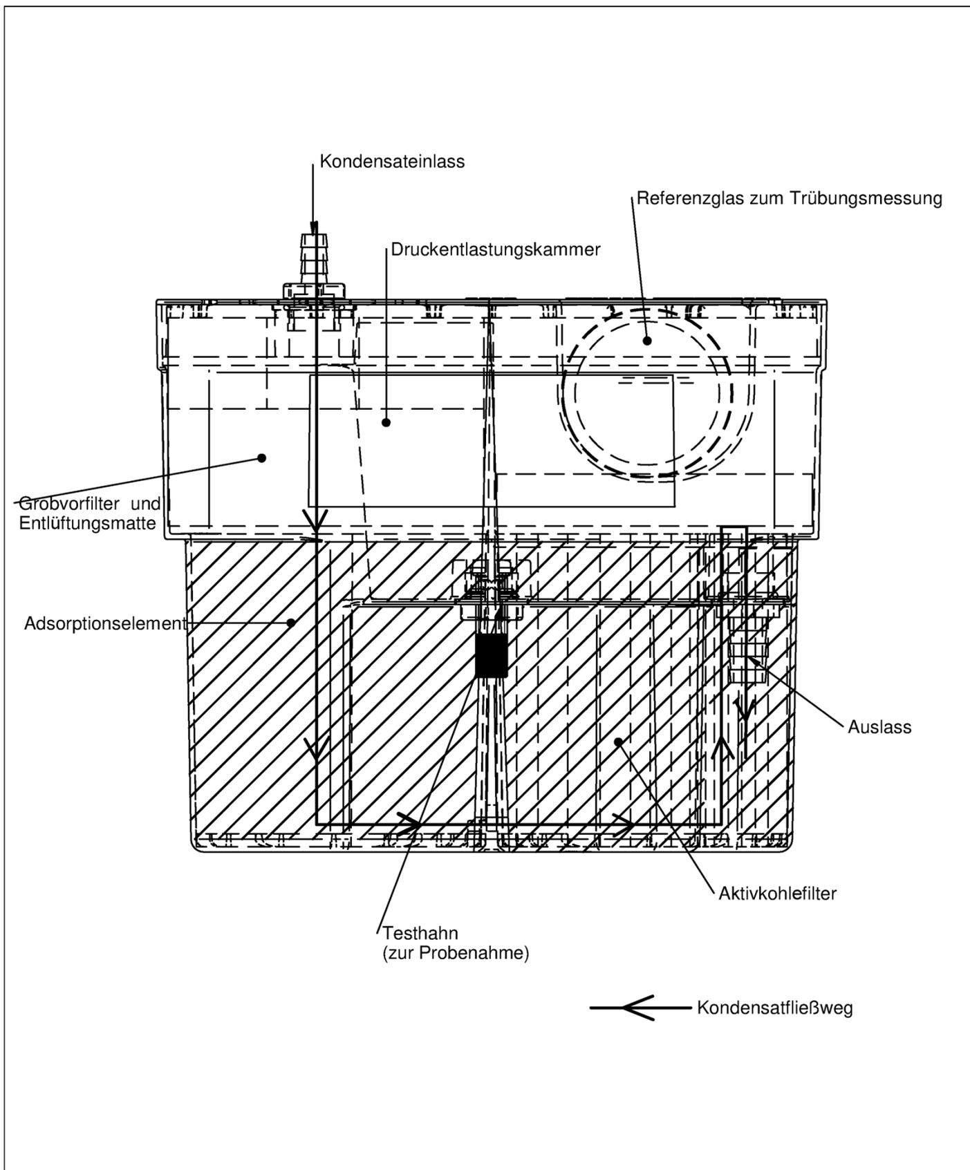
Anlage zur Behandlung von Kompressorenkondensaten
