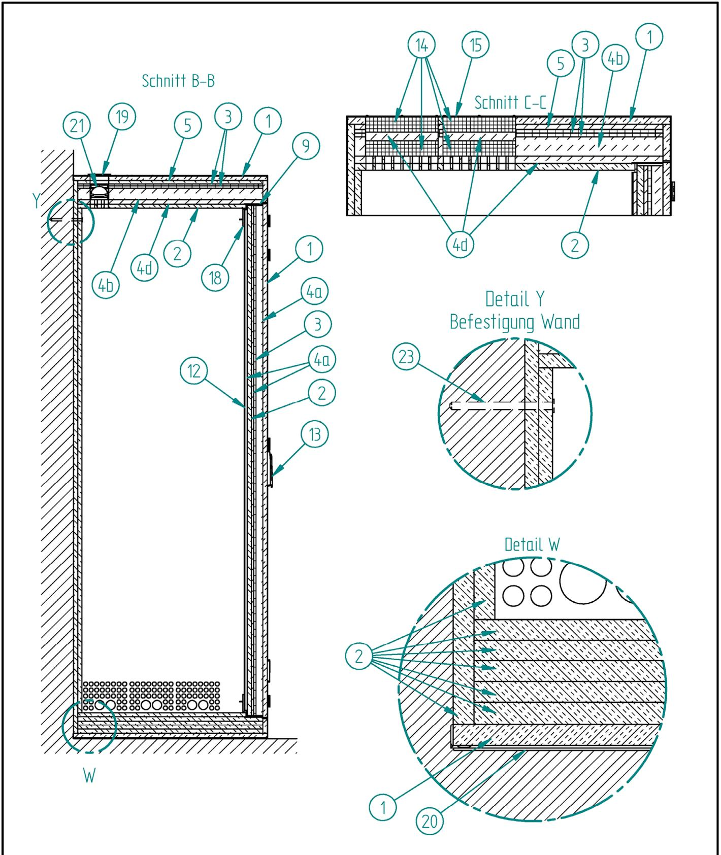
Gehäuse für Verteiler für sicherheitstechnische Anlagen mit Funktionserhalt von 30 Minuten im Brandfall
