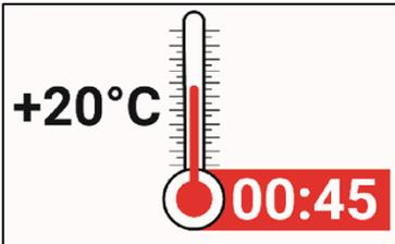
11. Temperaturabhängige Aushärtezeit  $t_{cure}$  (Anhang B 5) muss eingehalten werden. Die Installation der Anschlussbewehrung und der Schalung, darf nach Erreichen der anfänglichen Aushärtezeit  $t_{cure,ini}$  fortgesetzt werden. Die volle Belastung darf erst nach Erreichen der vollen Aushärtezeit  $t_{cure}$  erfolgen.
