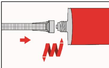
3. Statikmischer SM-14W/PM-19E aufschrauben und Kartusche in geeignetes Auspressgerät einlegen. Bei Schlauchfolienkartuschen den Schlauchfolienclip vor der Verwendung abschneiden. Bei Arbeitsunterbrechungen, länger als die maximale Verarbeitungszeit  $t_{work}$  (Anhang B 5) und bei neuen Kartuschen, neuen Statikmischer verwenden.
