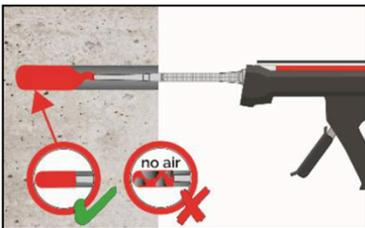
7a. **Injizieren ohne Verfüllstutzen VS:**
