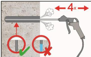
2c. Abschließend Bohrloch mindestens 4x mit Druckluft (min. 6 bar) (Anhang B 4) über die gesamte Verankerungstiefe (ggf. Verlängerung verwenden) ausblasen, bis die ausströmende Luft staubfrei ist.
