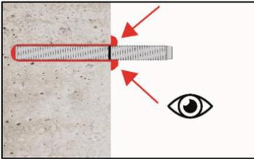
9. Ringspalt zwischen Ankerstange und Verankerungsgrund muss vollständig mit Mörtel gefüllt sein. Bei Durchsteckmontage muss auch der Ringspalt im Anbauteil mit Mörtel verfüllt sein. Andernfalls Anwendung vor Erreichen der maximalen Verarbeitungszeit  $t_{work}$  ab Schritt 8 wiederholen.
