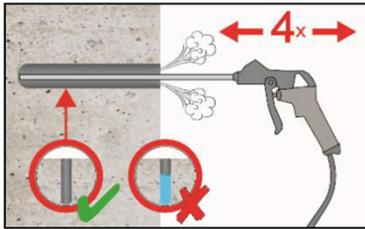
2a. Bohrloch mindestens 4x mit Druckluft (min. 6 bar) (Anhang B 4) über die gesamte Verankerungstiefe (ggf. Verlängerung verwenden) ausblasen, bis die ausströmende Luft staubfrei ist.
