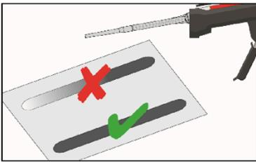
5. Nicht vollständig gemischter Mörtel ist nicht zur Befestigung geeignet. Mörtel verwerfen, bis sich gleichmäßig graue Mischfarbe eingestellt hat (mindestens 3 volle Hübe, bei Schlauchfolienkartuschen min. 6 Hübe)
