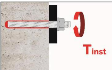
12. Anbauteil mit kalibriertem Drehmomentschlüssel montieren. Maximales Montagedrehmoment (Tabelle B1, B2 oder B3) beachten. Bei statischer Vorgabe (z.B. Erdbeben), Ringspalt im Anbauteil mit Mörtel (Anhang A 3) verfüllen. Dazu Unterlegscheibe durch Verfüllscheibe VFS ersetzen und Mischerreduzierung MR verwenden.
