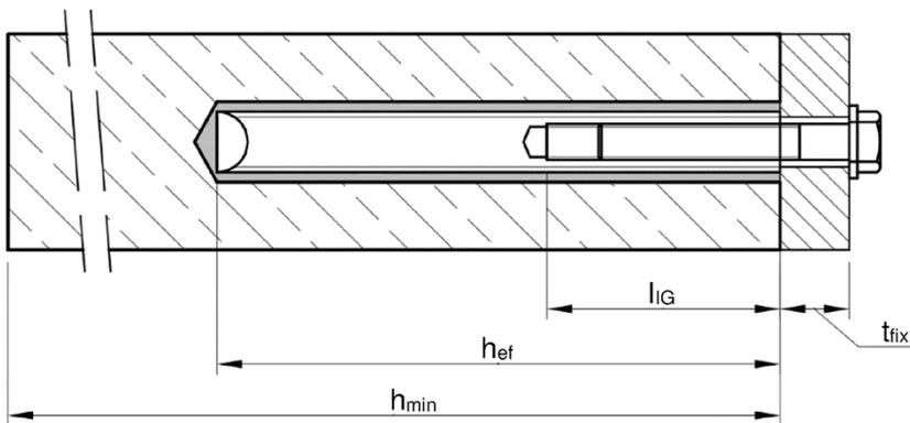
$t_{fix}$  = Dicke des Anbauteils
