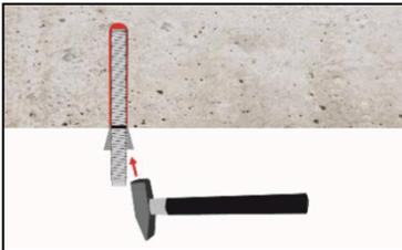
10. Bei Anwendungen in vertikaler Richtung nach oben ist der Ankerstange zu fixieren (z.B. mit Holzkeilen).
