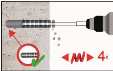
2b. Bohrloch mindestens 4x mit Bürste RBT gemäß Tabelle B4 drehend über die gesamte Verankerungstiefe (ggf. Bürstenverlängerung RBL verwenden) ausbürsten.
