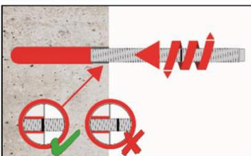
8. Ankerstange mit leichter Drehbewegung bis zur Markierung einführen.
