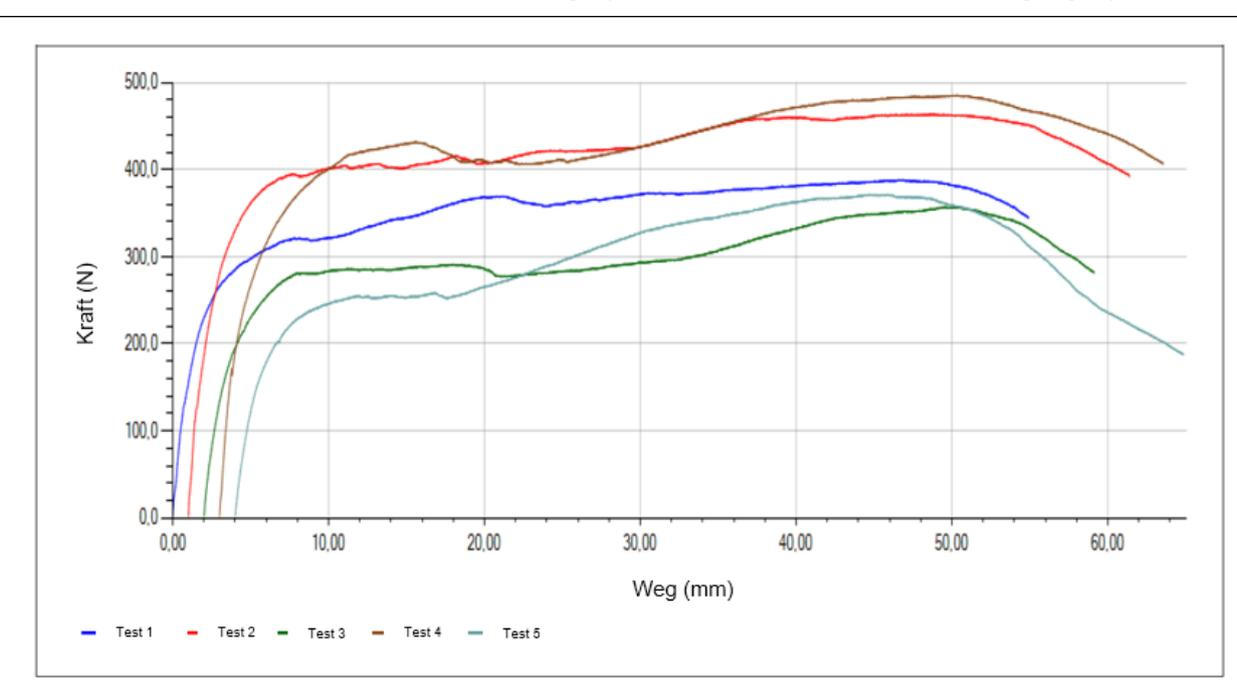
Abb.: 7.3: Dübel, nicht im Bereich der Plattenfuge (Durchziehversuch, trockene Bedingungen)
