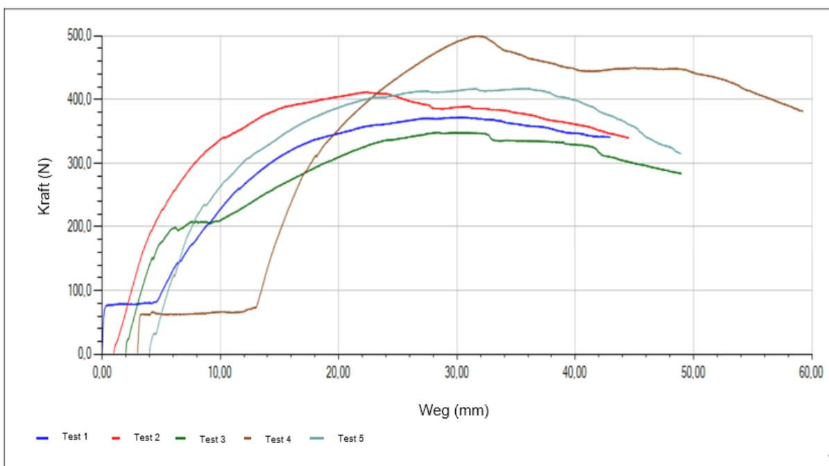
Abb.: 5.3: Dübel, nicht im Bereich der Plattenfuge (Durchziehversuch, trockene Bedingungen)
