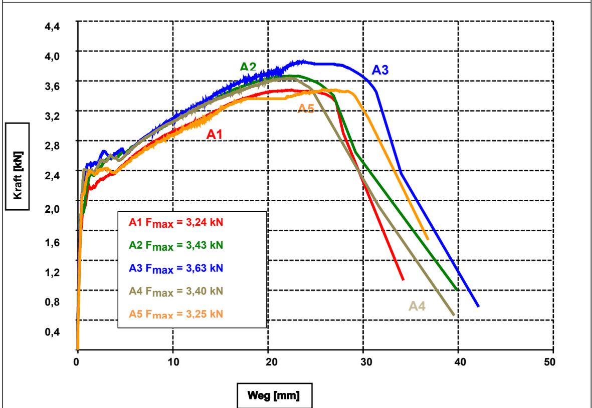
Abb.: 4.2: Dübel, nicht im Bereich der Plattenfuge (Durchziehversuch, trockene Bedingungen)
