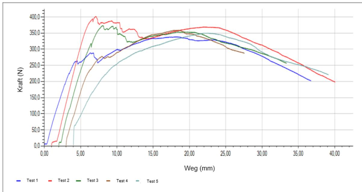
Abb.: 5.2: Dübel, nicht im Bereich der Plattenfuge (Durchziehversuch, trockene Bedingungen)
