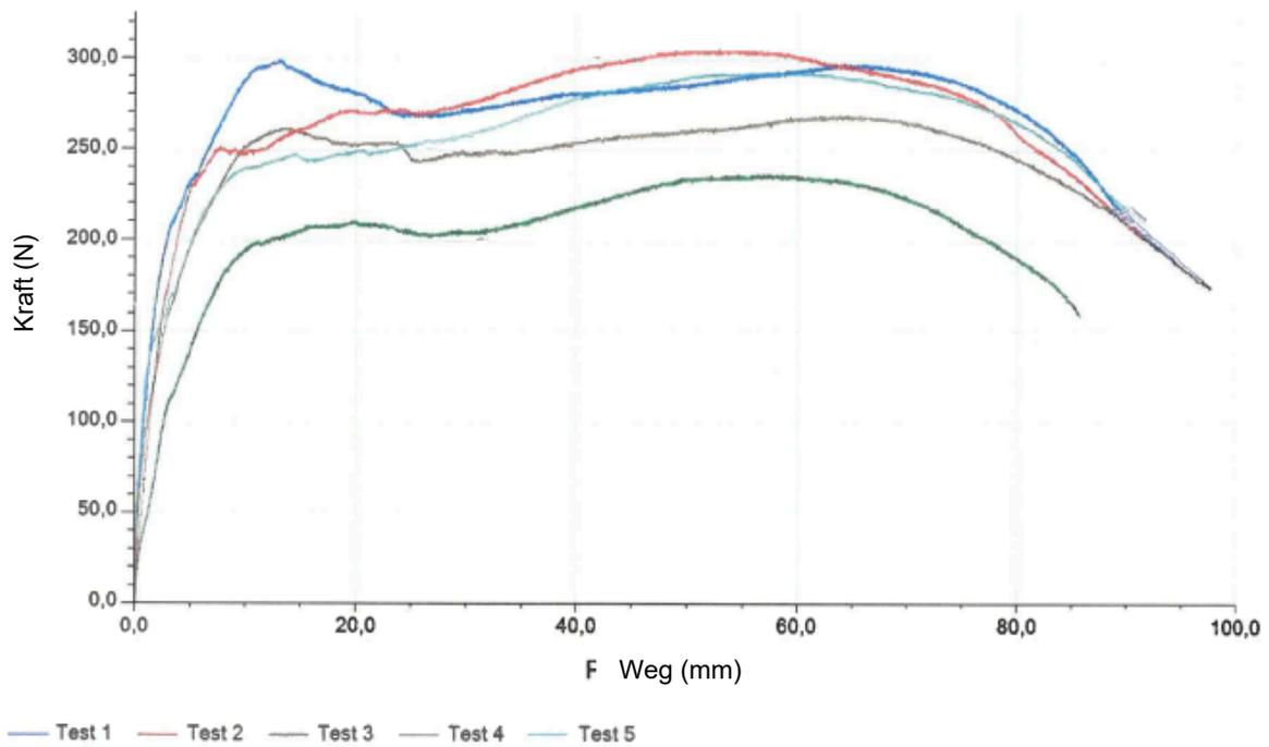
Abb.: 5.7: Dübel, nicht im Bereich der Plattenfuge (Durchziehversuch, trockene Bedingungen)
