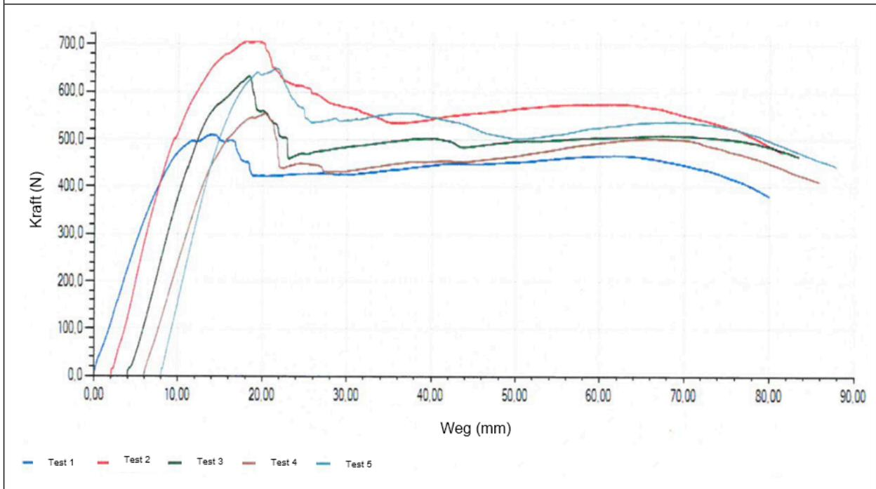
Abb.: 6.2: Dübel, nicht im Bereich der Plattenfuge (Durchziehversuch, trockene Bedingungen)
