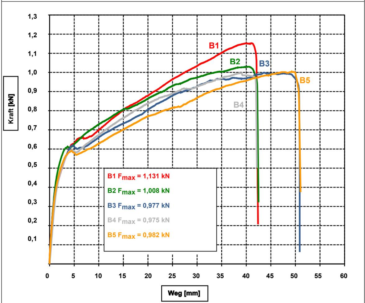
Abb.: 4.6: Dübel, nicht im Bereich der Plattenfuge (Durchziehversuch, feuchte Bedingungen)
