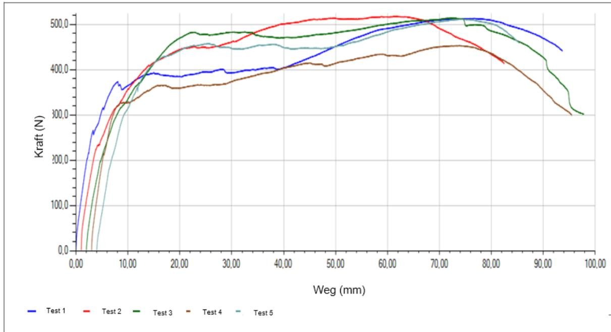
Abb.: 5.4: Dübel, nicht im Bereich der Plattenfuge (Durchziehversuch, feuchte Bedingungen)
