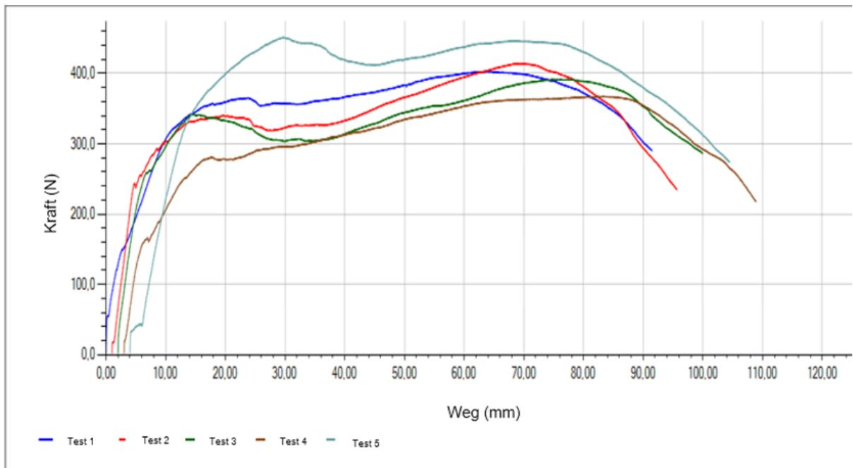
Abb.: 5.6: Dübel, nicht im Bereich der Plattenfuge (Durchziehversuch, feuchte Bedingungen)
