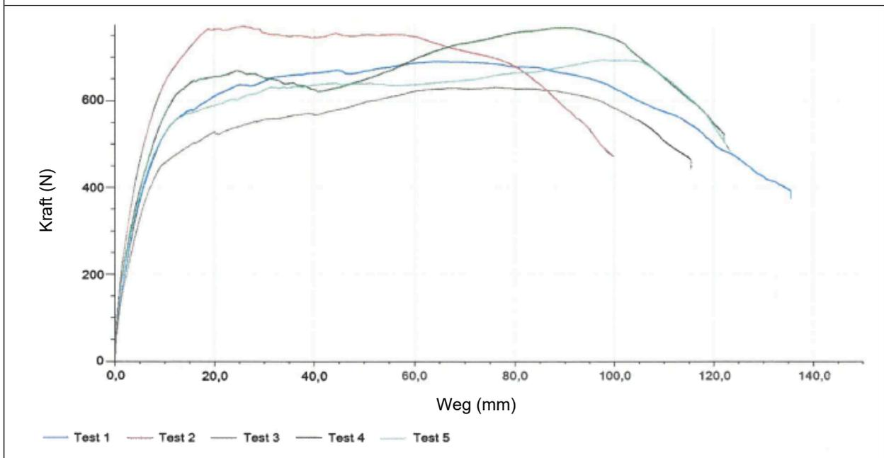
Abb.: 6.3: Dübel, nicht im Bereich der Plattenfuge (Durchziehversuch, trockene Bedingungen)
