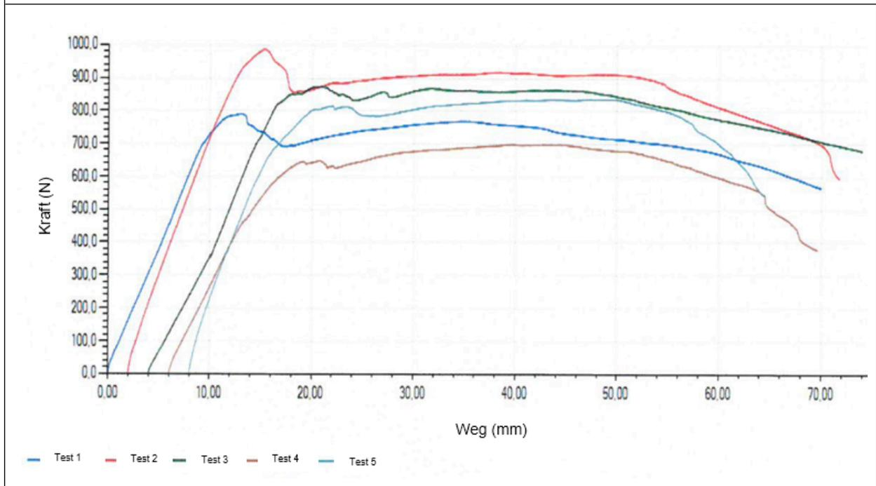
Die Versagenslasten der Tabelle 2 des Abschnitts 4.4.1 und der Tabelle 1 des Abschnitts 4.4.2 gelten für einen Dübeltellerdurchmesser von 60 mm für folgende Dübel auch mit versenkter Montage nur unter den genannten Einbaubedingungen:
