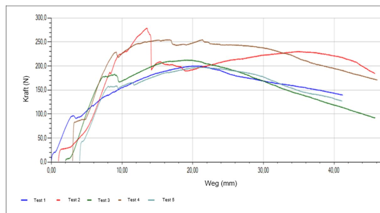
Abb.: 5.5: Dübel, nicht im Bereich der Plattenfuge (Durchziehversuch, feuchte Bedingungen)
