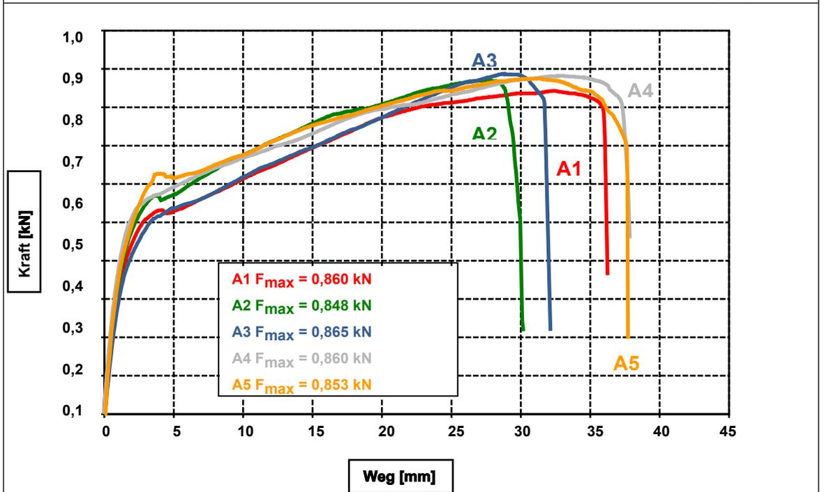
Abb.: 4.3: Dübel, nicht im Bereich der Plattenfuge (Durchziehversuch, feuchte Bedingungen)
