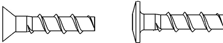
z.B. WÜRTH Betonschraube W-BS COMPACT, Ausführung mit Linsenkopf
