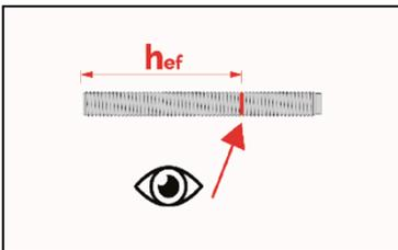
4. Verankerungstiefe auf der Ankerstange markieren. Bei Durchsteckmontage  $t_{fix}$  berücksichtigen. Die Ankerstange muss frei von Schmutz-, Fett, Öl und anderen Fremdmaterialien sein.
