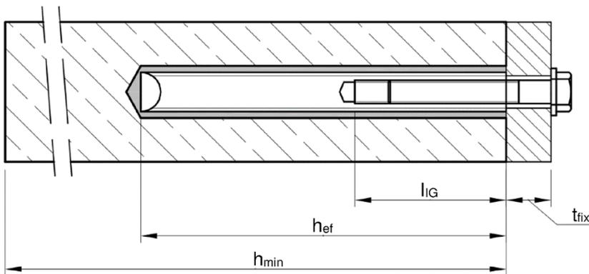
$t_{fix}$  = Dicke des Anbauteils
