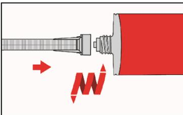
3. Statkmischer PM-19E aufschrauben und Kartusche in geeignetes Auspressgerät einlegen. Bei Arbeitsunterbrechungen, länger als die maximale Verarbeitungszeit  $t_{work}$  (Anhang B 5) und bei neuen Kartuschen, neuen Statkmischer verwenden.
