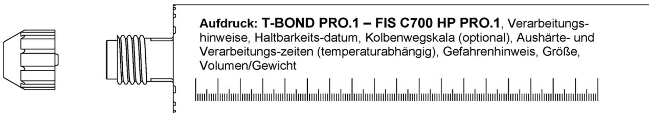
**Statikmischer FIS MR Plus für Injektionskartuschen bis 410 ml**
