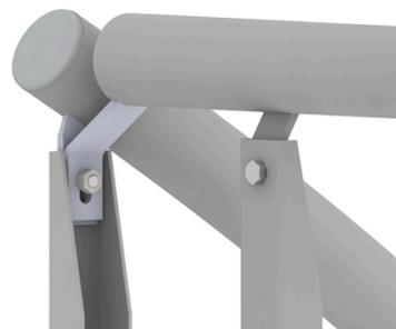
Bild 8) Handlaufverbindung
